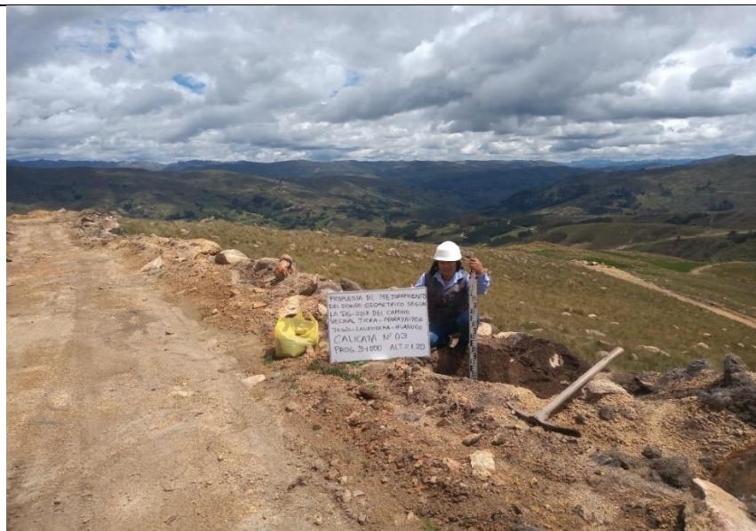
Foto 19. Extracción de las muestras de la calicata
