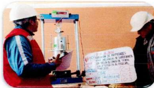
PANEL 18: EJECUCION DE CBR
