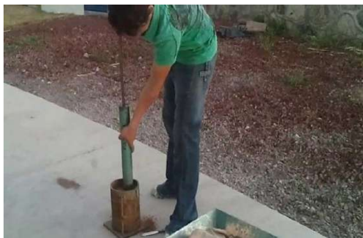
Figura 6. Ensayo Proctor Modificado
