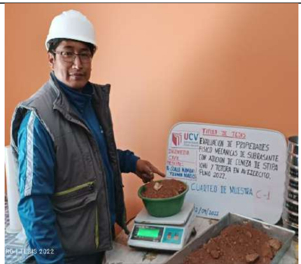
Imagen 49: Pesado de muestra para ensayo (análisis granulométrico) C-1.
