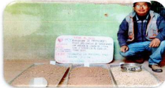
PANEL 10: PREPARADO DE MUESTRAS PARA PROCTOR Y CBR.
