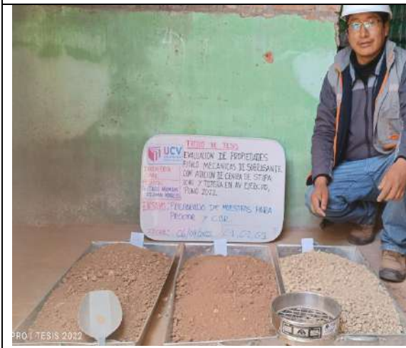
Imagen 64: Preparado de material para Proctor modificado y CBR.
