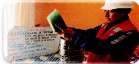
PANEL 12: ANALISIS GRANULOMETRICO
