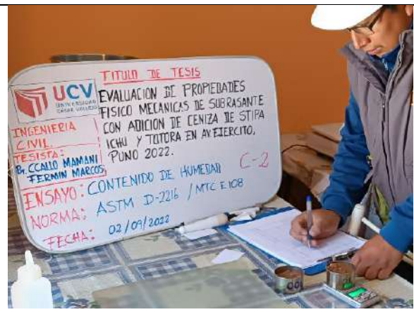
Imagen 43: Se anota el peso húmedo de la C-2 para contenido de humedad.
