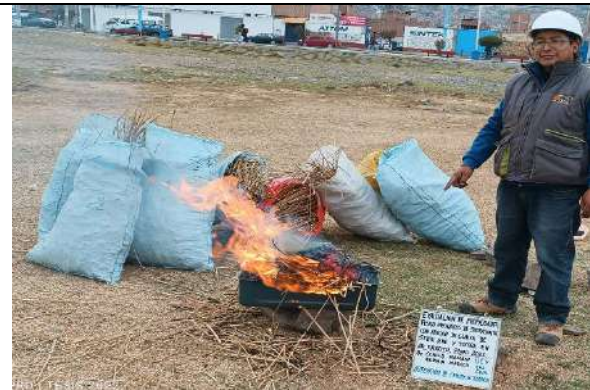
Imagen 13: Obtención de ceniza de totora
