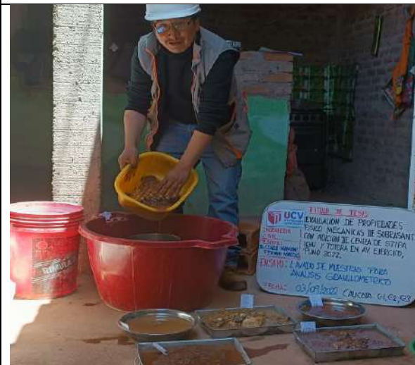
Imagen 53: Lavado de muestras para el ensayo de análisis granulométrico (C-1, C-2, C-3).
