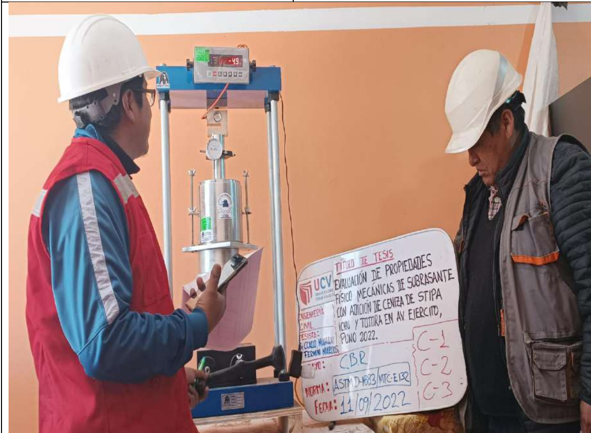
Imagen 70: Ensayo de CBR de nuestras muestras C-1, C-2, C-3.
