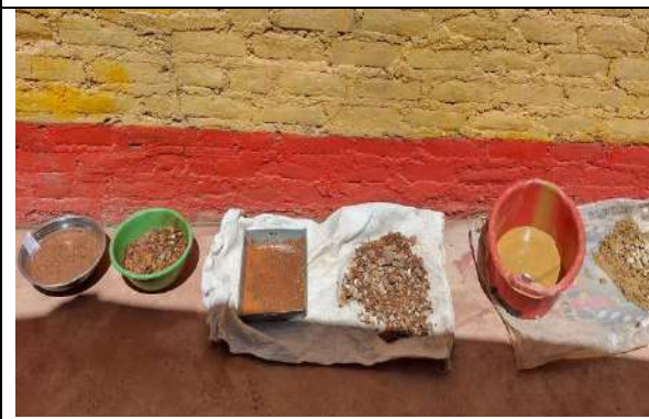
Imagen 55: Secado de muestras para el ensayo de análisis granulométrico (C-1, C-2, C-3).
