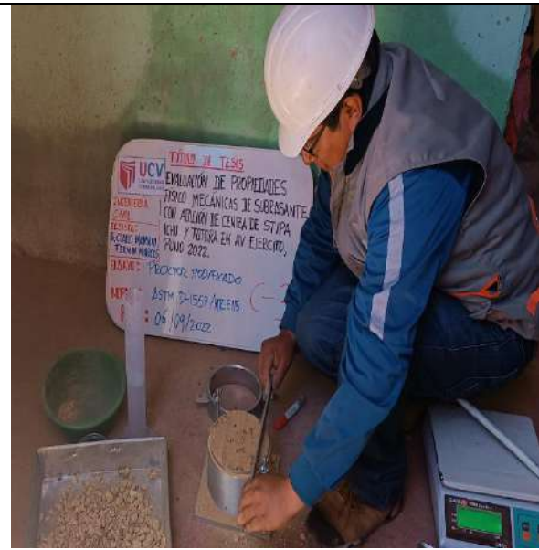
Imagen 69: Proctor modificado C-3
