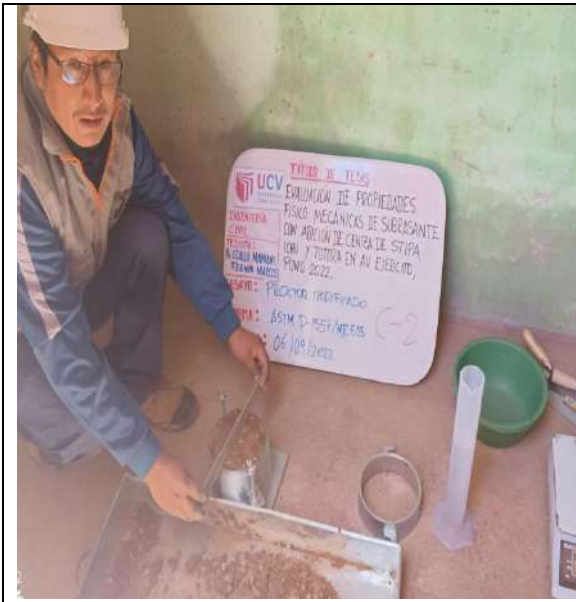
Imagen 68: Proctor modificado C-2
