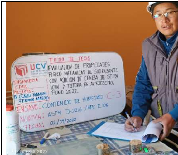
Imagen 44: Se anota el peso húmedo de la C-3 para contenido de humedad.
