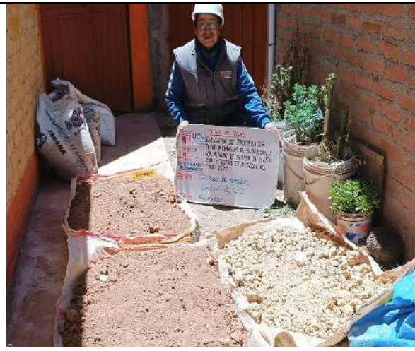
Imagen 45: Se deja secando a la intemperie las muestras.
