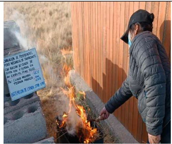
Imagen 23: Obtención de ceniza de stipa ichu
