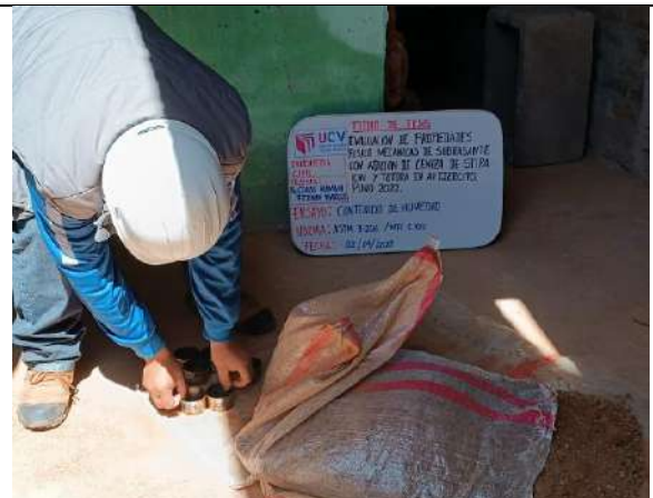
Imagen 41: Se toma porciones para el contenido de humedad de cada calicata tanto C-1,C-2,C-3.
