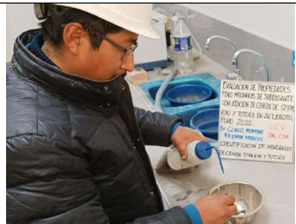
Imagen 33: Se satura la ceniza activada
