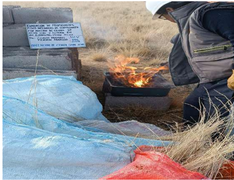
Figura 20. Obtención de ceniza de stipa ichu.
