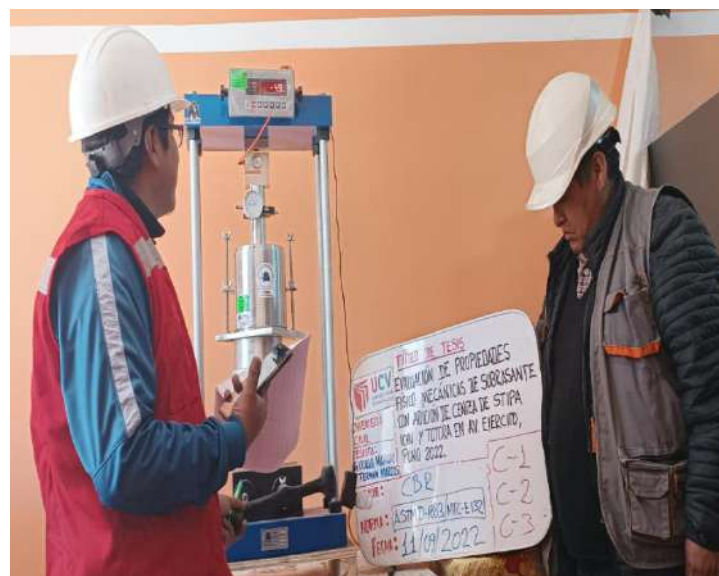
Figura 50. Ensayo de valor de soporte California (CBR)
