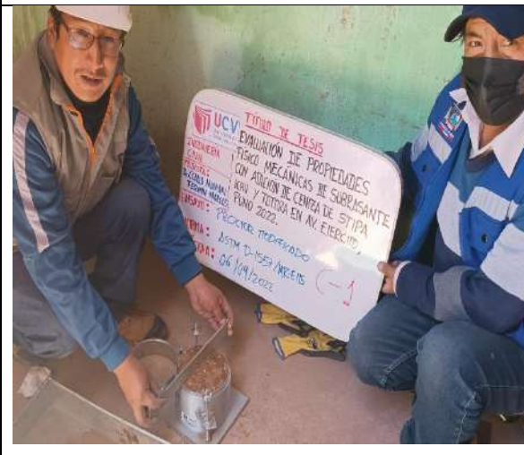
Imagen 67: Proctor modificado C-1
