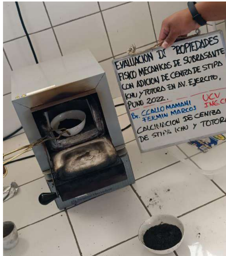
Figura 26. Activación de la ceniza totora.
