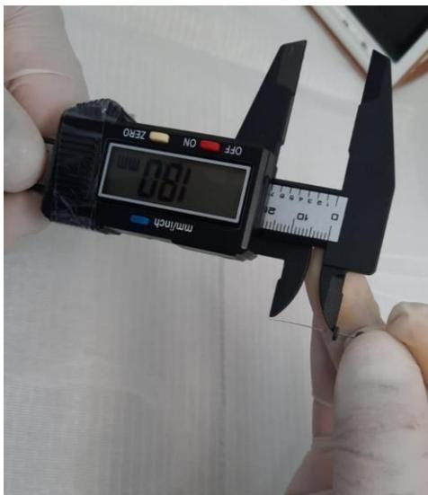
$18 \text{ mm} - 1 \text{ mm} = 17 \text{ mm}$  (LT para el método por inspección visual directa)
