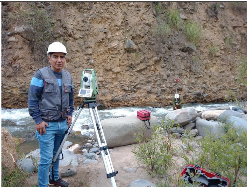
Foto 2. Levantamiento de puntos de la ribera del río
