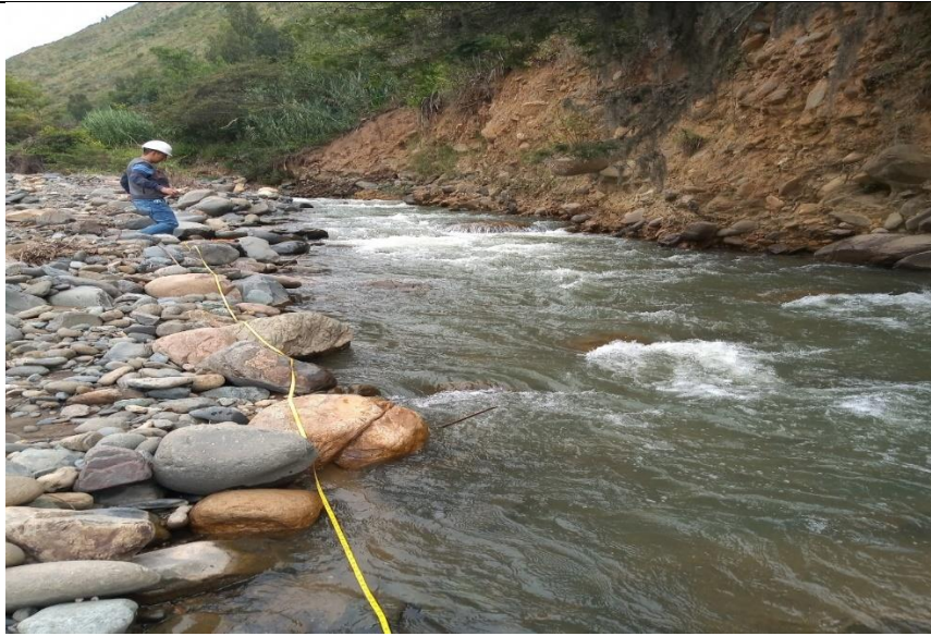
Foto 11. Medición empírica de la velocidad del caudal
