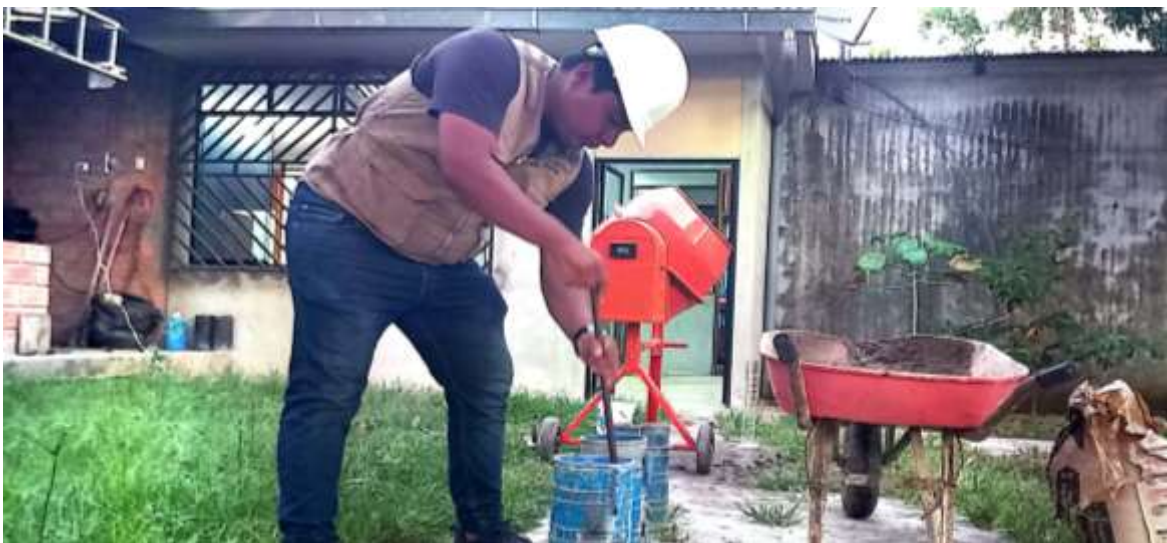
Foto N° 06: Proceso de moldeado de los testigos de concreto
