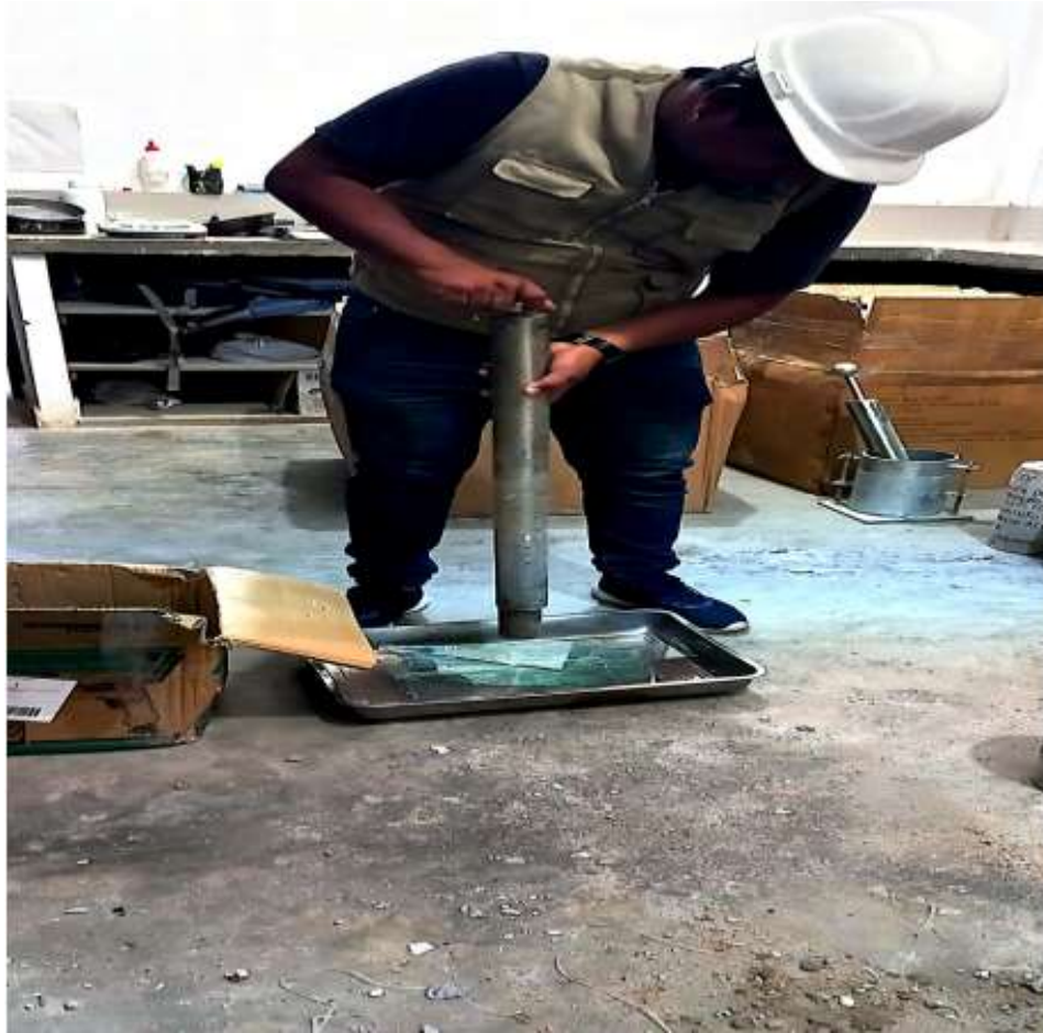
Foto N° 01: Ensayo de fibra de vidrio peso unitario y compactado.
