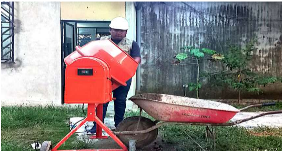
Foto N° 04: Proceso de realizar la mezcla para las probetas.
