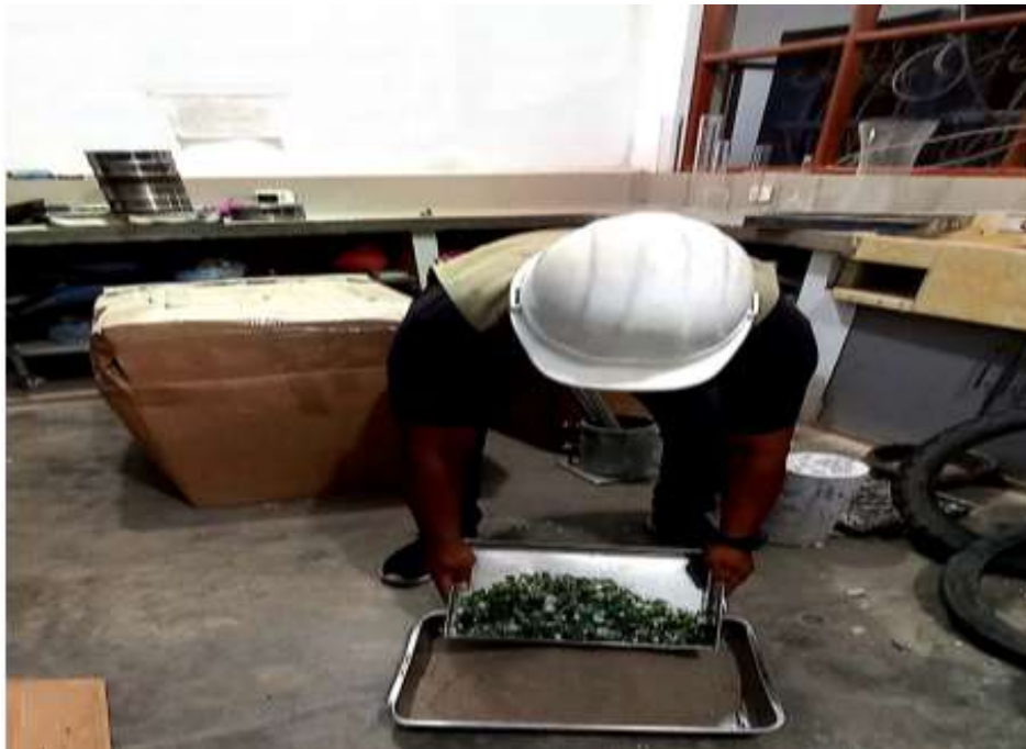
Foto N° 02: Ensayo de fibra de vidrio peso unitario-compactado.
