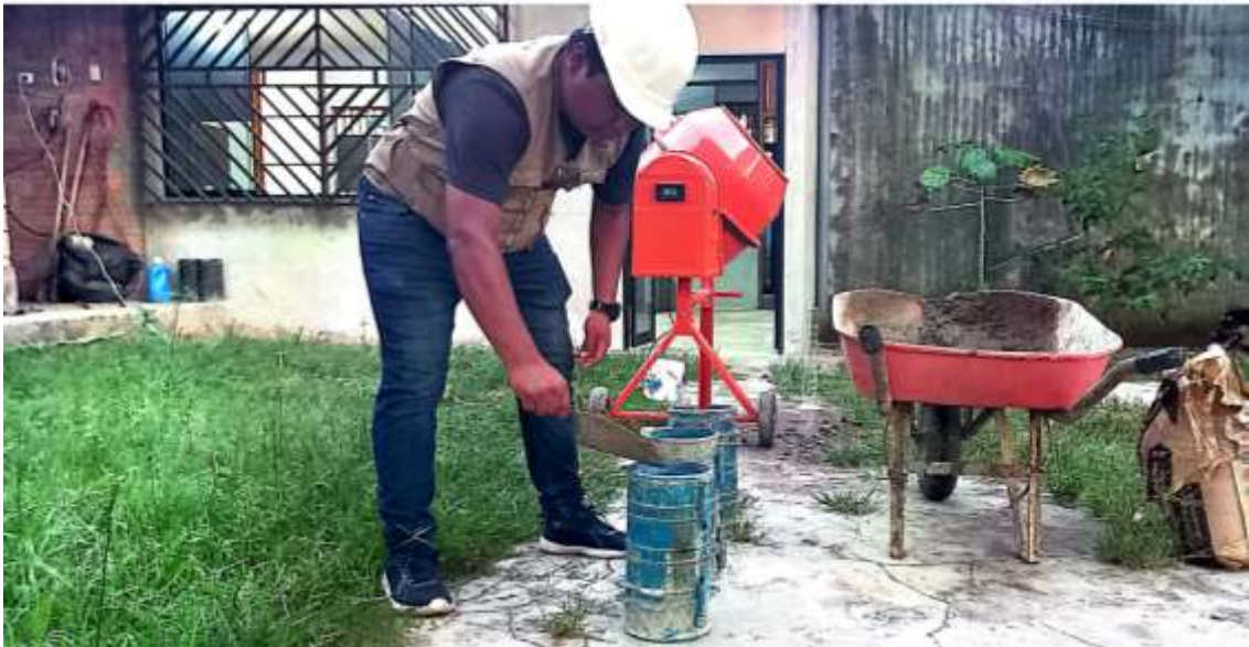
Foto N° 05: Proceso de llenado al molde de testigos de concreto.
