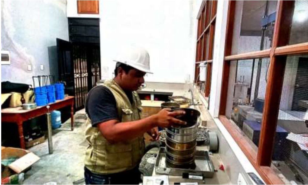
Foto N° 03: Ensayo de los agregados – Granulometría.
