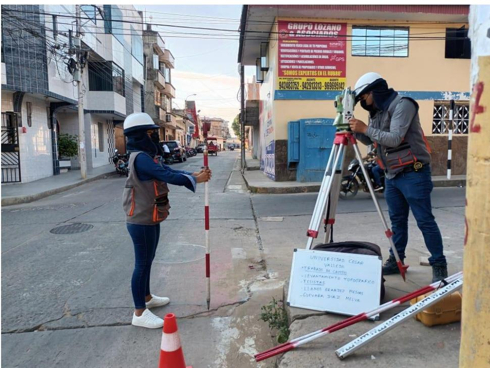
*FOTOGRAFÍA 6: Levantamiento topográfico BM-01 Jr. Lamas – Tarapoto, con equipo topográfico estación total marca Leica modelo NA730*
