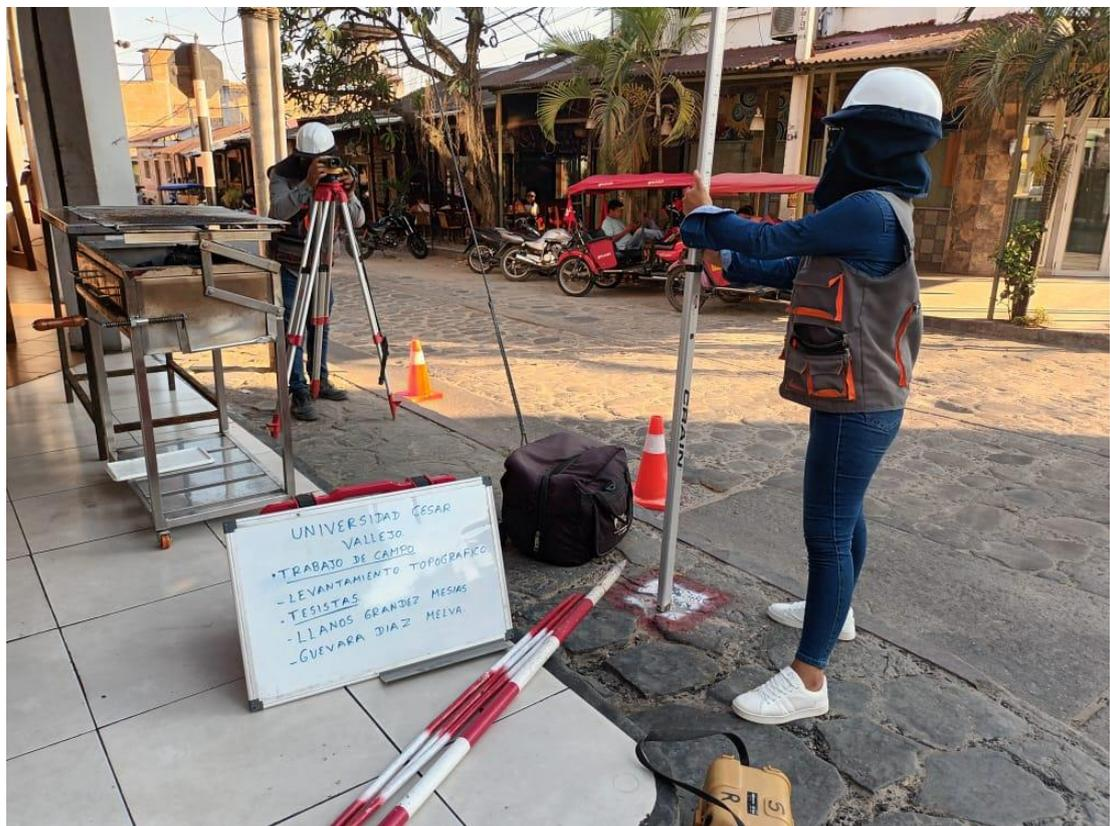
FOTOGRAFÍA 10: Levantamiento topográfico BM-0 Jr. Lamas – Tarapoto, con equipo topográfico nivel topográfico
