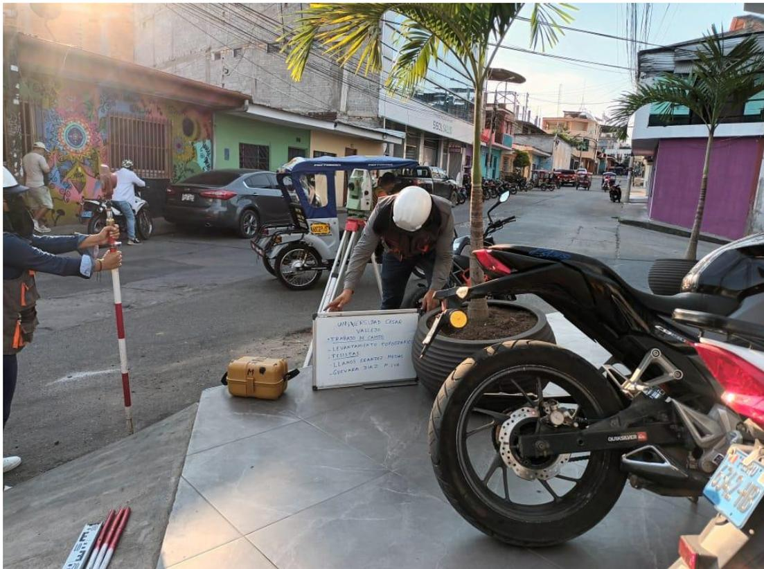
**FOTOGRAFÍA 14: Levantamiento topográfico BM-04 Jr. Lamas – Tarapoto, con equipo topográfico estación total marca Leica modelo NA730**
