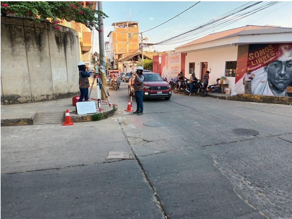
*FOTOGRAFÍA 5: Levantamiento topográfico BM-01 Jr. Lamas – Tarapoto, con equipo topográfico estación total marca Leica modelo NA730*
