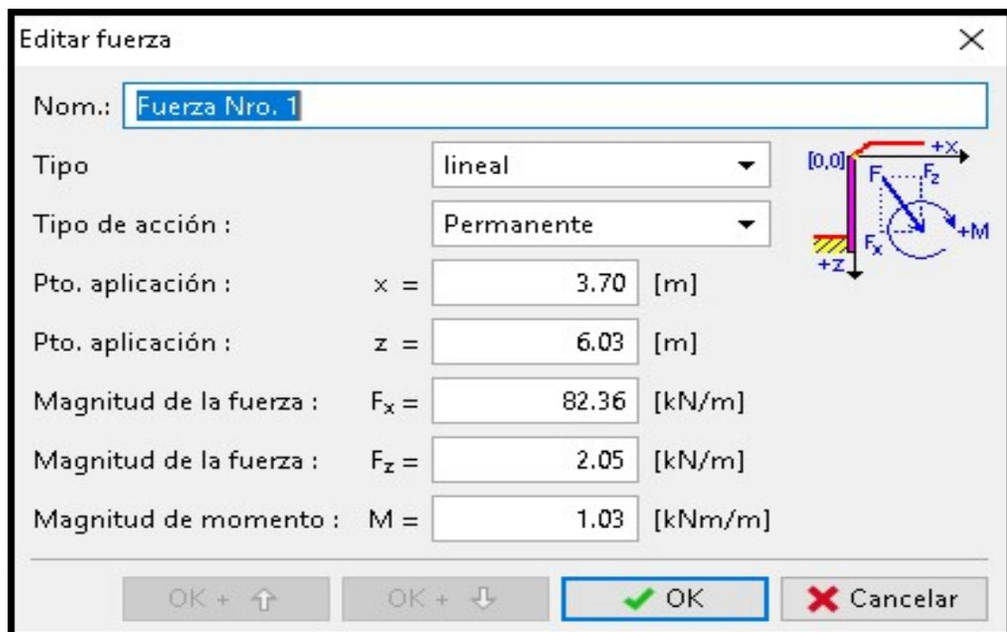
Figura 44. Datos del método Spencer introducidos al geo 05.
