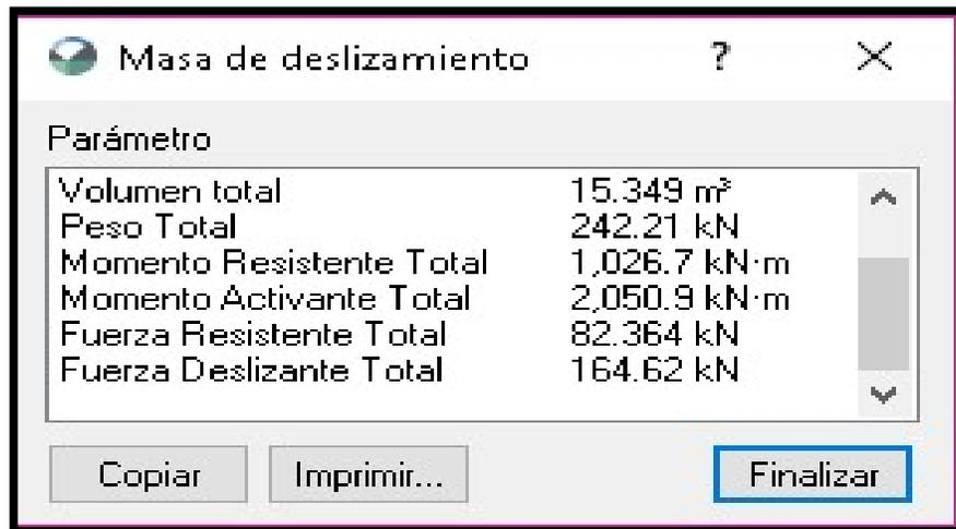
Figura 43. Fuerzas aplicadas con el método Spencer, siendo este el único método que cumple con los parámetros del software Geo5.
