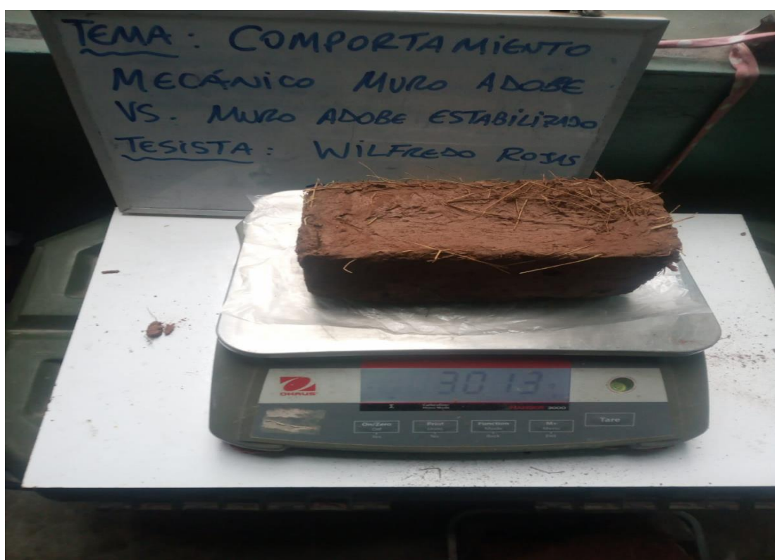
Fotografía : de ensayo de succión , peso muestra saturada de adobe convencional
