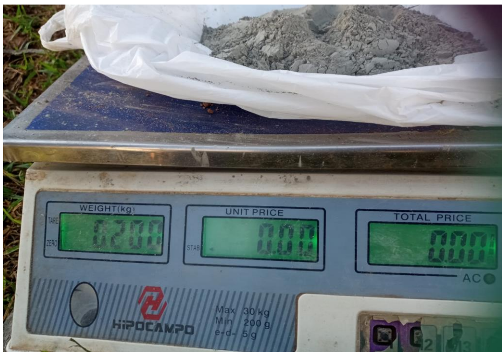
Fotografía: Toma de peso del cemento portland tipo I para adición 4%
