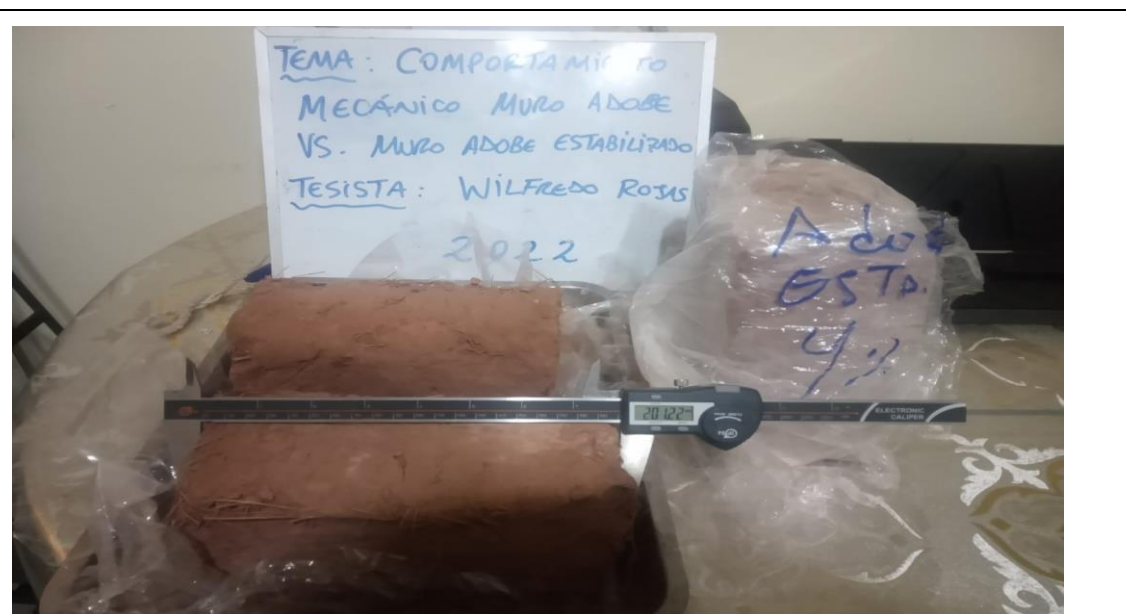
Fotografía: toma de muestra de variación dimensional de adobe estabilizado 4%
