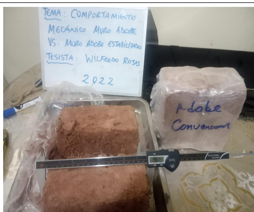
Fotografía : toma de muestra de variación dimensional adobe convencional
