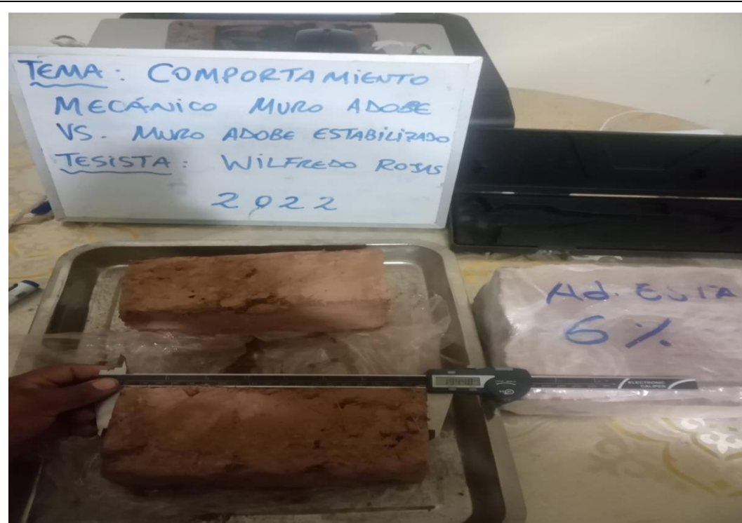
Fotografía :toma de muestra de variación dimensional de adobe estabilizado 6%
