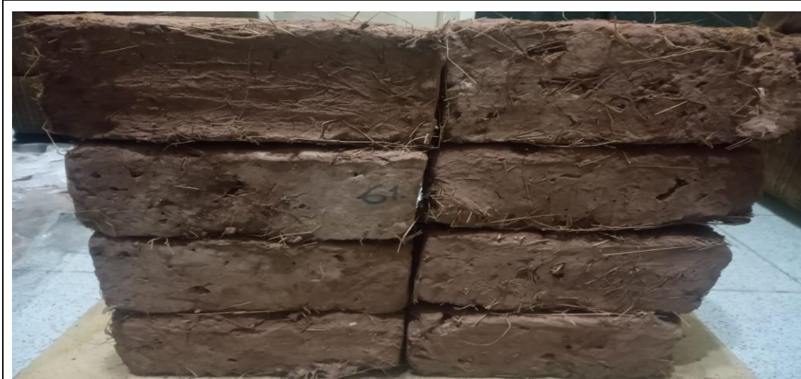
Fotografía: ensayo a compresión por murete de adobe estabilizado 6%
