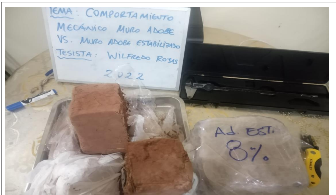
Fotografía : toma de muestra de variación dimensional adobe estabilizado 8%
