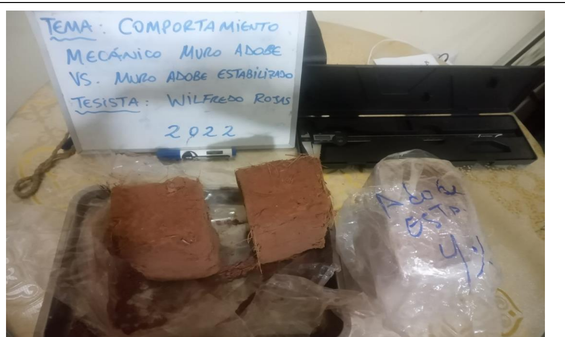
Fotografía :Toma de muestra en el laboratorio de adobe estabilizado
