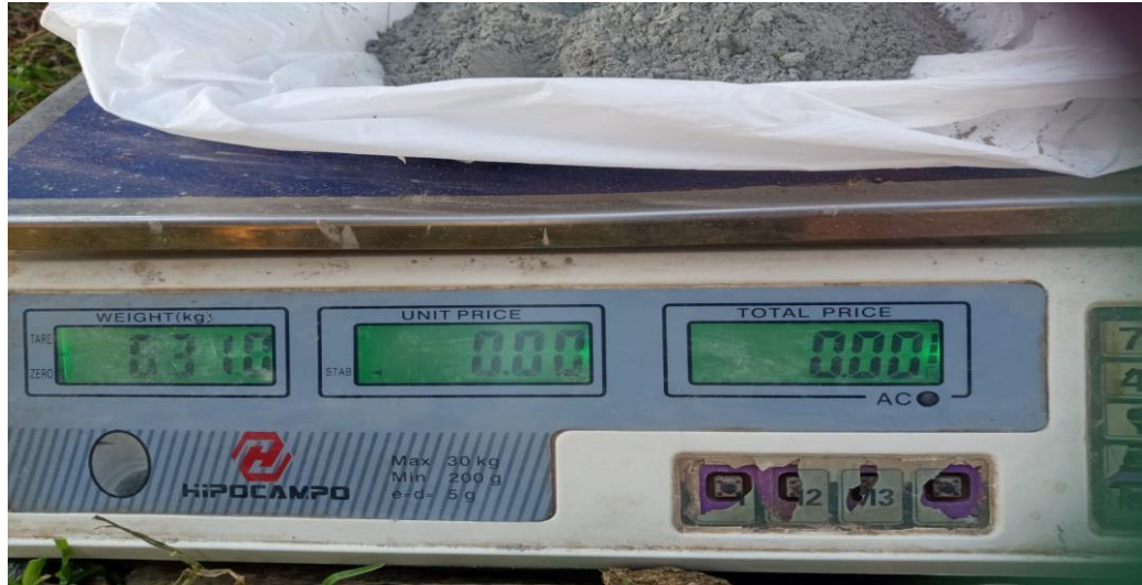
Fotografía : Toma de peso del cemento portland tipo I para adición 6%
