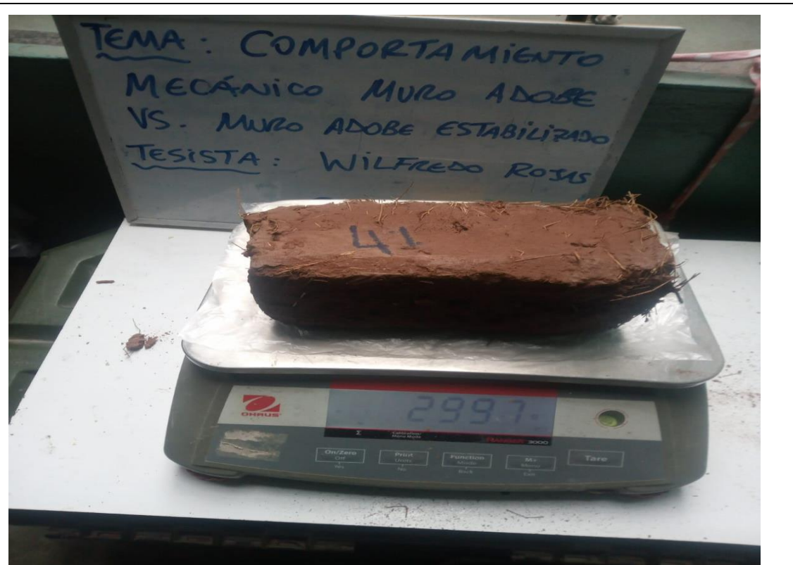
Fotografía : de ensayo de succión , peso muestra saturada adobe estabilizado 4%
