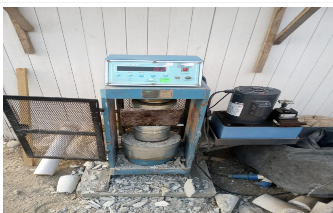
Fotografía : ensayo a compresión por unidad en laboratorio adobe estabilizado 8%
