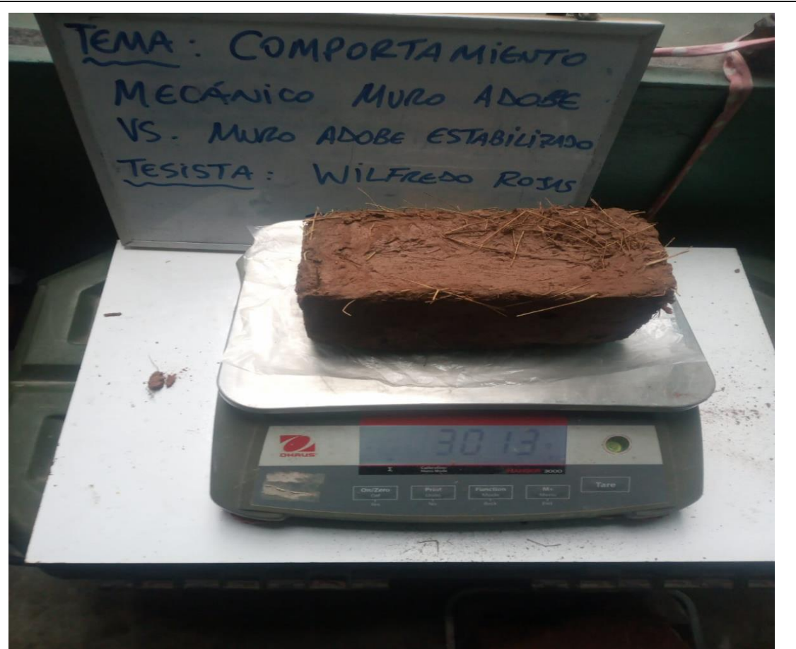
Fotografía : de ensayo de succión , peso muestra saturada adobe estabilizado 8%
