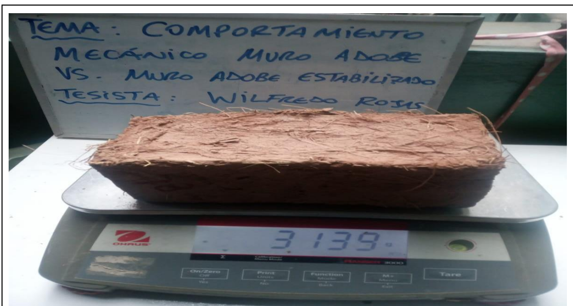
Fotografía : de ensayo de absorción, peso muestra saturada
