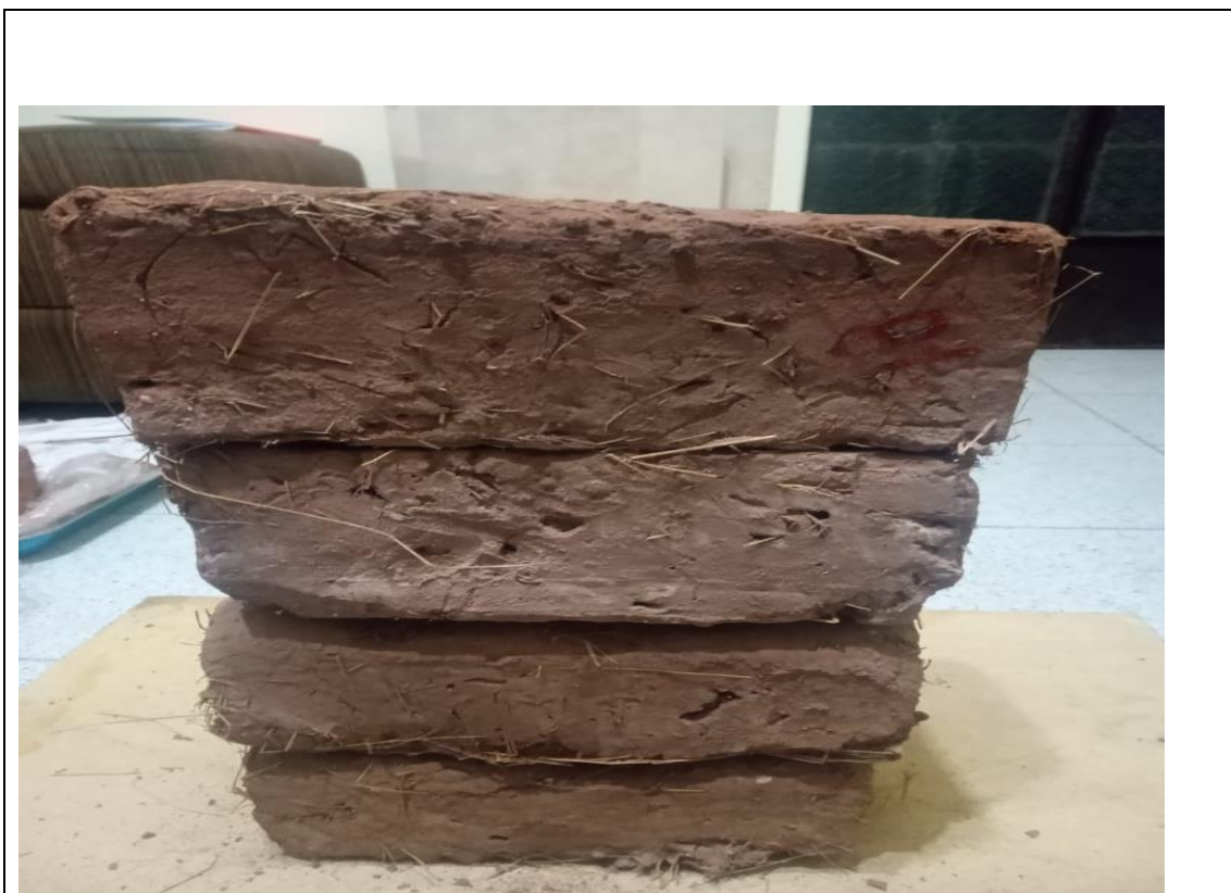
Fotografía: ensayo a compresión por murete de adobe estabilizado 8%
