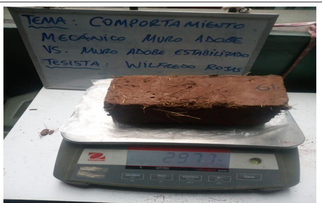
Fotografía : de ensayo de succión , peso muestra saturada adobe estabilizado 6%
