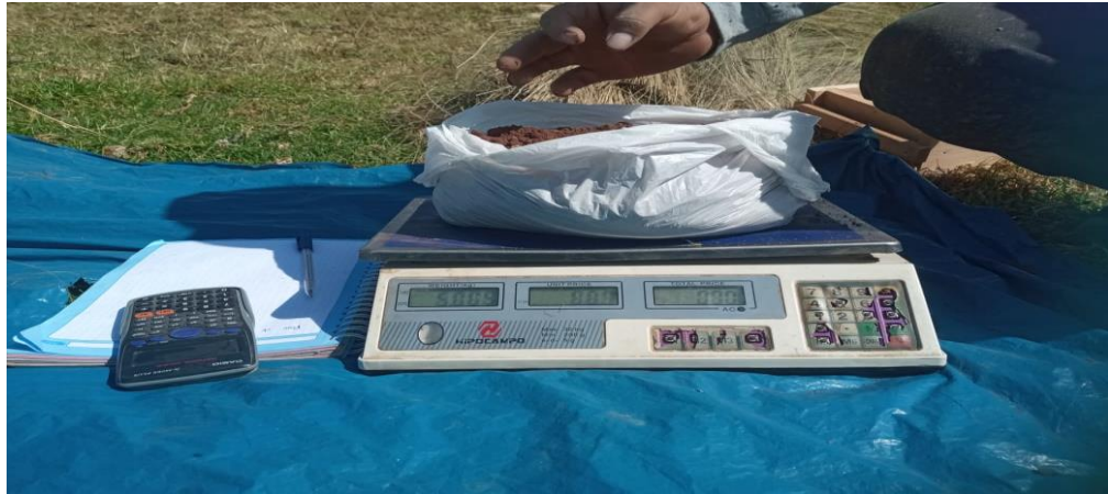
Fotografía: De toma de peso del materia tierra (arcilla )
