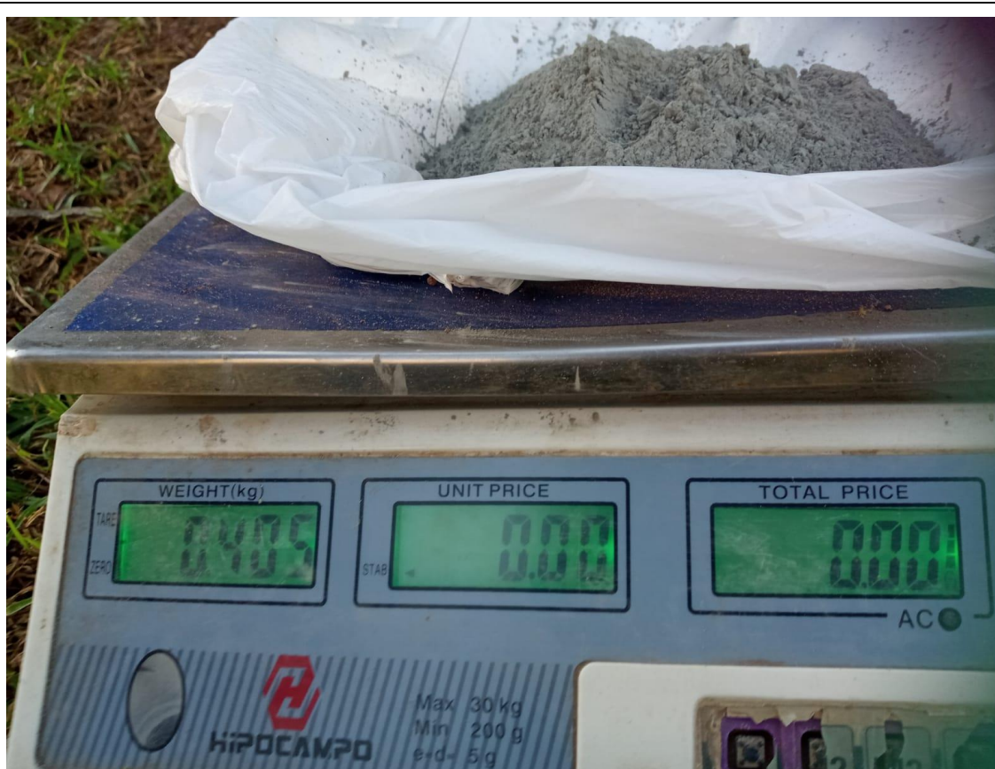
Fotografía: Toma de peso del cemento portland tipo I para adición 8%
