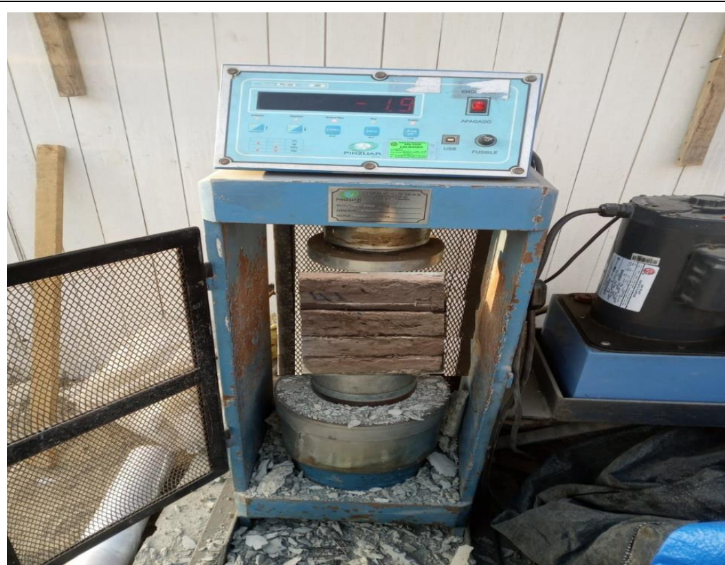
Fotografía : ensayo a compresión de murete laboratorio adobe estabilizado 8%
