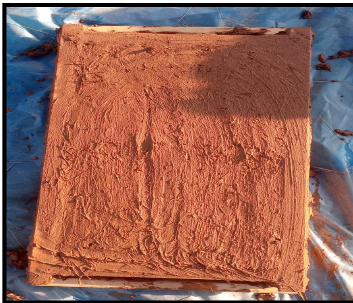
Figura 6. Elaboración de adobes
