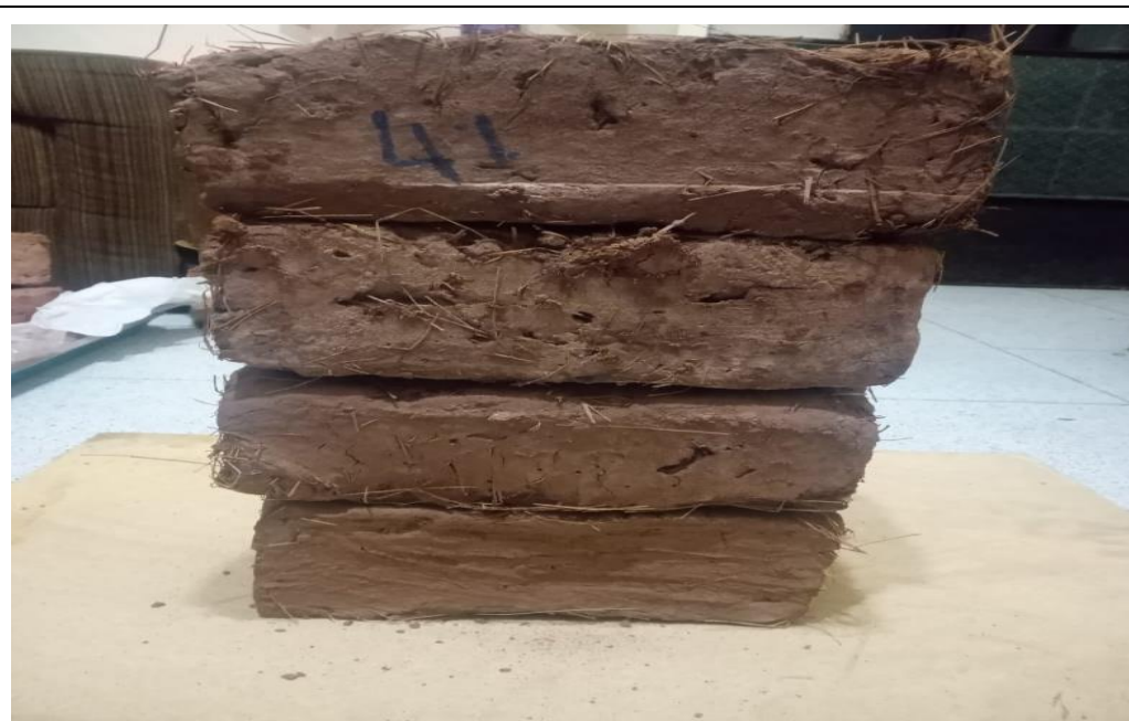
Fotografía: ensayo a compresión por murete de adobe estabilizado 4%
