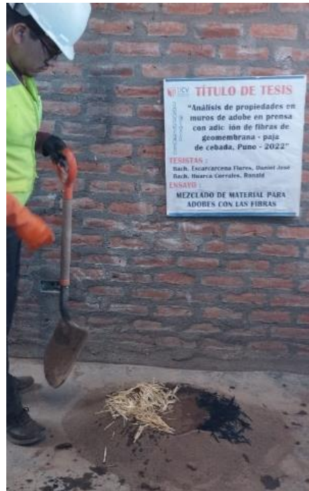
Fotografía 20: Mezclado del suelo con las fibras.
