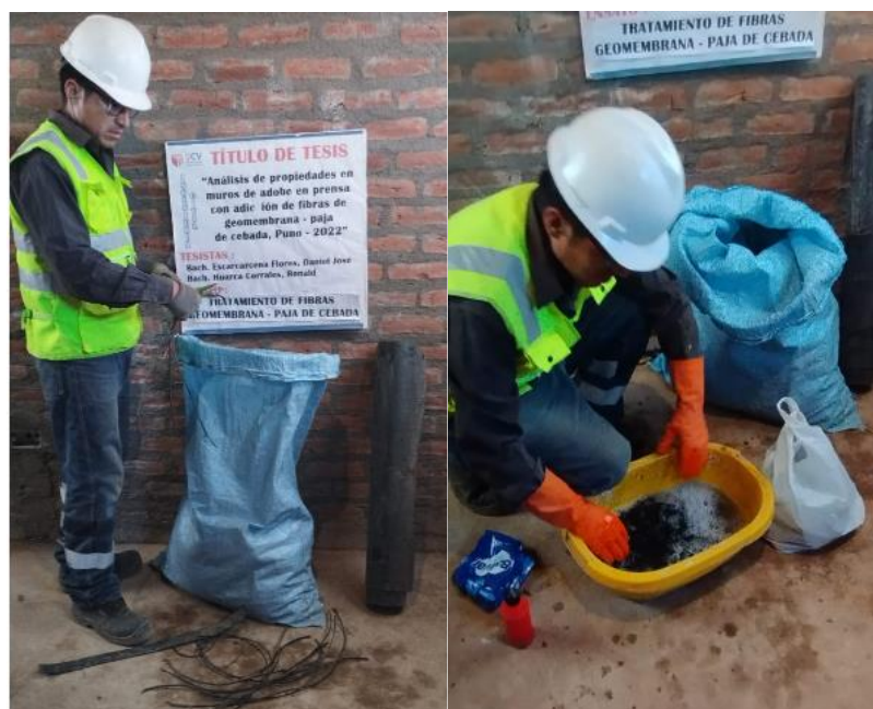
Figura 10. Tratamiento de fibras de geomembrana
