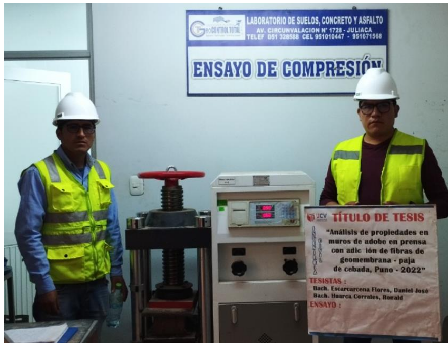
Figura 35. Ensayo de resistencia a la compresión simple en unidades de adobe compactado.
