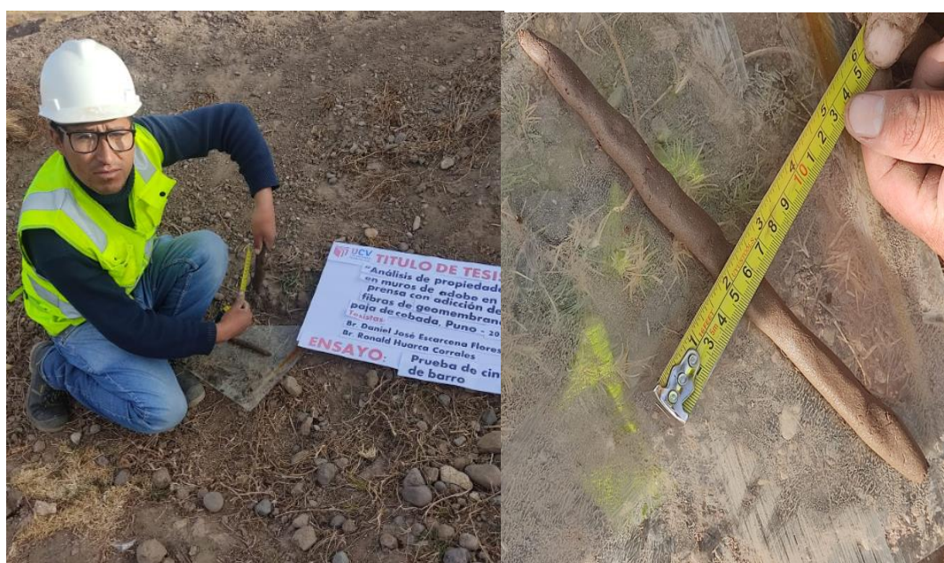
Figura 20. Prueba de cinta de barro en las dos canteras.
