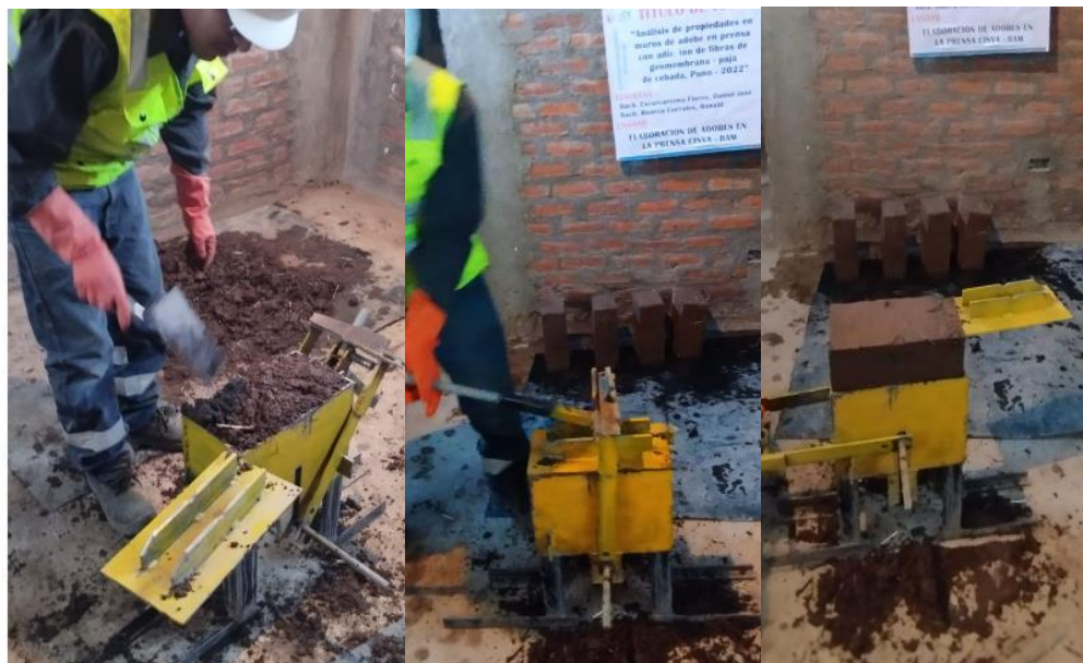
Figura 15. Máquina CINVA RAM, elaboración de adobe.
