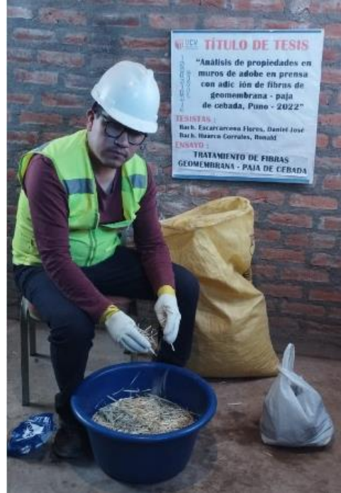
Fotografía 16: Tratamiento de las fibras de paja de cebada
