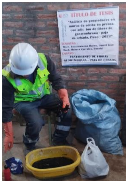
Fotografía 13: Tratamiento de las fibras de geomembrana.
