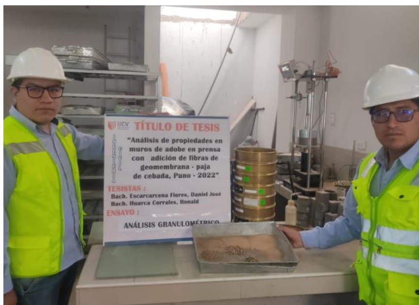
Figura 24. Ensayo de análisis granulométrico de las canteras.
