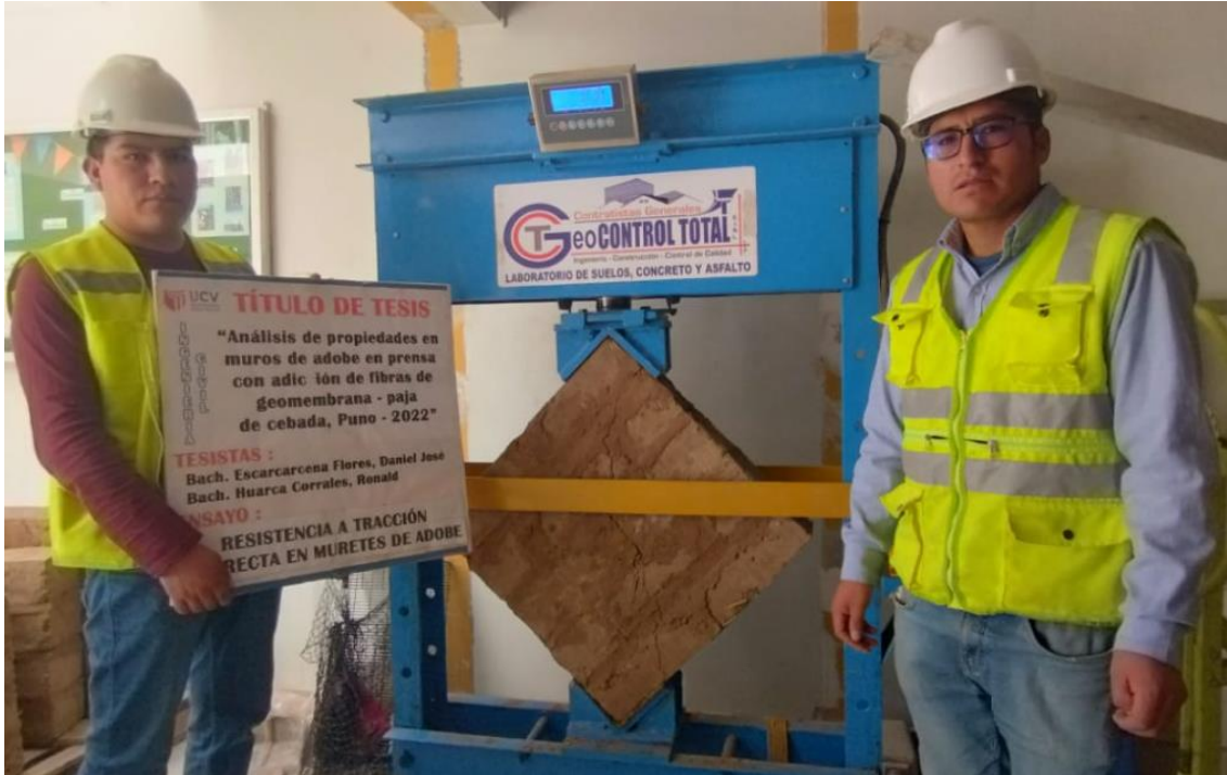
Figura 39. Resistencia a tracción indirecta en muretes de adobe
