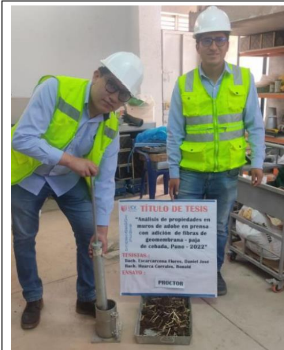
Fotografía 11: Ensayo de Proctor estándar en el laboratorio.
