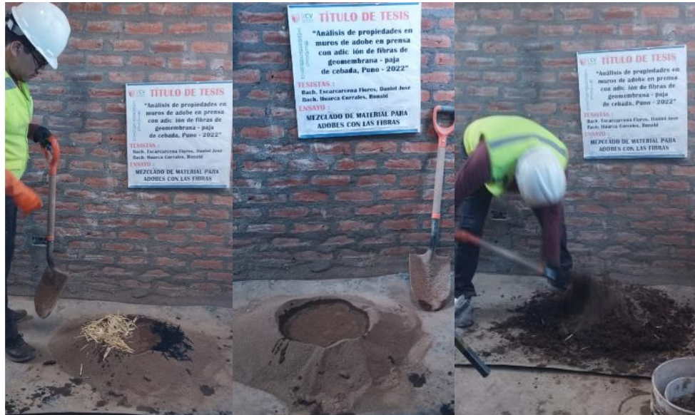
Figura 14. Mezclado de las fibras y agua para adobes.
