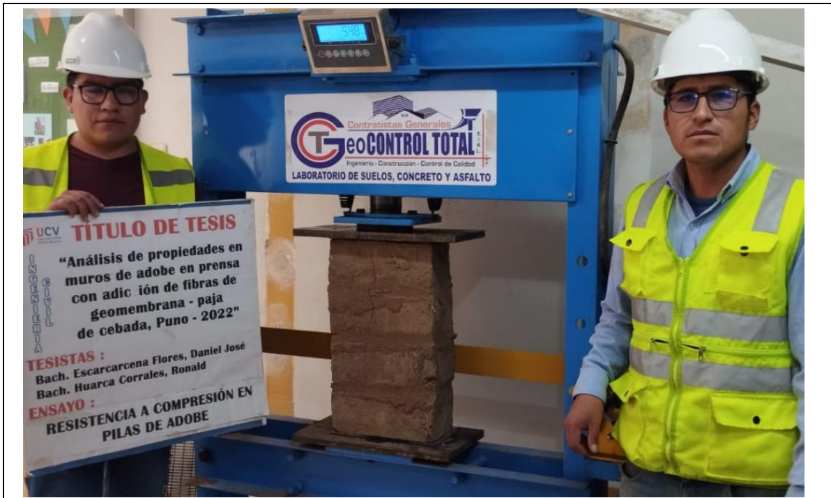
Fotografía 29: Ensayo de resistencia a compresión axial de pilas de adobe en el laboratorio.
