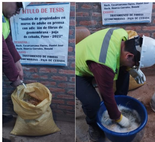
Figura 11. Tratamiento de las fibras de paja de cebada
