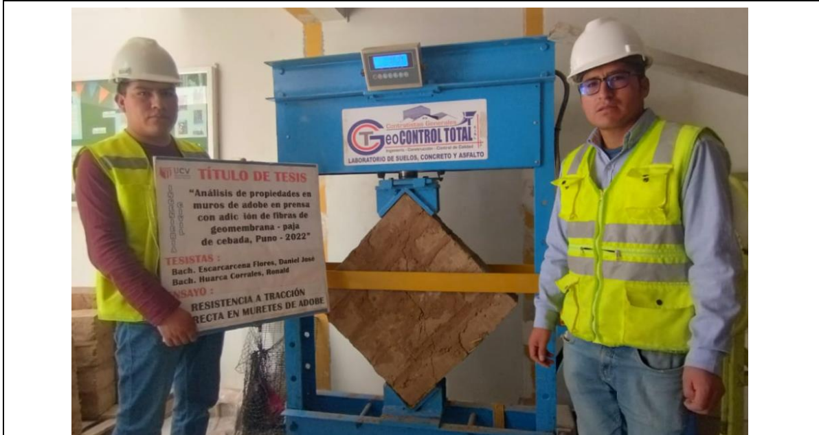
Fotografía 30: Ensayo de resistencia a tracción indirecta en muretes de adobe en el laboratorio.
