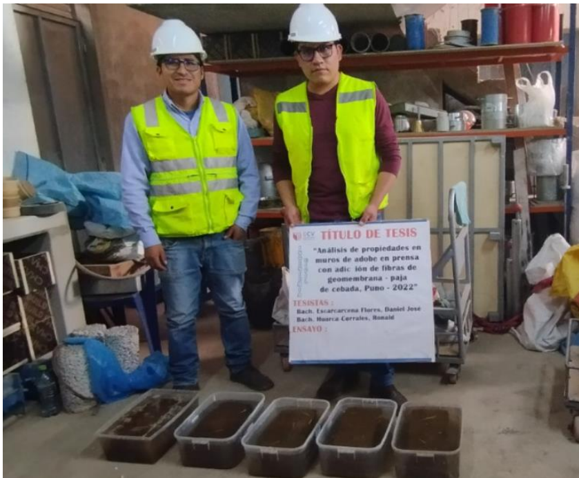
Fotografía 27: Ensayo de absorción de unidades de adobe en el laboratorio.
