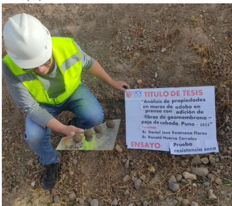
Figura 21. Ejecución de la prueba de resistencia seca en las canteras según la norma E.080.
