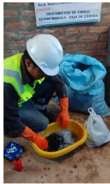
Fotografía 14: Tratamiento de las fibras de geomembrana.
