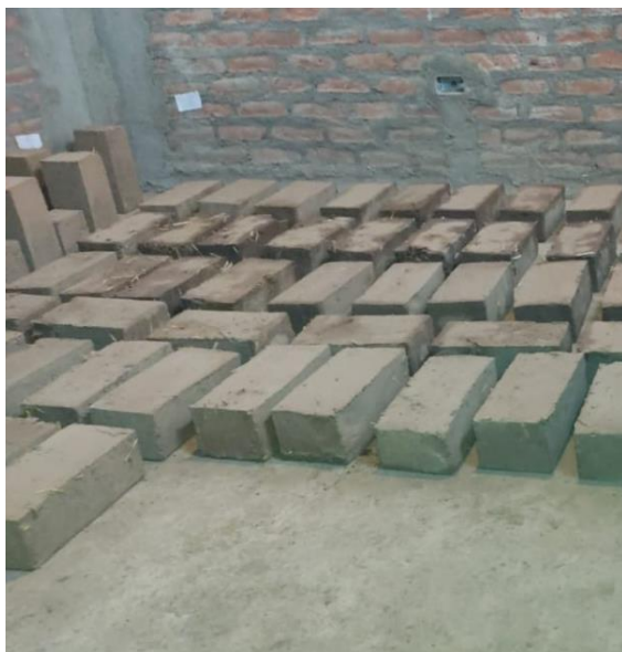
Fotografía 25: Almacenamiento y secado de adobes.
