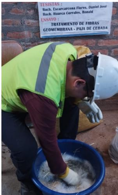
Fotografía 17: Tratamiento de las fibras de paja de cebada
