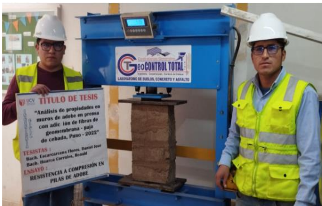
Figura 37. Ensayo de resistencia a la compresión axial en pilas de adobe compactado
