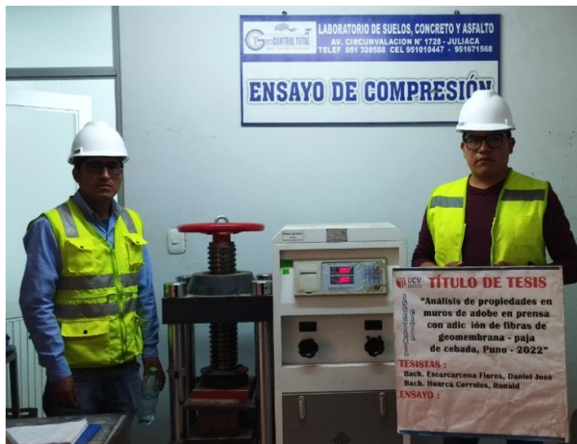
Fotografía 28: Ensayo de resistencia a compresión simple de unidades de adobe en el laboratorio.
