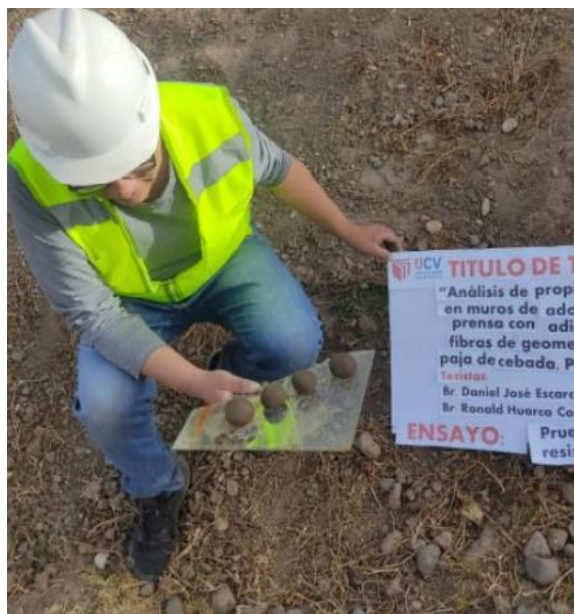
Fotografía 04: prueba de resistencia seca in-situ.
