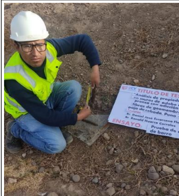
Fotografía 03: Prueba de cinta de barro in-situ
