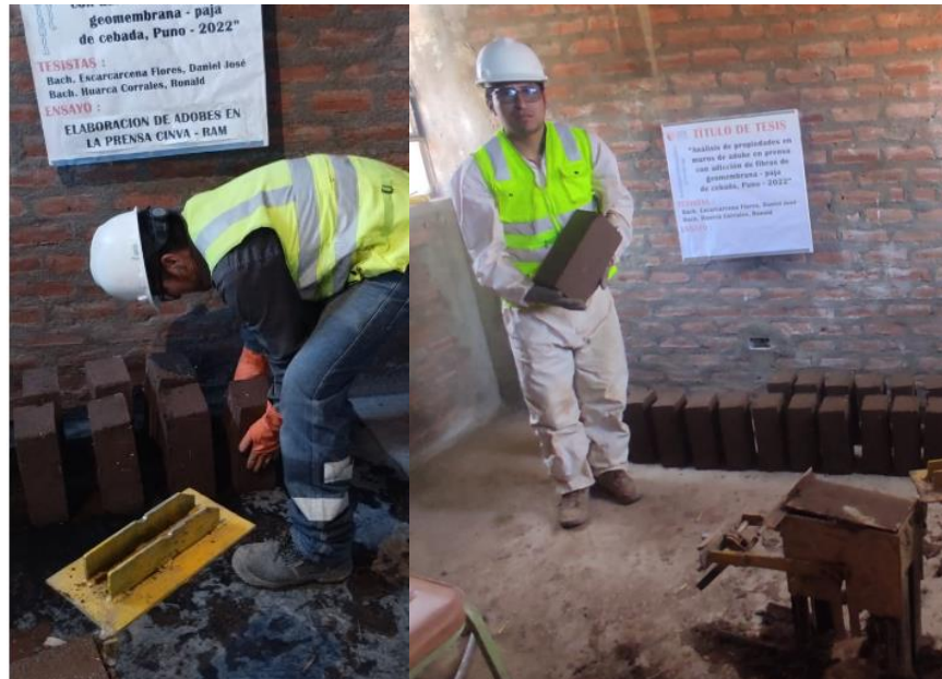
Figura 16. Elaboración y almacenamiento de adobes compactados.
