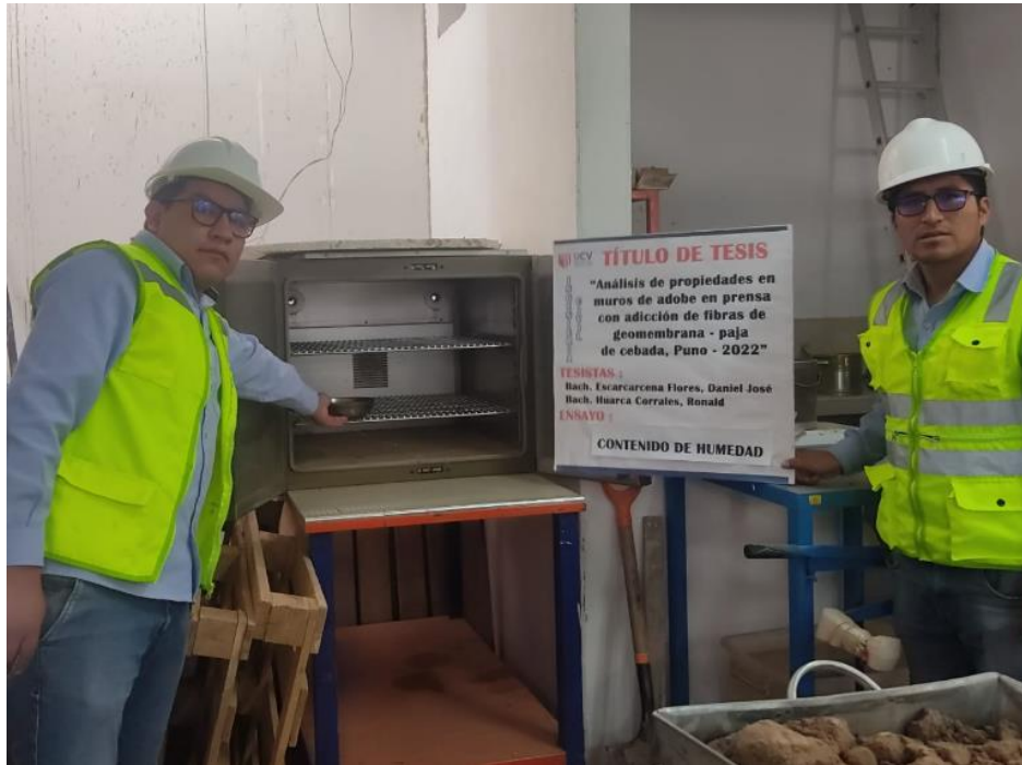
Fotografía 05: Ensayo de contenido de humedad en el laboratorio.
