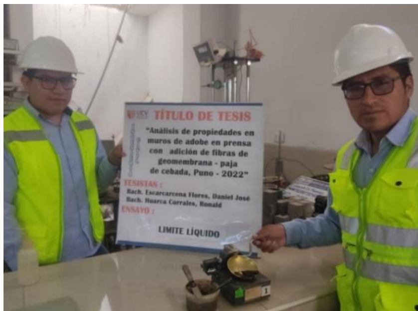
Fotografía 10: Ensayo de limite liquido en el laboratorio.
