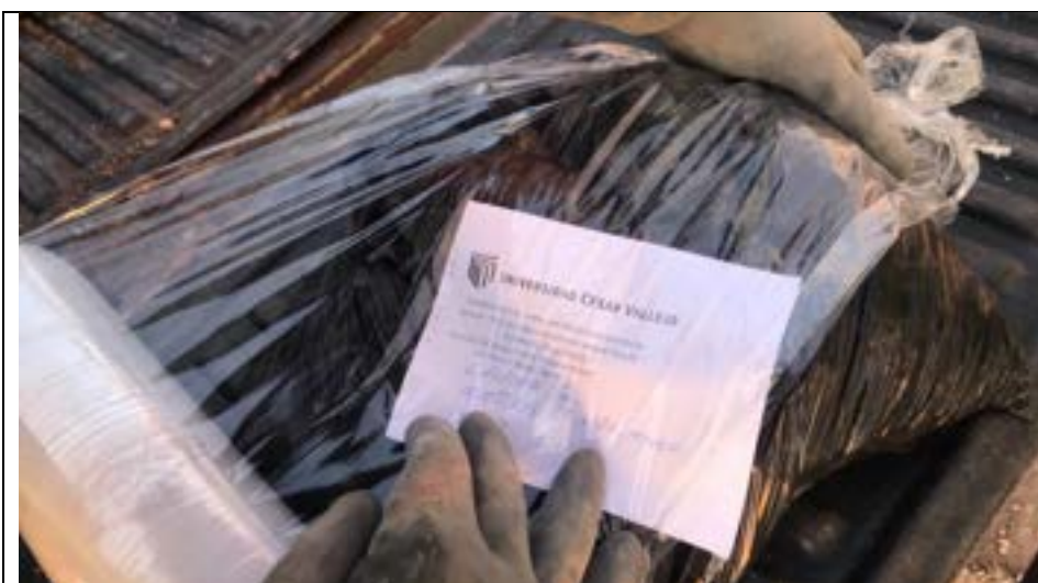
Imagen 12: Muestra de la calicata N° 02.
