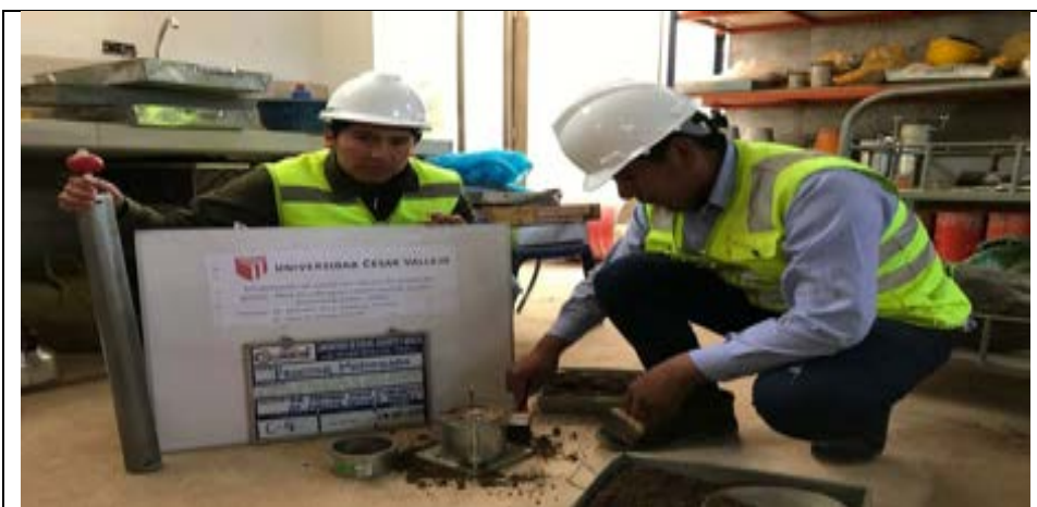
Imagen 71: Se observa la muestra y los equipos para el Proctor modificado C-04.
