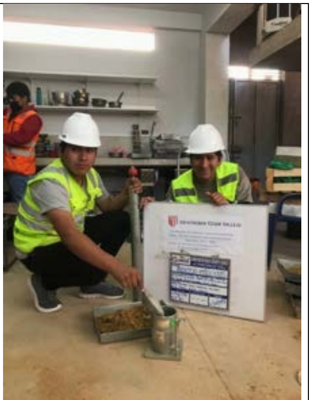
Imagen 79: Se observa el ensayo de Proctor con las dosificaciones de la C-2.
