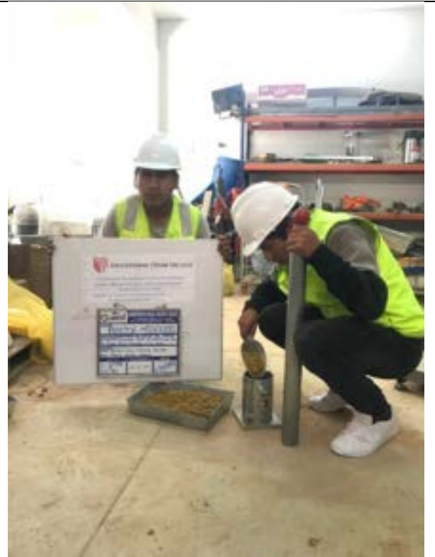
Imagen 85: Se observa el ensayo de Proctor con las dosificaciones de la C-3.
