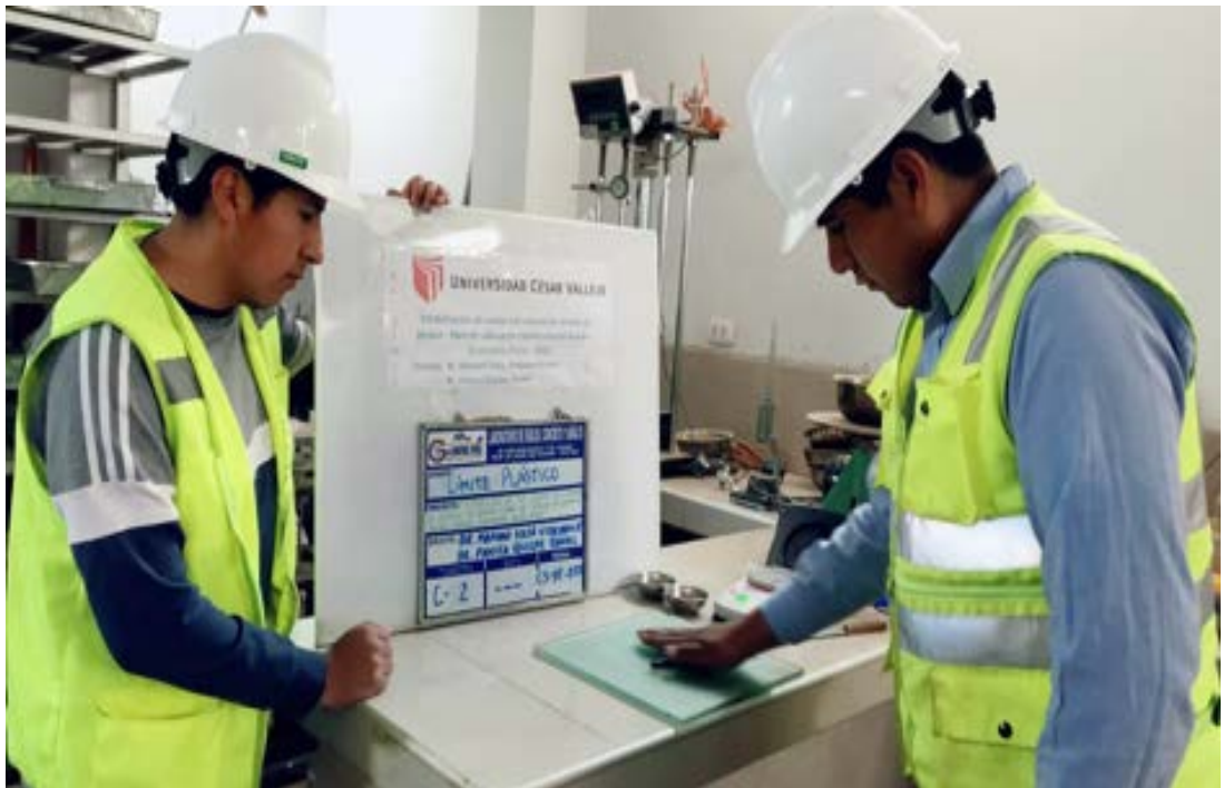
Figura 32. Determinación del límite plástico de la C-03.
