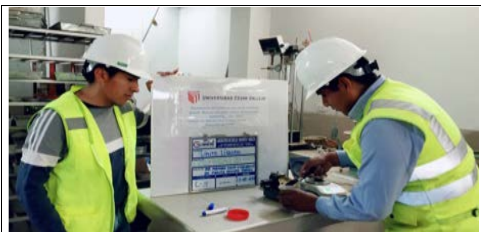
Imagen 57: Se observa el ensayo del límite líquido de la C-04.
