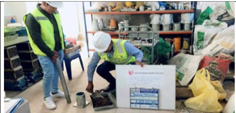
Imagen 68: Se observa la muestra y los equipos para el Proctor modificado C-03.
