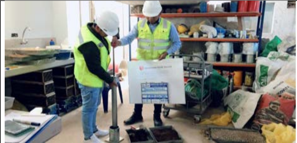
Imagen 67: Se observa la muestra y los equipos para el Proctor modificado C-02.
