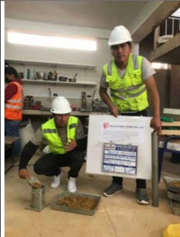
Imagen 76: Se observa el ensayo de Proctor con las dosificaciones de la C-02.
