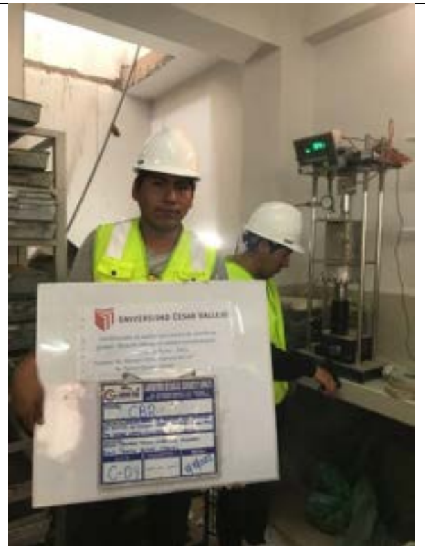
Imagen 75: Se observa el ensayo de CBR de la C-04.
