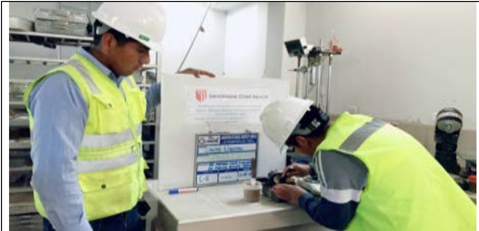
Imagen 55: Se observa el ensayo del límite líquido de la C-02.
