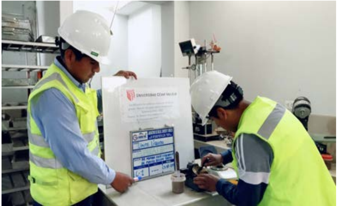
Figura 31. Determinación del límite líquido de la C-02.
