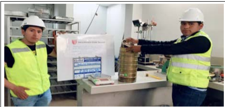
Imagen 53: Se observa el análisis granulométrico de la C-04.
