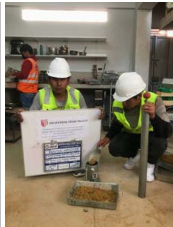
Imagen 90: Se observa el ensayo de Proctor con las dosificaciones de la C-4.
