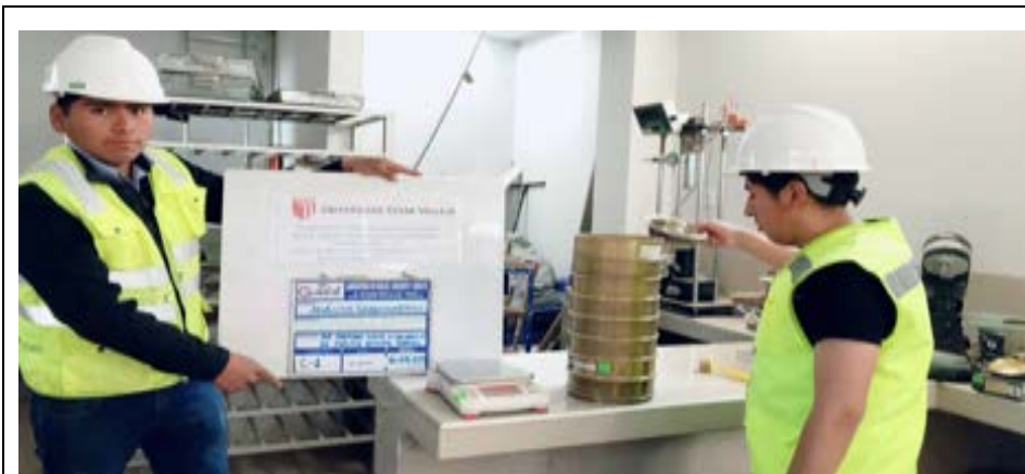
Imagen 50: Se observa el análisis granulométrico de la calicata 01.
