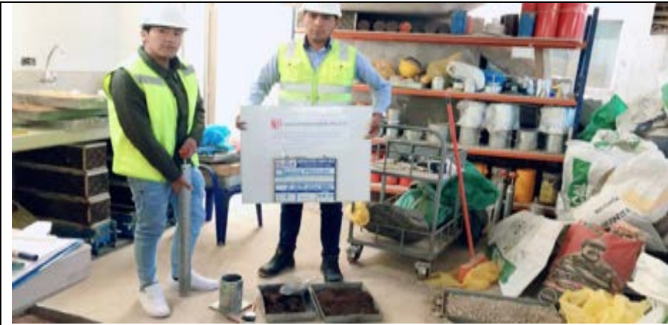
Imagen 64: Se observa la muestra y los equipos para el Proctor modificado C-02.
