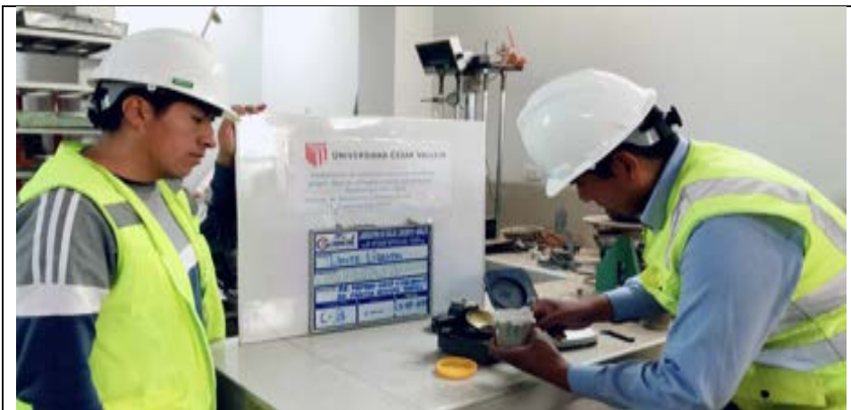
Imagen 56: Se observa el ensayo del límite líquido de la C-03.
