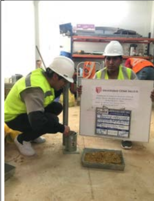
Imagen 80: Se observa el ensayo de Proctor con las dosificaciones de la C-2.
