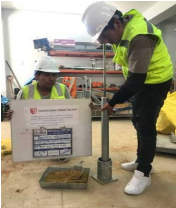
Figura 39. Proctor Modificado con la Incorporación de CSG + FC.
