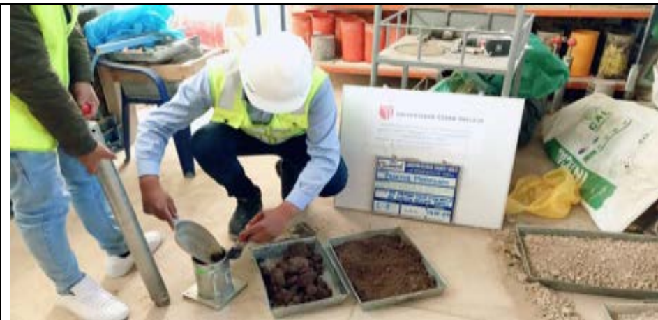
Imagen 65: Se observa la muestra y los equipos para el Proctor modificado C-02.
