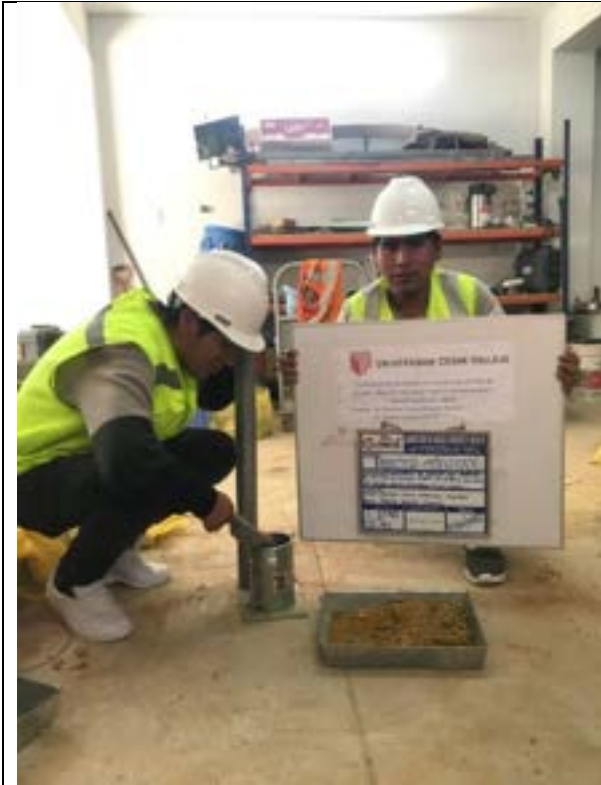
Imagen 84: Se observa el ensayo de Proctor con las dosificaciones de la C-3.
