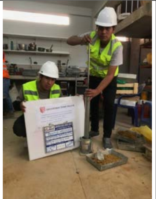
Imagen 81: Se observa el ensayo de Proctor con las dosificaciones de la C-2.
