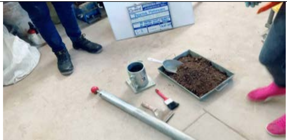
Imagen 62: Se observa la muestra y los equipos para el Proctor modificado C-01.
