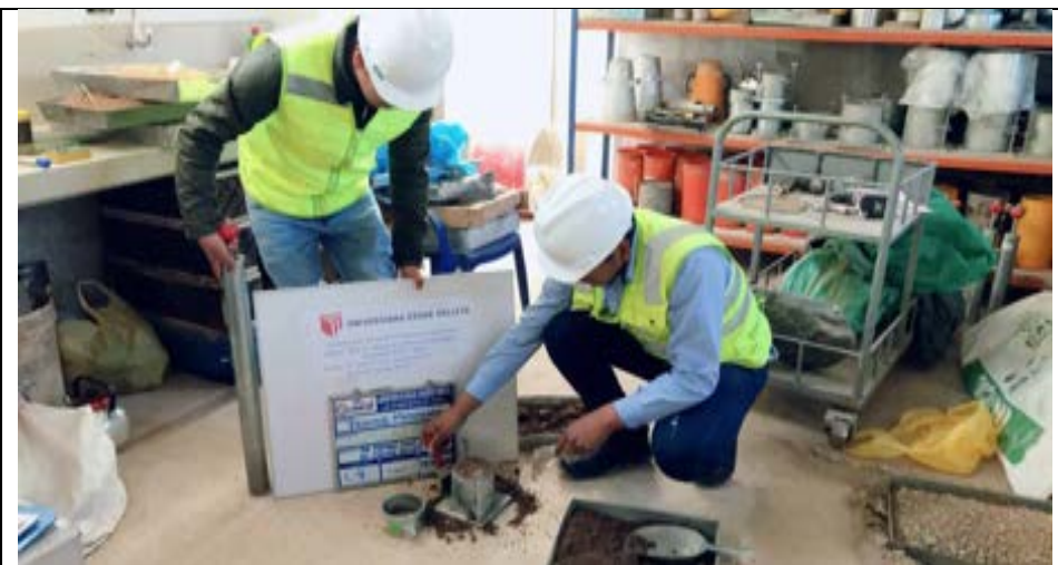
Imagen 69: Se observa la muestra y los equipos para el Proctor modificado C-04.
