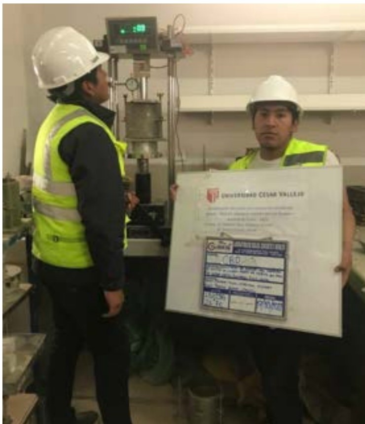
Figura 44. Ensayo de CBR con adición de CSG + FC.
