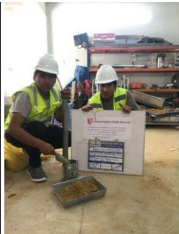
Imagen 78: Se observa el ensayo de Proctor con las dosificaciones de la C-2.
