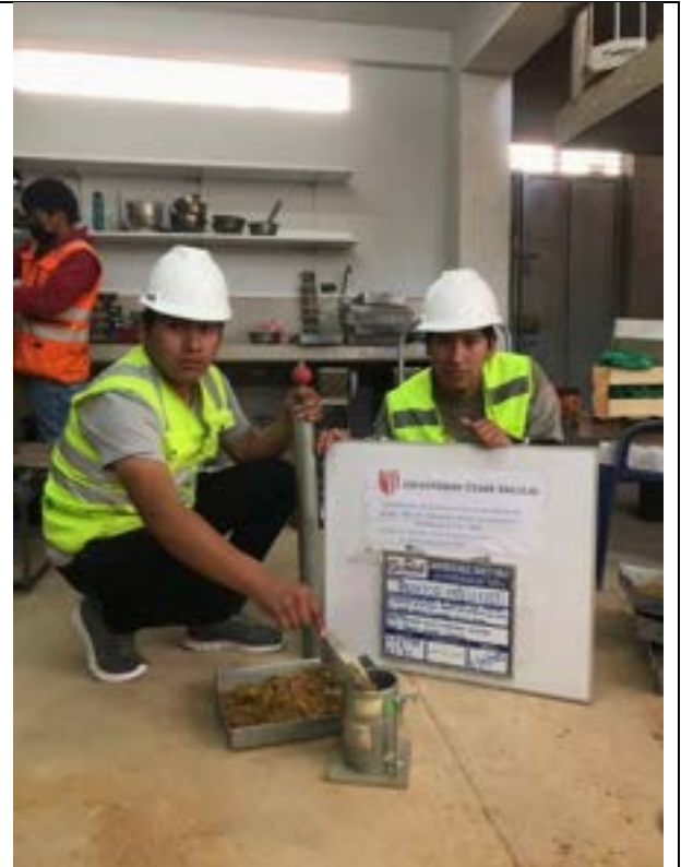
Imagen 77: Se observa el ensayo de Proctor con las dosificaciones de la C-02.
