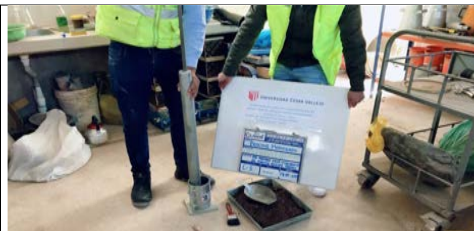
Imagen 66: Se observa la muestra y los equipos para el Proctor modificado C-01.
