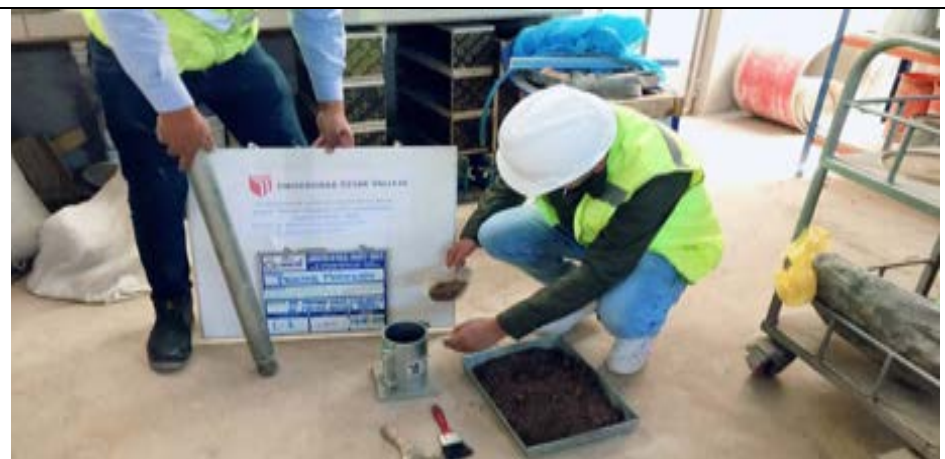
Imagen 63: Se observa la muestra y los equipos para el Proctor modificado C-01.
