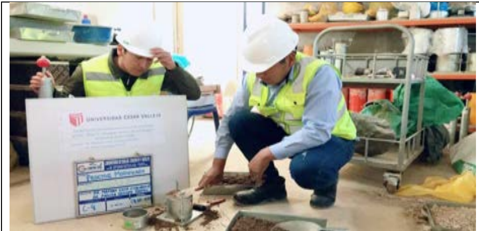
Imagen 70: Se observa la muestra y los equipos para el Proctor modificado C-04.
