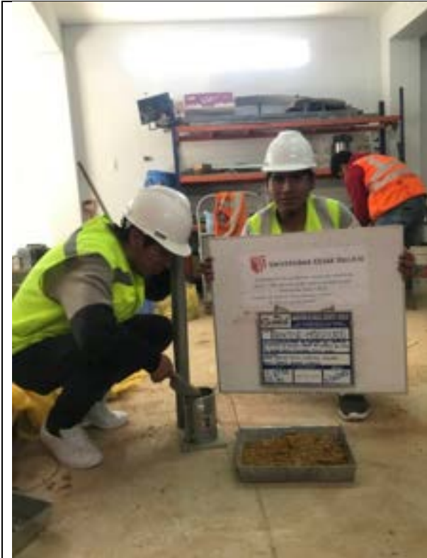
Imagen 88: Se observa el ensayo de Proctor con las dosificaciones de la C-4.
