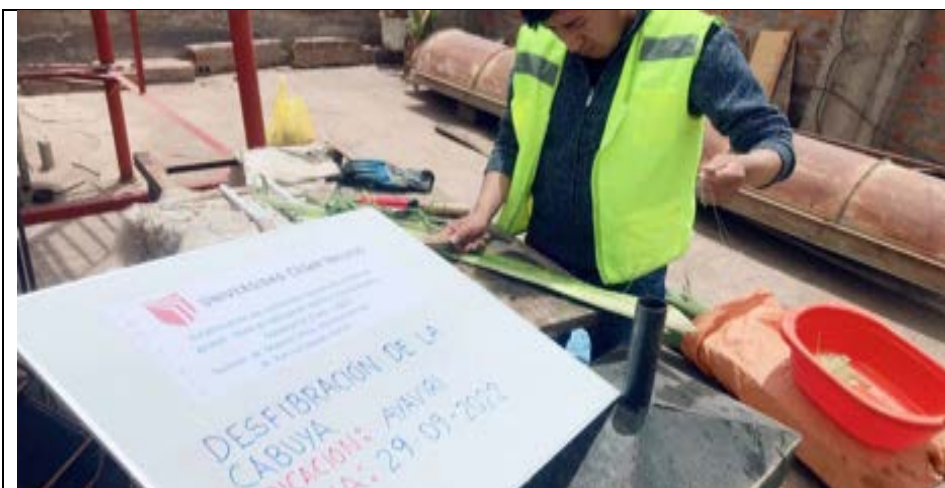
Imagen 33: Se observa el desfibrado de la fibra de cabuya.
