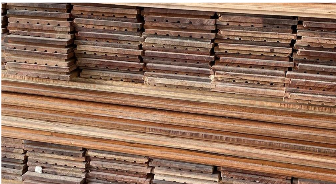
Figura 9: Pisos Decks en proceso, antes de baño con barniz DD
