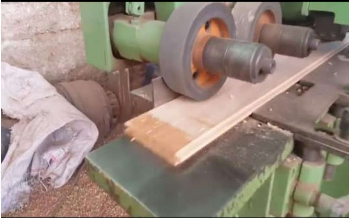
Figura 14: Operación de Espigado hembra en la tabla
