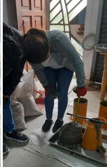
Realizamos el ensayo de asentamiento slump
