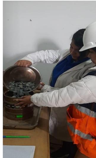
Se realizo el ensayo de granulometría
