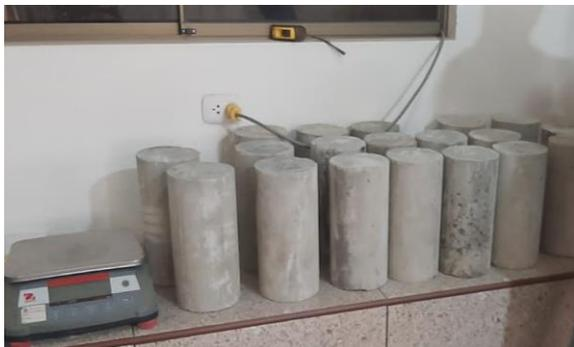
Se aprecia los testigos de concreto
