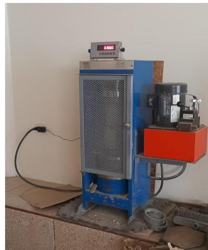
Equipo de ensayo a compresión
