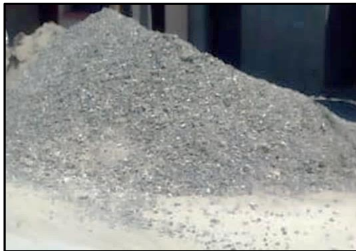
Figura 2 Agregado grueso Fuente: elaboración propia
