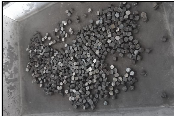
Figura 8 Muestras de fibras de acero reciclado Fuente: elaboración propia
