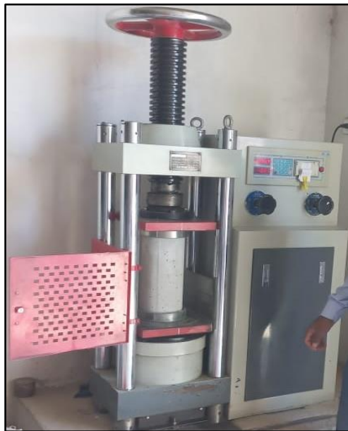
Figura 7 Prueba resistencia a la compresión Fuente: elaboración propia
