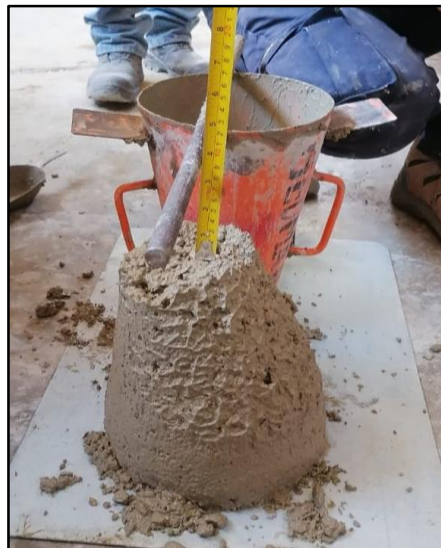
Figura 6 prueba de Slump Fuente: Elaboración propia
