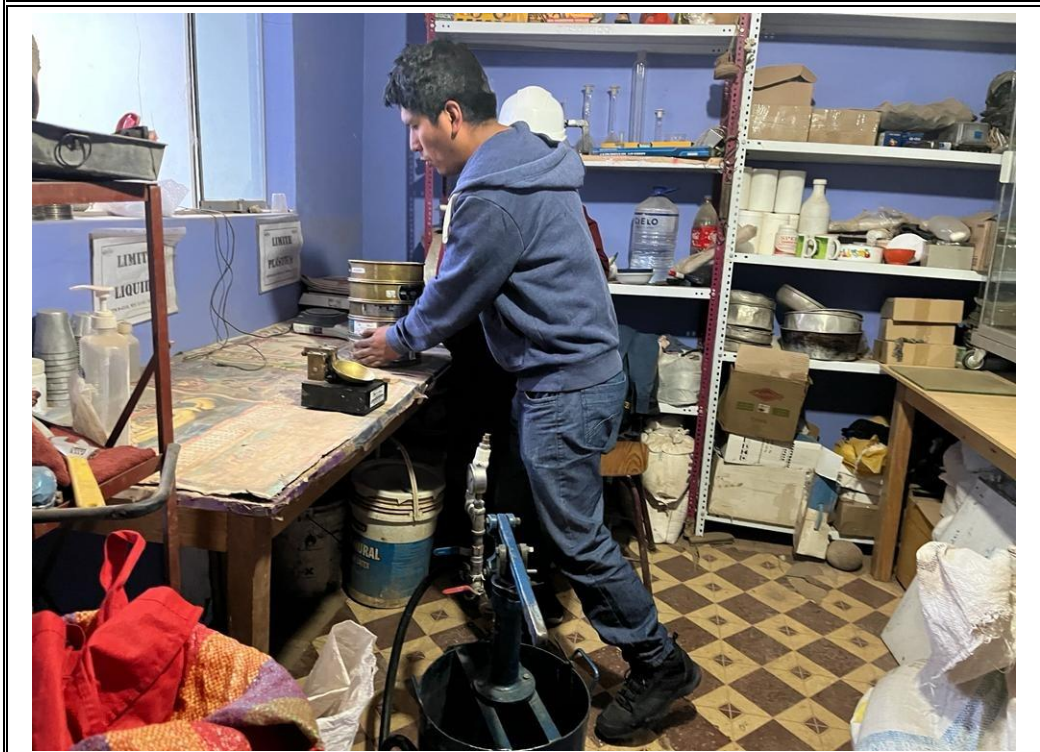
Fotografía N°2: Ensayo de granulometría del material de sedimentación con el auxiliar de laboratorio.
