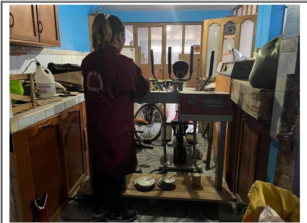
Fotografía N°1: Ensayo de corte directo en el laboratorio de suelos.
