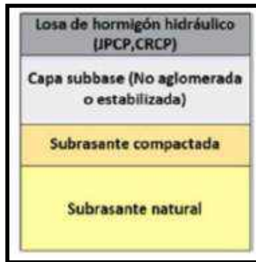
Figura 01. Estructuras posibles de pavimento
