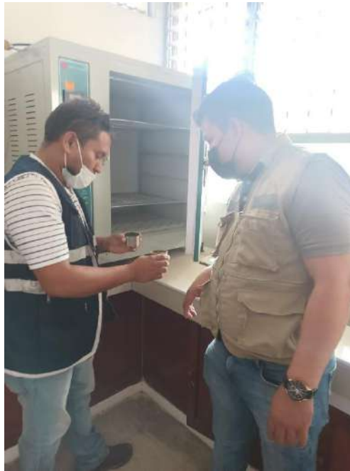
Foto N° 12: Sacando la muestra del horno eléctrico
