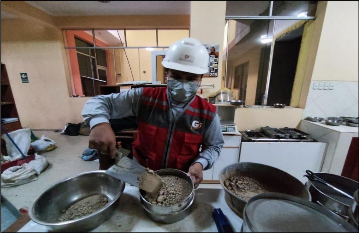
**Fotografía N°:** Tamizaje por la malla N°40 para los ensayos de limite líquido y plástico.
