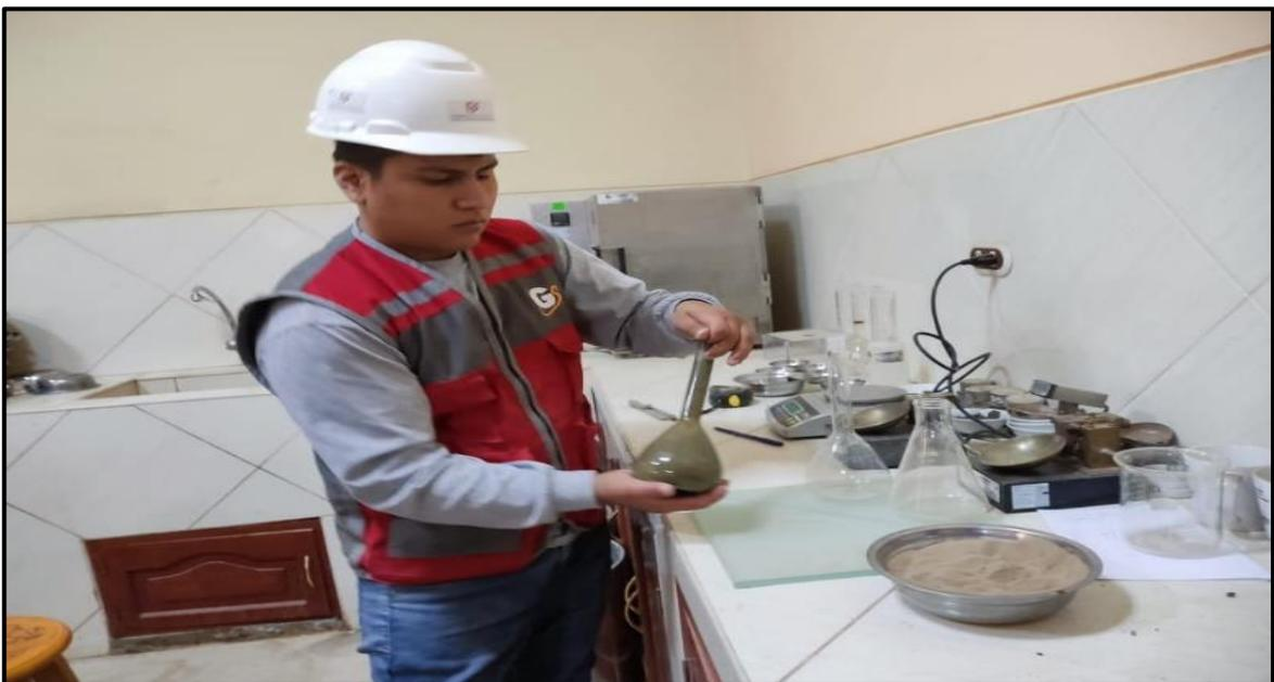
**Fotografía N°:** Ensayo de peso específico del suelo arcilloso.
