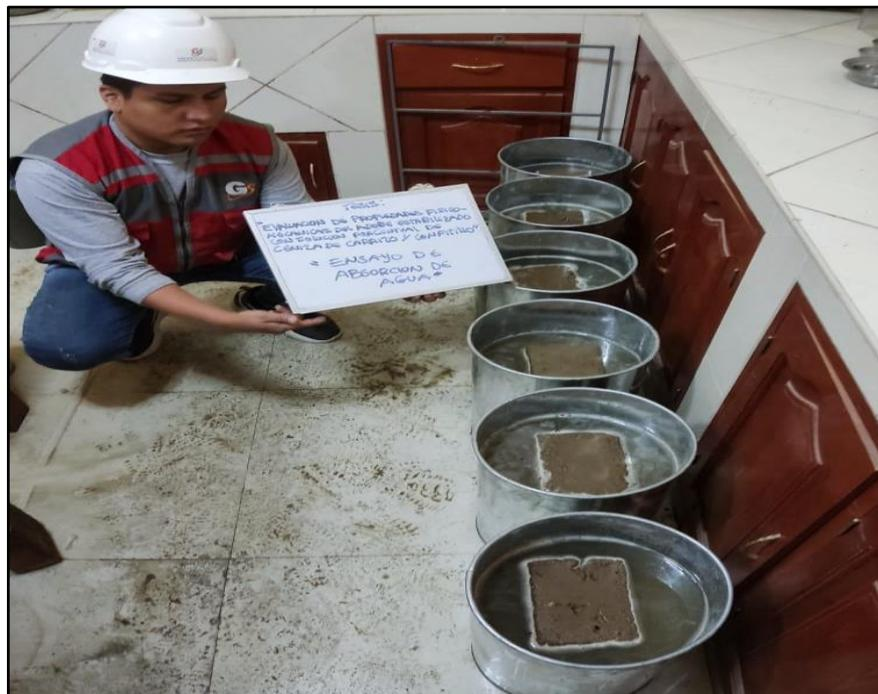
**Fotografía N°:** Ensayo de absorción de agua en bloques de adobe, por un tiempo de 12 horas.
