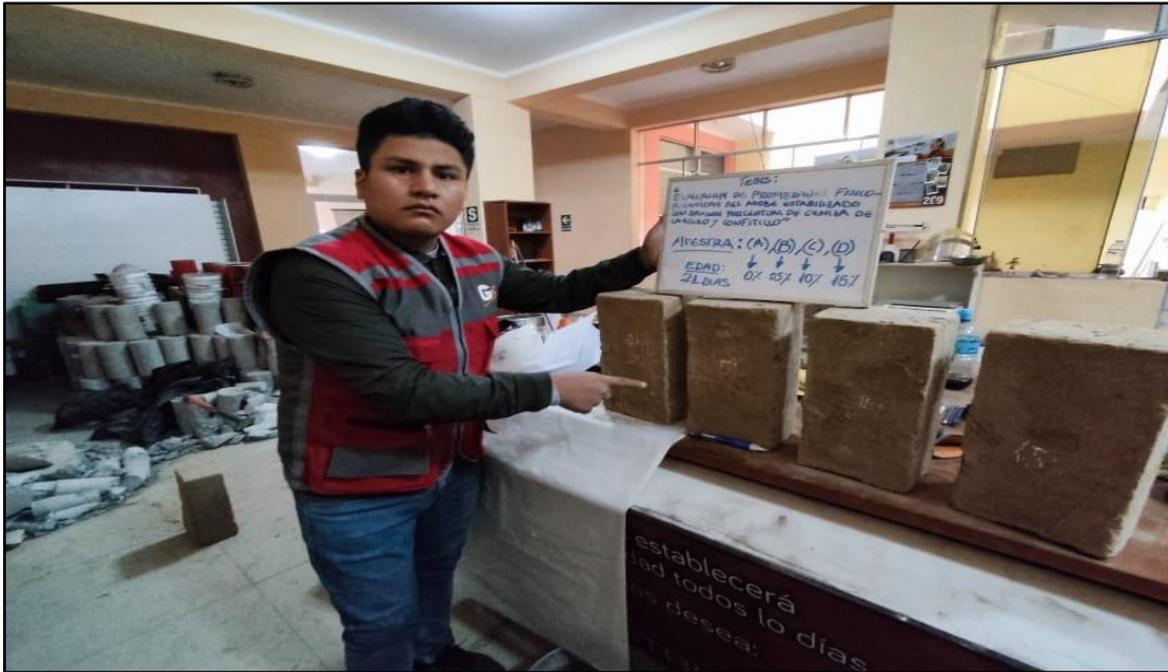
**Fotografía N°:** Bloques de adobe estabilizado con solución porcentual de ceniza de carrizo y confitillo al 05%, 10% y 15%, para el ensayo de resistencia a la compresión, a la edad de 21 días.
