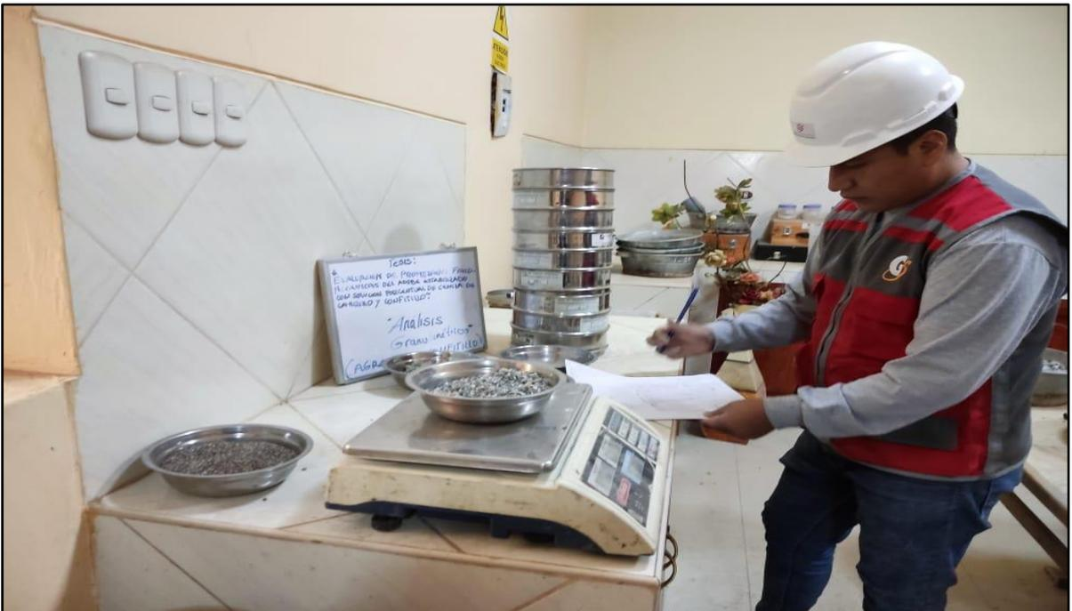
**Fotografía N°:** Peso retenido del proceso de tamizaje.
