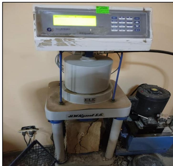
**Fotografía N°:** Ensayo de resistencia a la compresión de los bloques de adobe patrón (muestra A), a la edad de 21 días.
