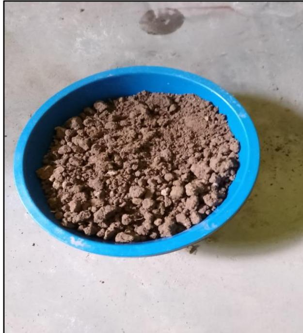
**Fotografía N°:** Se observa la arcilla lista para la elaboración de adobes.
