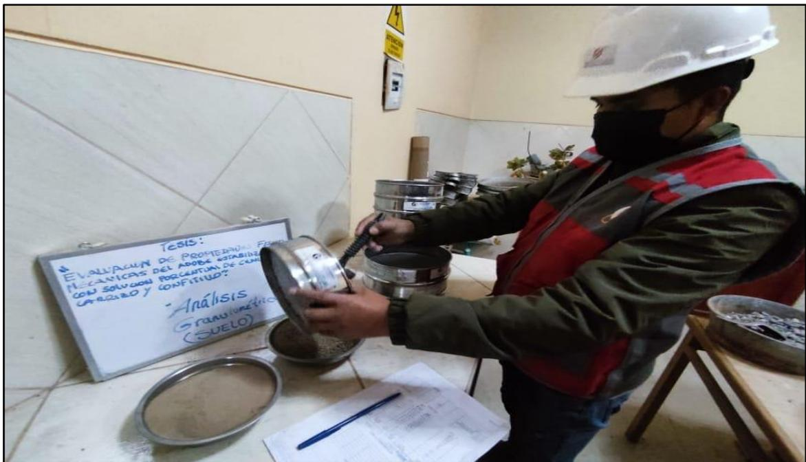
**Fotografía N°:** Material retenido del proceso de tamizaje.
