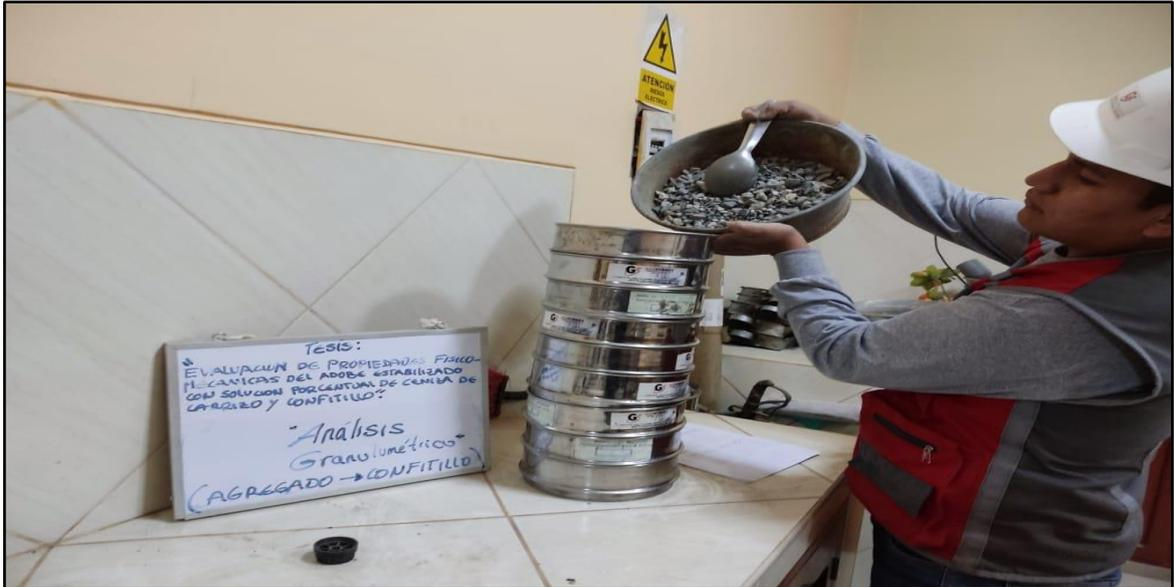
**Fotografía N°:** Análisis granulométrico por tamizaje del agregado (confitillo).
