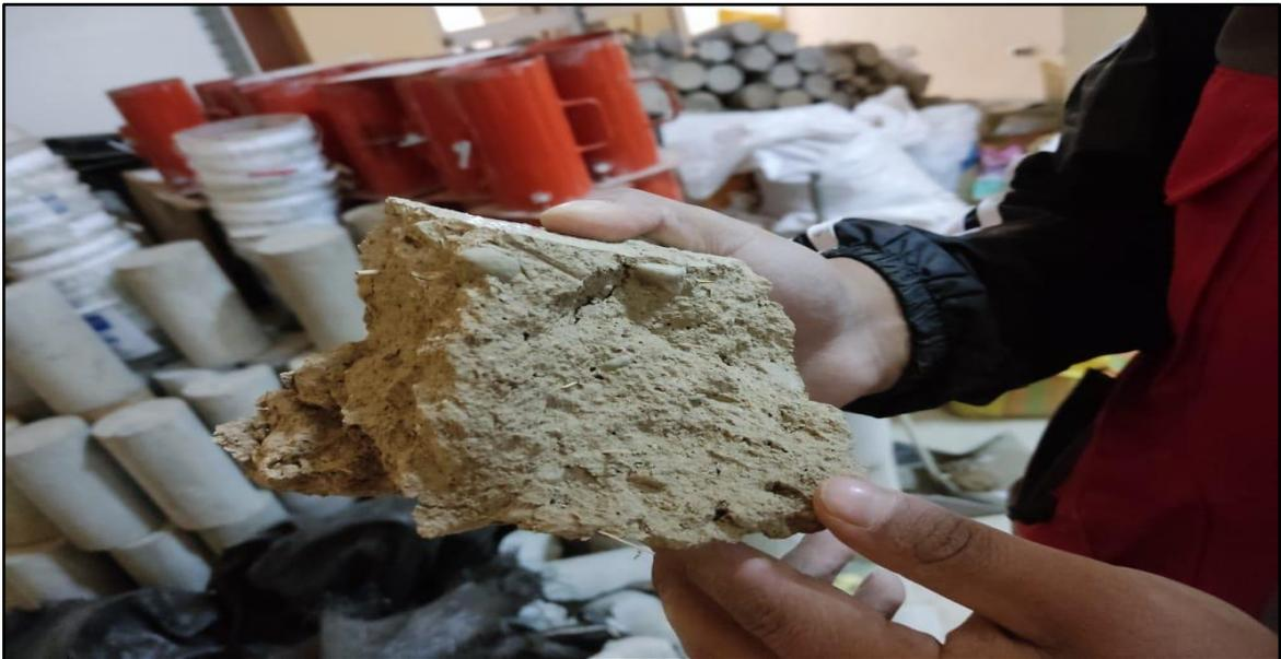
**Fotografía N°:** Se muestra los restos de la incorporación de ceniza de carrizo y confitillo después de la rotura.
