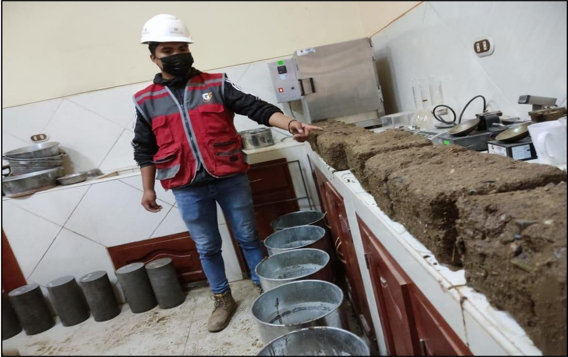
**Fotografía N°:** Las muestras sometidas al ensayo de absorción, son dejadas secar por 5 min, antes del pesado en muestra saturada (húmeda).
