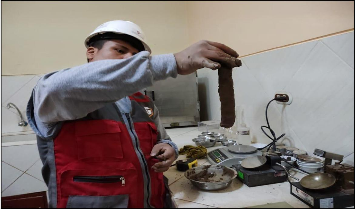
**Fotografía N°:** Verificación de la relación tierra / arcilla mediante la prueba de la cinta de barro.
