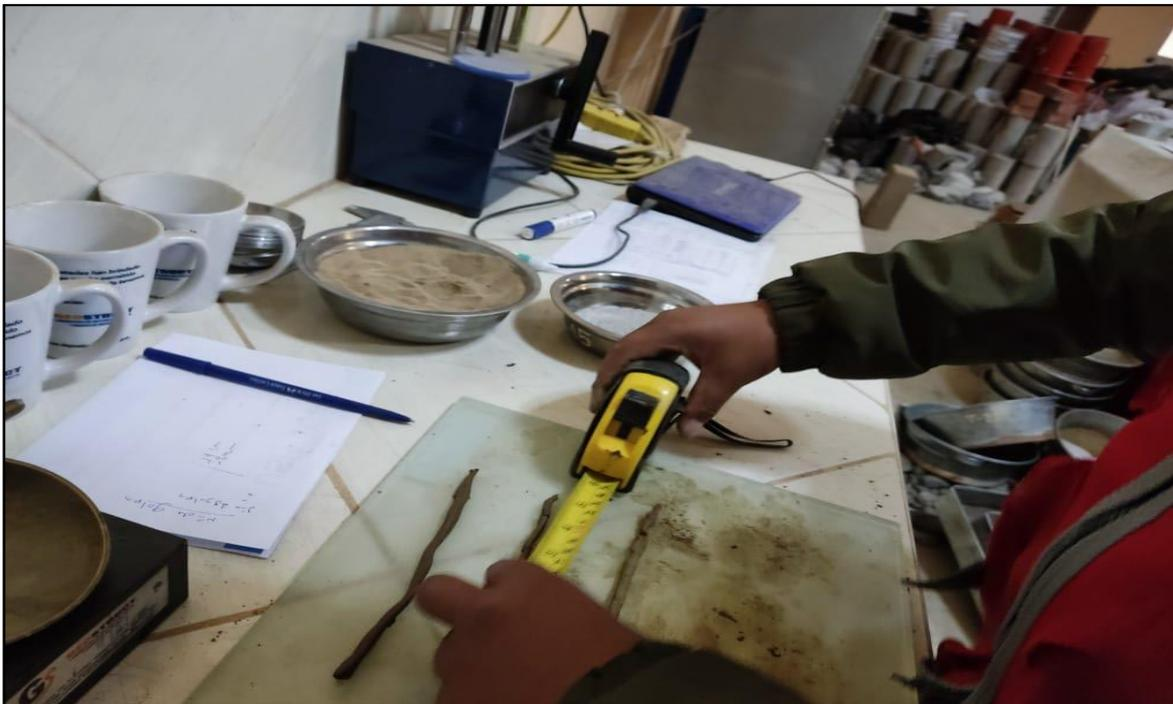
**Fotografía N°:** Ensayo de limite plástico del suelo arcilloso.
