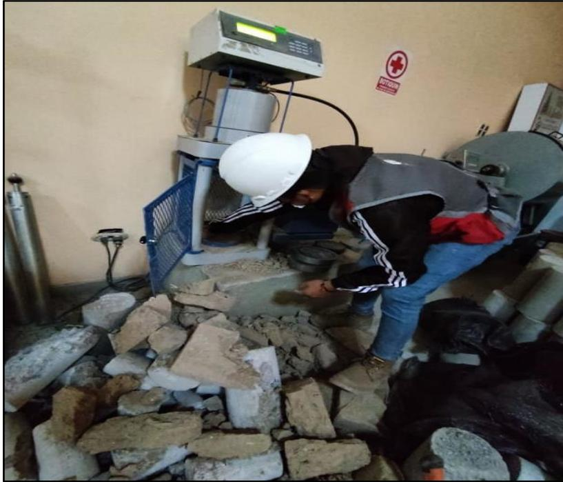
**Fotografía N°:** Ensayo de resistencia a la compresión a la edad de 28 días, al adobe patrón (muestra A).
