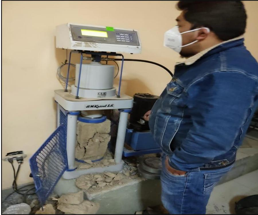
**Fotografía N°:** Ensayo de resistencia a la compresión de los bloques de adobe estabilizado con ceniza de carrizo y confitillo al 10% Y 15% (muestra C Y D), a la edad de 21 días, con la colaboración del técnico laboralista.
