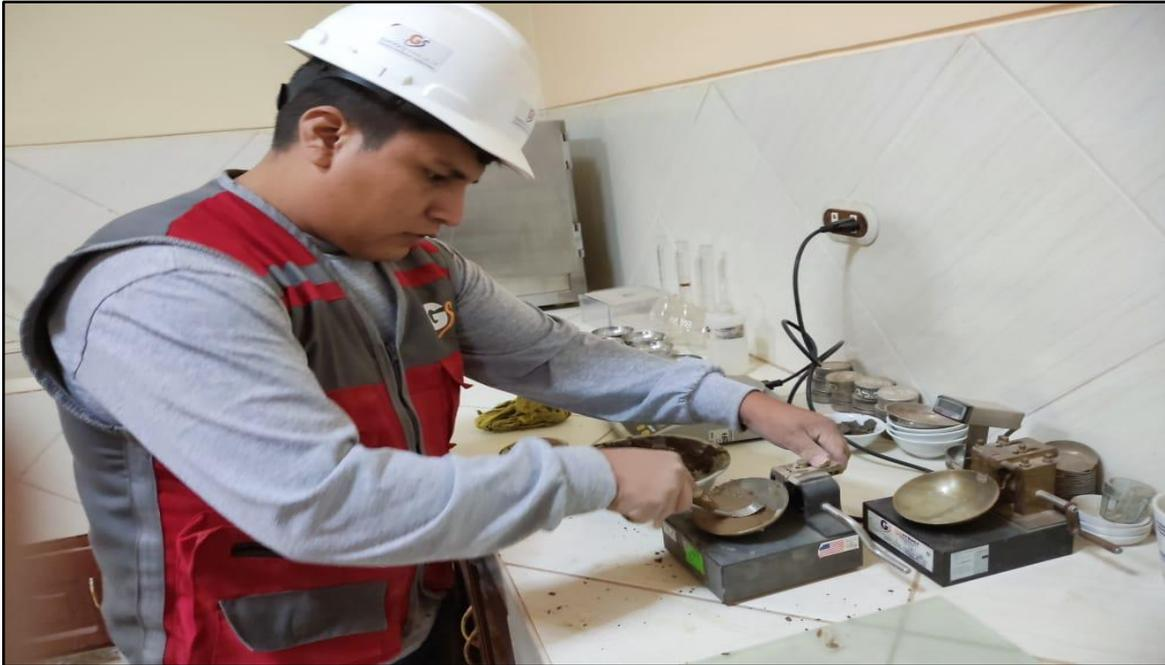
**Fotografía N°:** Ensayo de limite líquido del suelo arcilloso.
