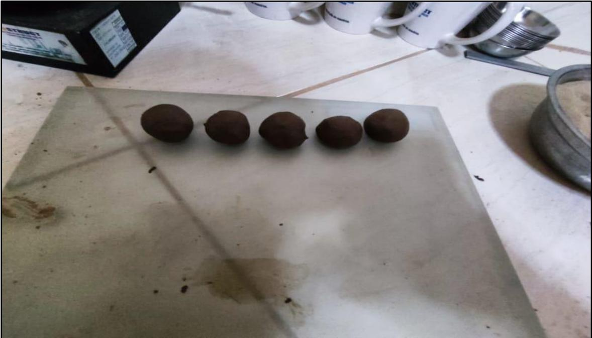
**Fotografía N°:** Verificación de la relación tierra / arcilla mediante la prueba resistencia seca.
