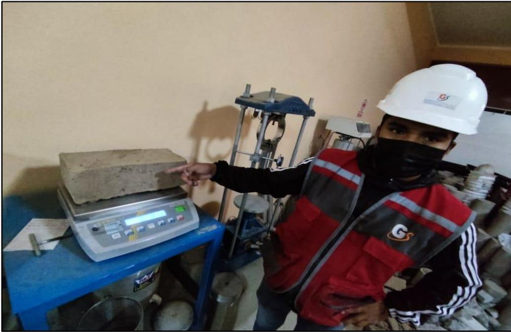
**Fotografía N°:** Pesado en muestra seca del bloque de adobe para el ensayo de absorción.
