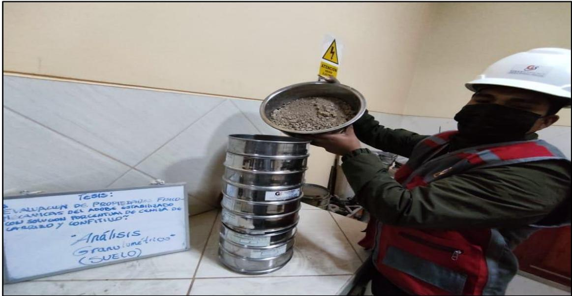
**Fotografía N°:** Análisis granulométrico por tamizaje del suelo arcilloso.
