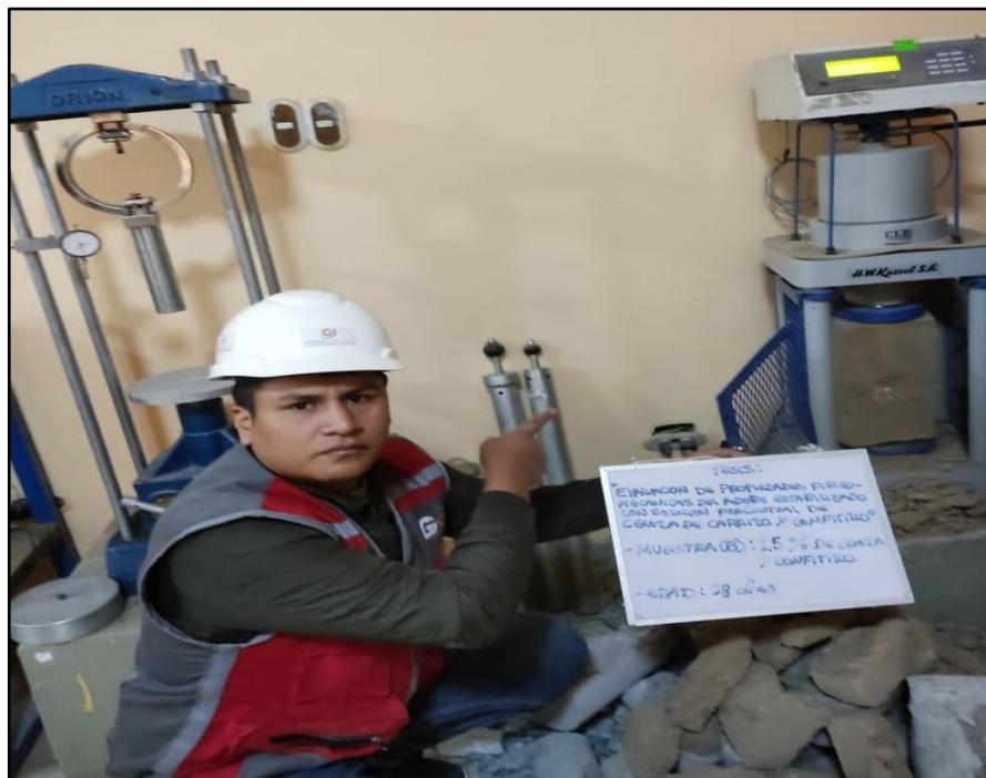
**Fotografía N°:** Ensayo de resistencia a la compresión a la edad de 28 días, al estabilizado con ceniza de carrizo y confitillo al 05%, 10% y 15% (muestra B, C Y D).
