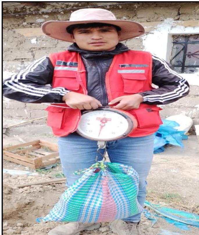
**Fotografía N°:** Pesado de suelo arcilloso para la elaboración de bloques de adobe patrón.
