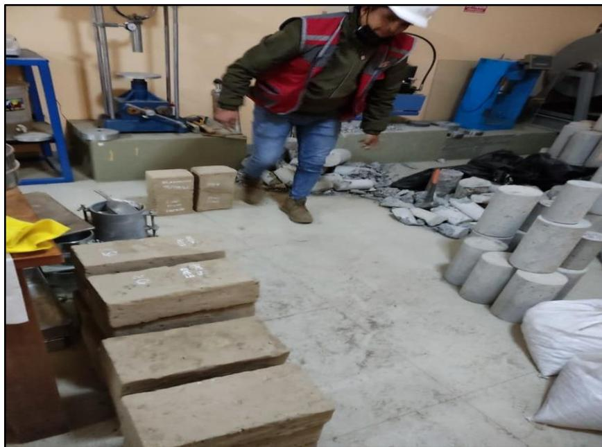
**Fotografía N°:** Ensayo de resistencia a la compresión de los bloques de adobe estabilizado con ceniza de carrizo y confitillo al 10% (muestra C), a la edad de 21 días.
