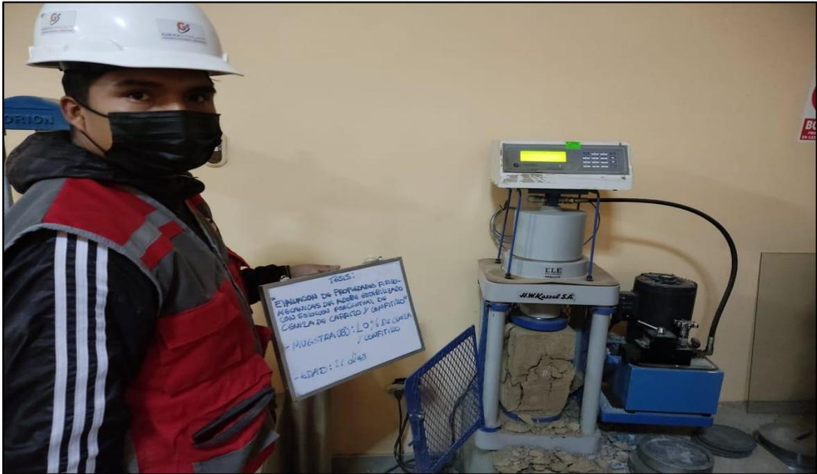
**Fotografía N°:** Ensayo de resistencia a la compresión de los bloques de adobe estabilizado con ceniza de carrizo y confitillo al 05% (muestra B), a la edad de 21 días.
