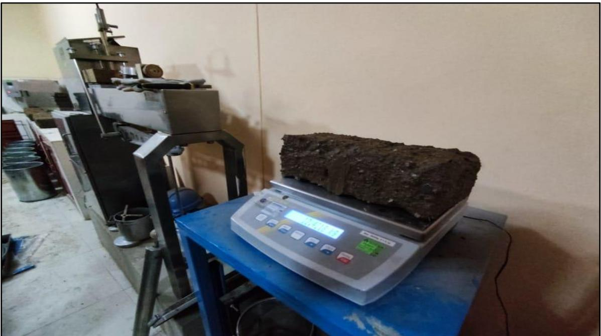
**Fotografía N°:** Pesado de la muestra saturada.
