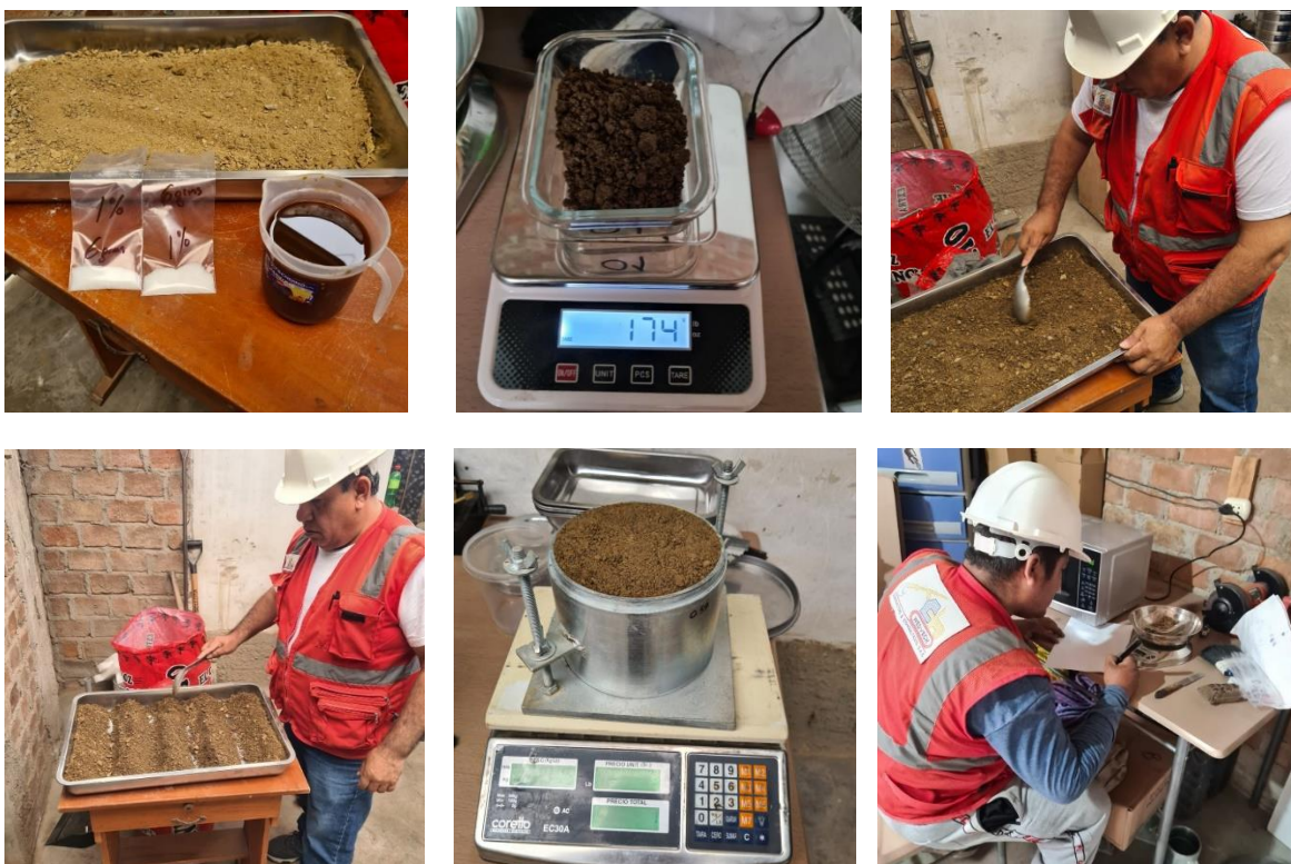
Figura Nº 16: Ensayo de Proctor modificado experimental incorporando a las muestras vinaza y polímero.
