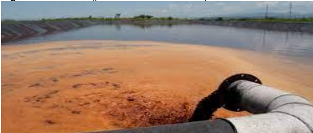
Figura N° 4: Vinaza (poza de almacenamiento)
