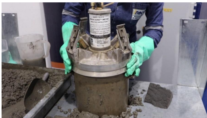
Figura 7. Ensayo de contenido de aire del concreto, método por presión.
