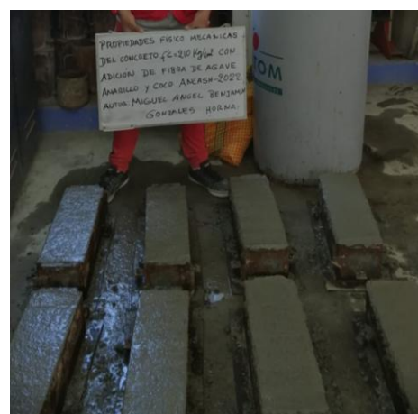
Fotografía 18. Elaboración de vigas de concreto f'c=210 \text{ kg/cm}^2 .
