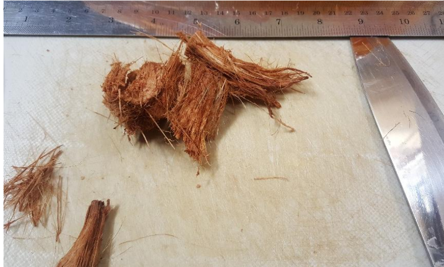
Figura 22. Proceso de extracción y seccionamiento de la fibra coco.
