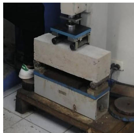
Fotografía 24. Ensayo de resistencia a la flexión del concreto.
