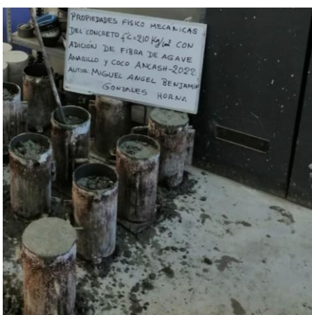
Fotografía 17. Elaboración de probetas de concreto f'c=210 \text{ kg/cm}^2 .
