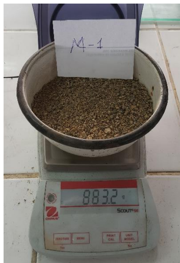
Figura 16. Ensayo de contenido de humedad de los agregados.
