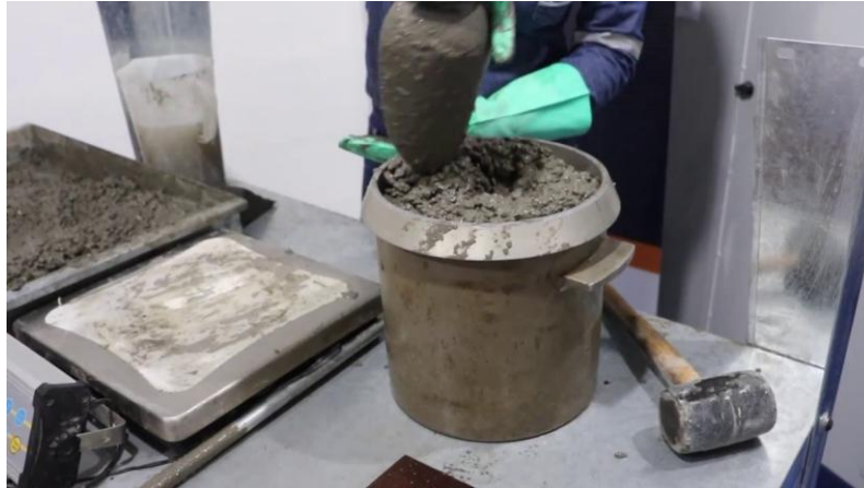
Figura 6. Ensayo de peso unitario o masa unitaria del concreto.
