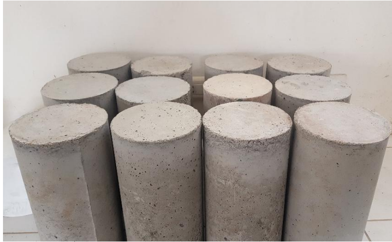
Figura 24. Elaboración de probetas de concreto f'c=210 kg/cm 2 .
