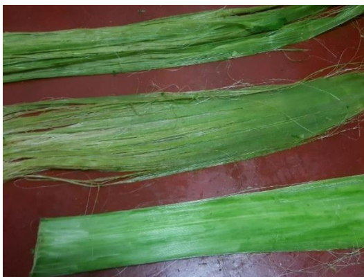
Fotografía 5. Extracción y tratamiento de la fibra de agave amarillo.
