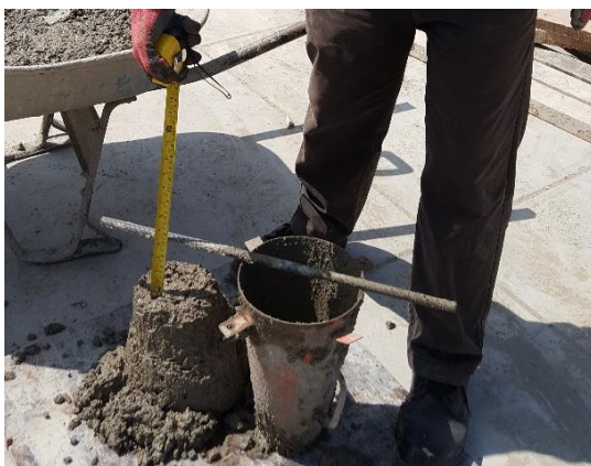
Figura 33. Ensayo de asentamiento del concreto.
