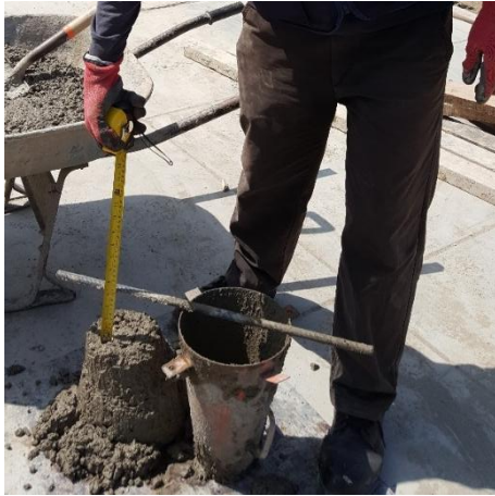
Fotografía 19. Ensayo de asentamiento del concreto f'c=210 \text{ kg/cm}^2 .
