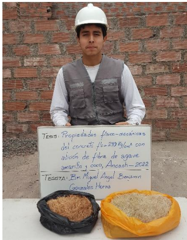
Fotografía 7. Fibras extraídas y procesadas para adicionar al concreto.
