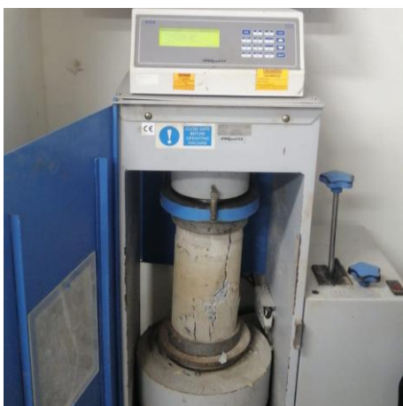
Fotografía 23. Ensayo de resistencia a la compresión del concreto.
