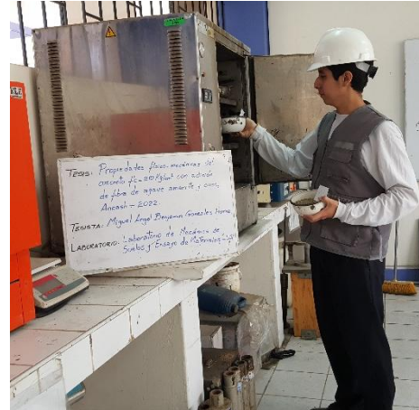
Fotografía 14. Ensayo de contenido de humedad de los agregados.
