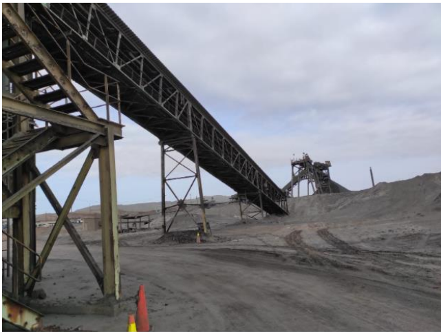
Figura 16. Envío de crudos a través de faja transportadora.
