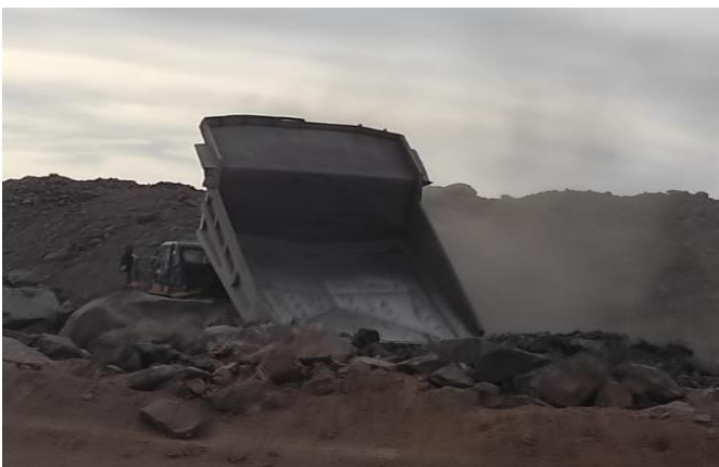
Figura 15. Descarga de materia prima en chancadora primaria.
