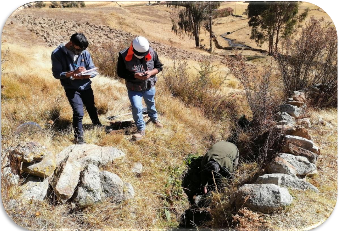
Foto N.4: realización del método volumétrico aforó caudal en la captación
