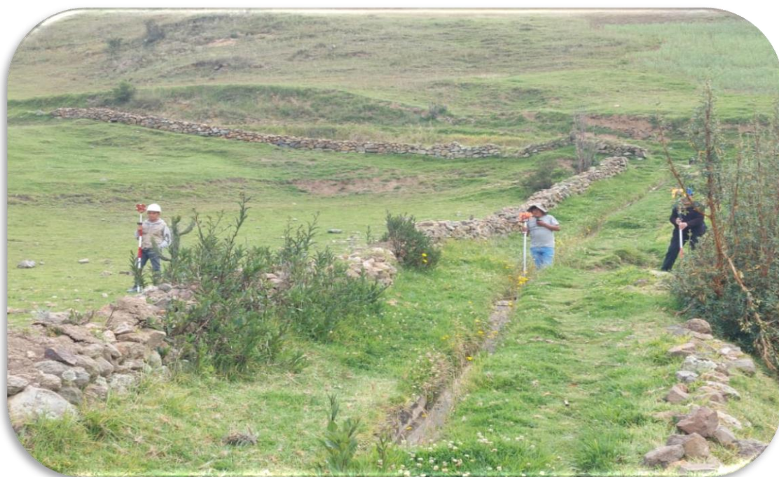
Foto N.1: ubicación y nivelación de la estación total en un punto estratégico
