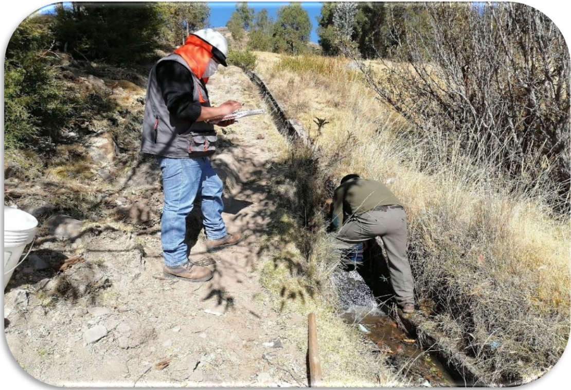
Foto N.5: obtención de datos de aforo de agua en la línea de conducción.
