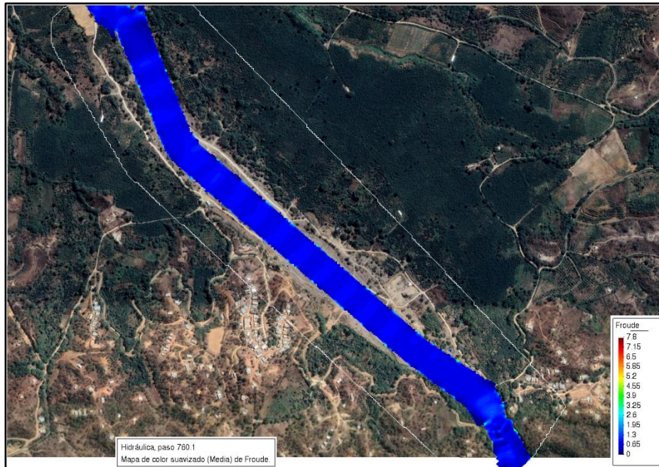
Imagen 23. Froude en quebrada Cabuyal con diseño en Iber.
