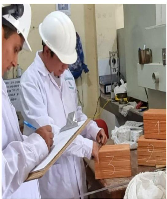
**Fotografía N° 28 y 29:** Se realizó el pesado de las muestras de los ladrillos de arcilla con las diferentes porcentajes de la CCA, en las balanzas calibradas del laboratorio LM Ceconse EIRL.
