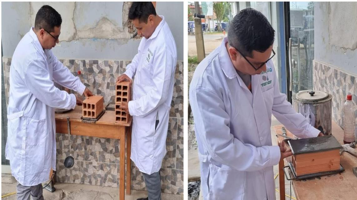
**Fotografía N° 32; 33 y 34:** Se realizó la compresión axial de 20 und. de ladrillos, 5 und por porcentaje de investigación al 15; 20 y 25% de CCA, más la muestra patrón, como podemos observar en las imágenes.
