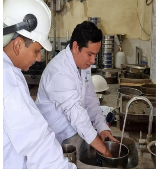
**Fotografía N° 22 y 23:** Se realizo el proceso de tamizado y pesado de la muestra de ladrillo de arcilla, para determinar la granulometría.
