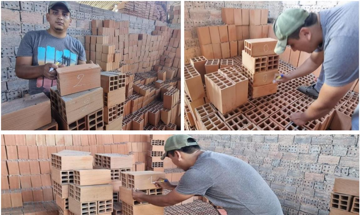
**Fotografía N° 17:** Se realizó el ensayo para determinar la humedad con la que se realizan los ladrillos de arcilla en la ladrillera Montalván, como se observa estamos ingresando el material al horno por 24 horas, y para realizar los diferentes ensayos de granulometría y límites de atterberg.
