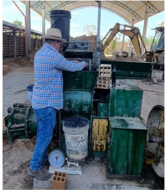
**Fotografía N° 09 y 10:** Proceso del diseño de mezcla de la arcilla con la adición de la CCA en los diferentes porcentajes de la investigación 15%; 20% y 25%, para la elaboración de los ladrillos de arcilla.
