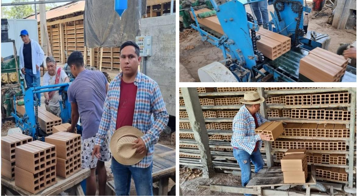
**Fotografía N° 14; 15 y 16:** Selección de los ladrillos de arcilla con la adición de la CCA al 15; 20 y 25%, después del proceso de cocido y poniendo la marcación correspondiente.
