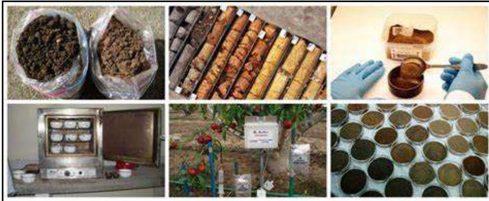
*Figura 2. Métodos de medición de Contenido humedad del suelo*
