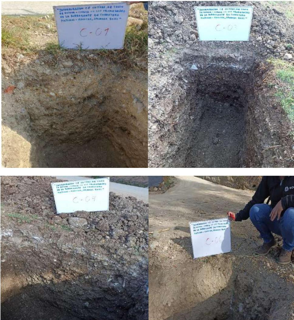
Figura 10. Calicatas en situ C-01, C-03, C-04 y C-06
