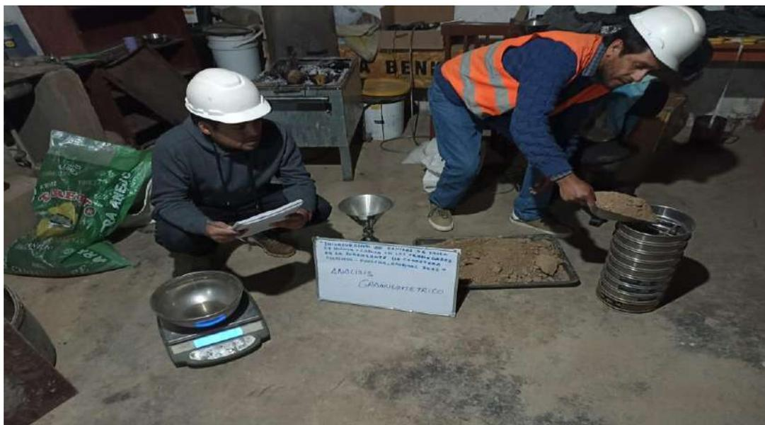
Figura 13: Análisis granulométrico
