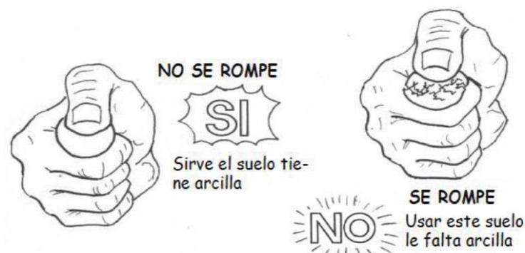
**Figura 4.**Prueba de resistencia seca .
