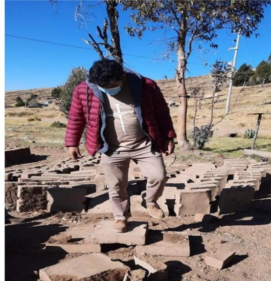
**Figura 5.** Prueba de resistencia – Carga de un adulto.
