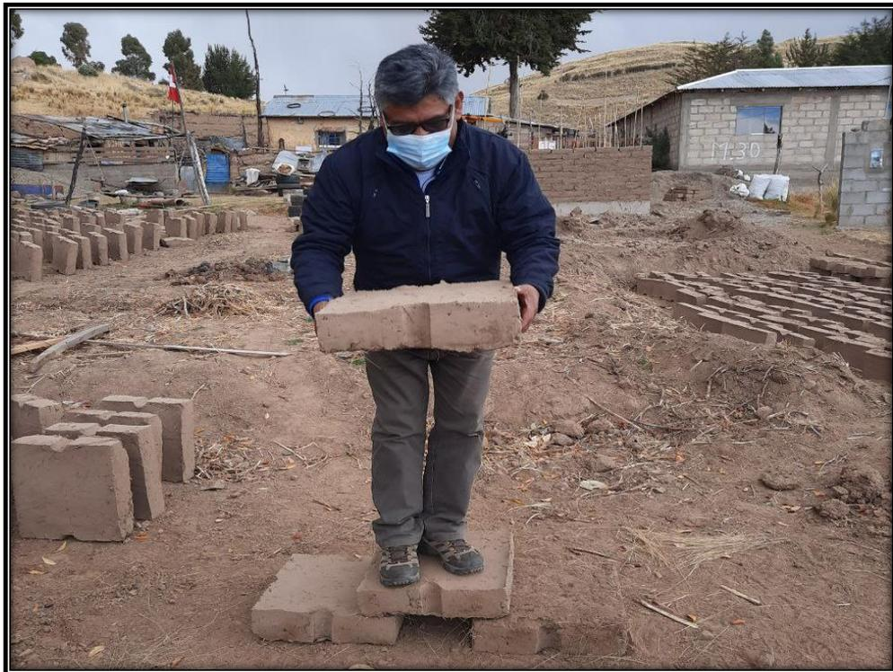
**Fotografía 12: Prueba de Resistencia e Impacto**
