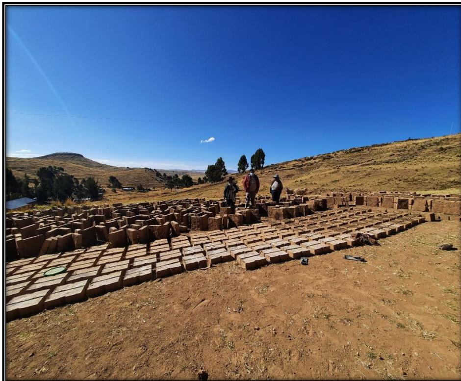
**Fotografía 8:** bloques de adobe moldeado y secado
