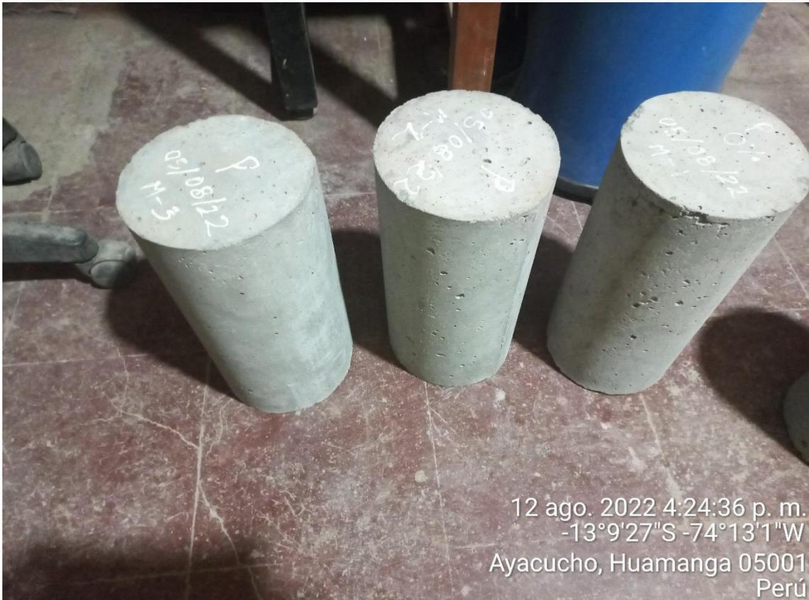
13. Testigos cilíndricos de concreto.
