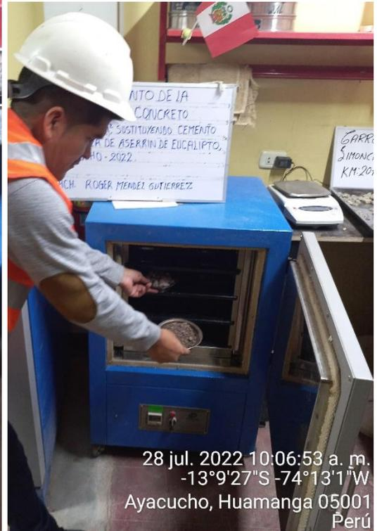
9. Determinación del peso específico y absorción del agregado grueso.
