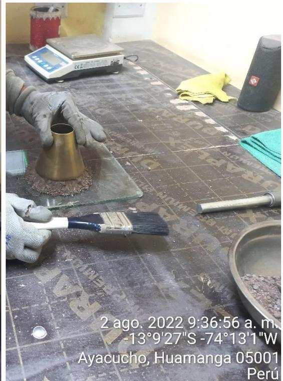
10. Determinación del peso específico y absorción del agregado fino.
