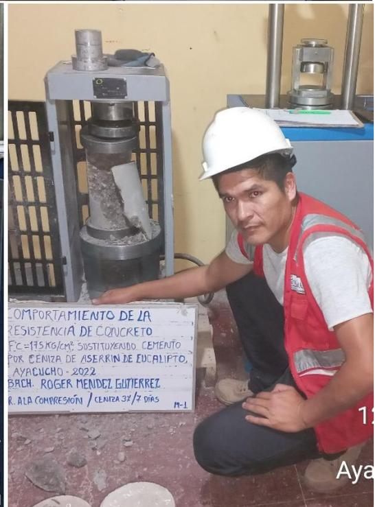
14. ensayo de resistencia a la compresión del concreto.
