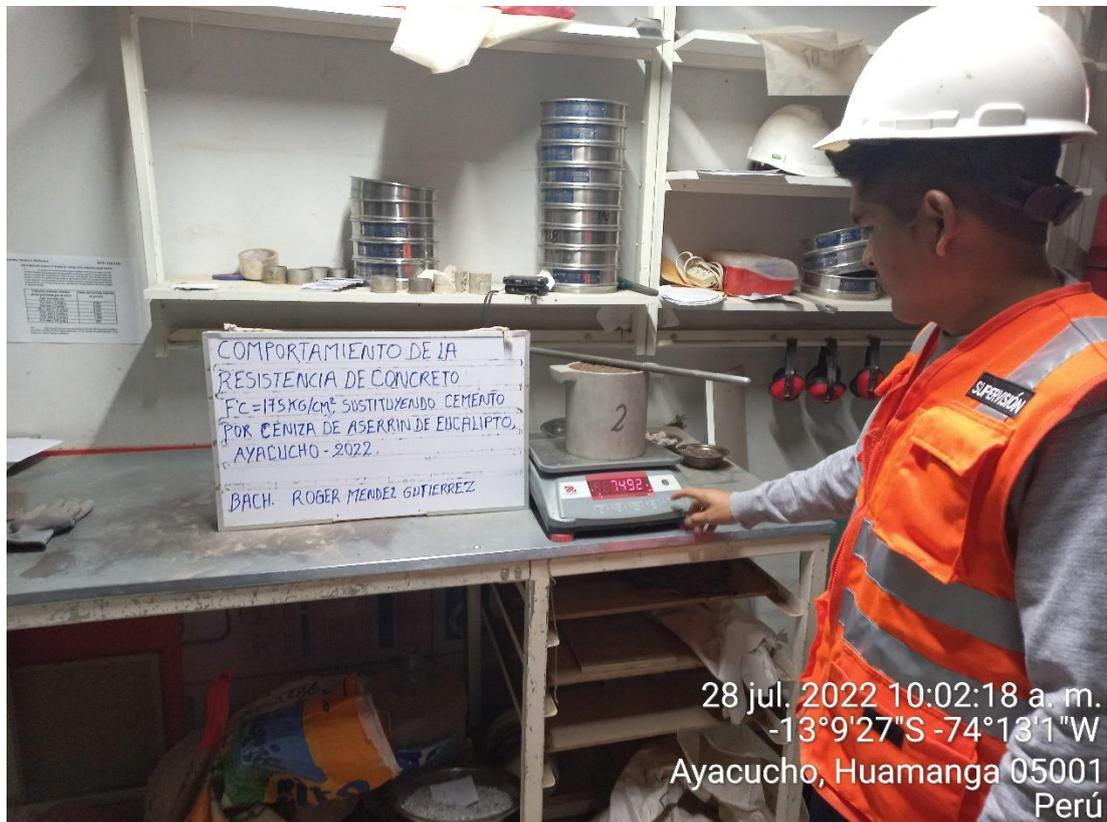
8. Determinación del PUSS Y PUCS del agregado fino.
