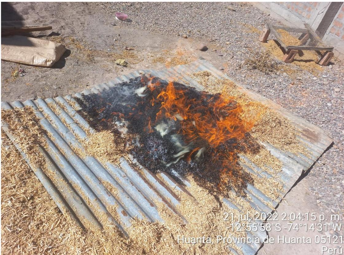
2. Pre quemado del aserrín de eucalipto.
