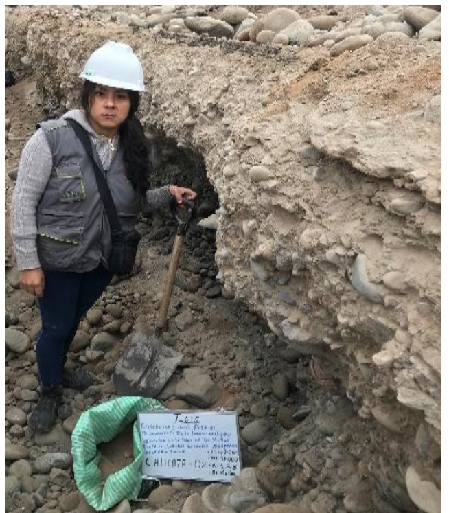
Foto 24: Se observa la extracción de material en la calicata 02.
