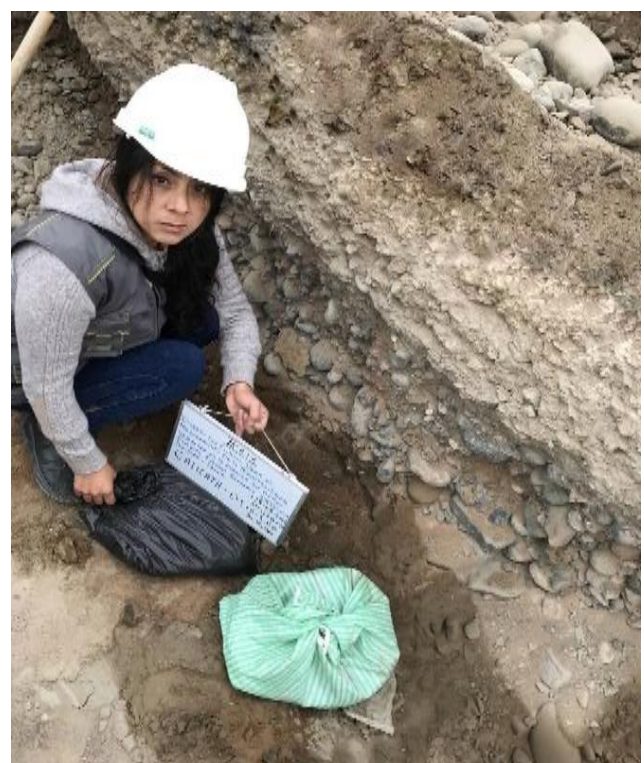
Foto 20: Se observa la extracción de la muestra de la C-01.
