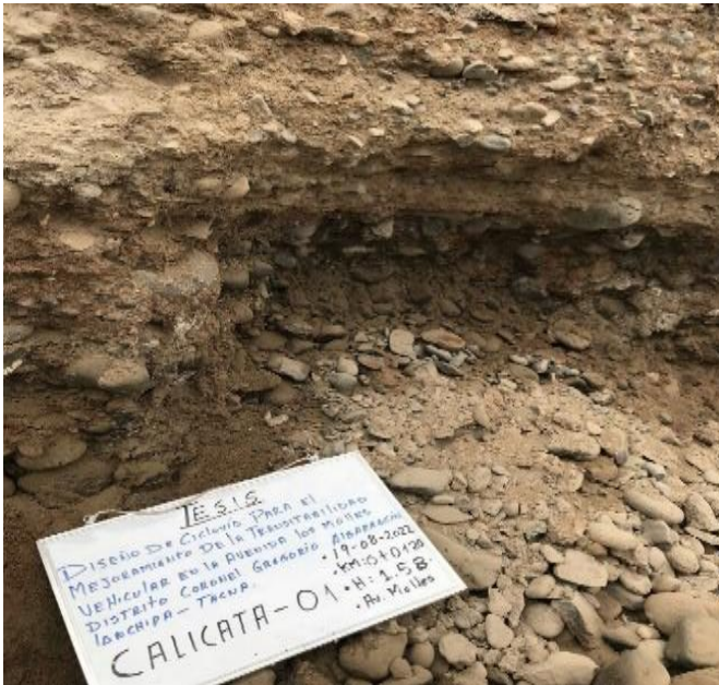
Foto 17: Observamos la zanja realizada para calicata 01 en el corte se aprecia la estratigrafía del terreno.
