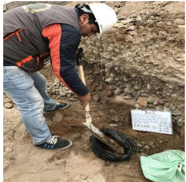
Foto 18: Se observa la extracción de la muestra que se utilizara en el estudio de mecánica de
