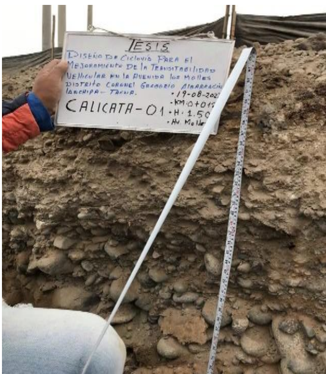
Foto 19: Observamos la estratificación de la calicata 01 ubicada en el km 0+120.
