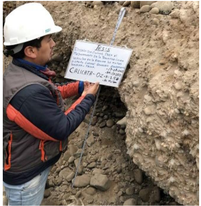
Foto 22: Se observa la estratificación de la calicata 02 ubicada en el km 1+000.suelos.
