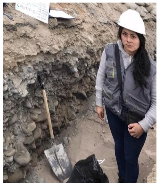
Foto 28: Observamos la extracción de material para los estudios de mecánica de suelos.
