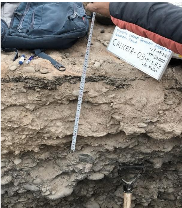
Foto 27: Observamos la estratificación de la calicata 03.
