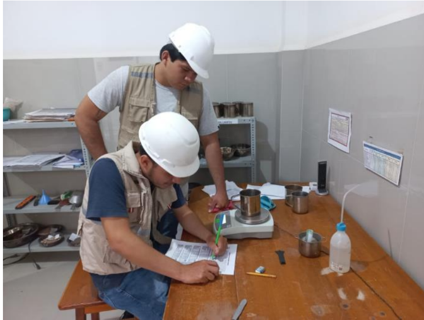
Foto N° 7: Ensayo del porcentaje de humedad natural.
