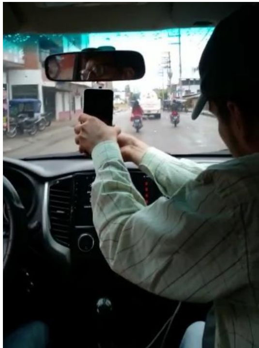
Foto N° 19: Fijación del dispositivo móvil en el brazo sujetador adherido en el parabrisas delantero.
