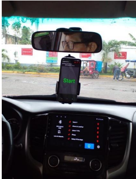
Foto N° 20: Dispositivo listo para la recolección de datos del Km. 625+000 hasta el 629+000 de la carretera.
