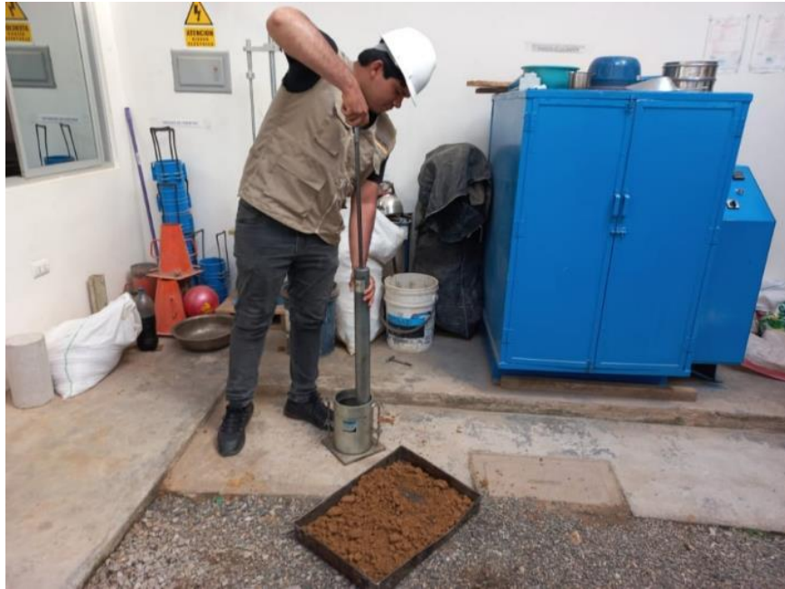
Foto N° 11: Ensayo de proctor modificado.
