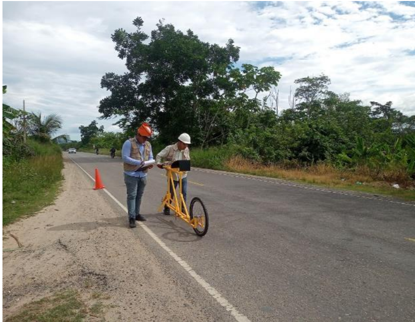
Foto N° 17: Toma de datos con el rugosímetro de Merlín en el carril izquierdo, de regreso desde el Km. 629+000 hasta 625+000.
