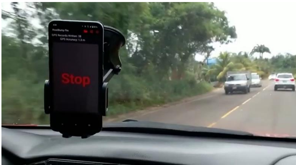
Foto N° 21: Dispositivo en acción registrando las escrituras encontradas en la carretera.
