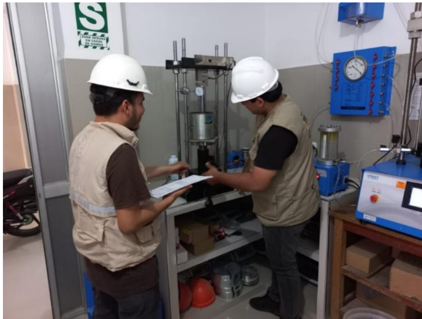
Foto N°12: Ensayo de California Bearing Ratio – CBR.
