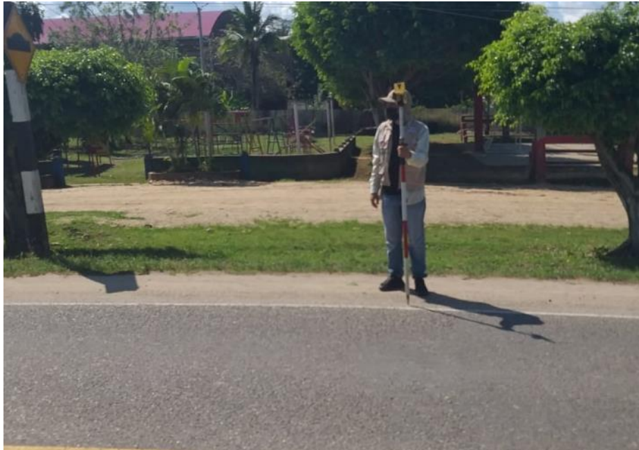
Foto N° 3: Ubicación del prisma en punto de la carretera para la toma de datos.
