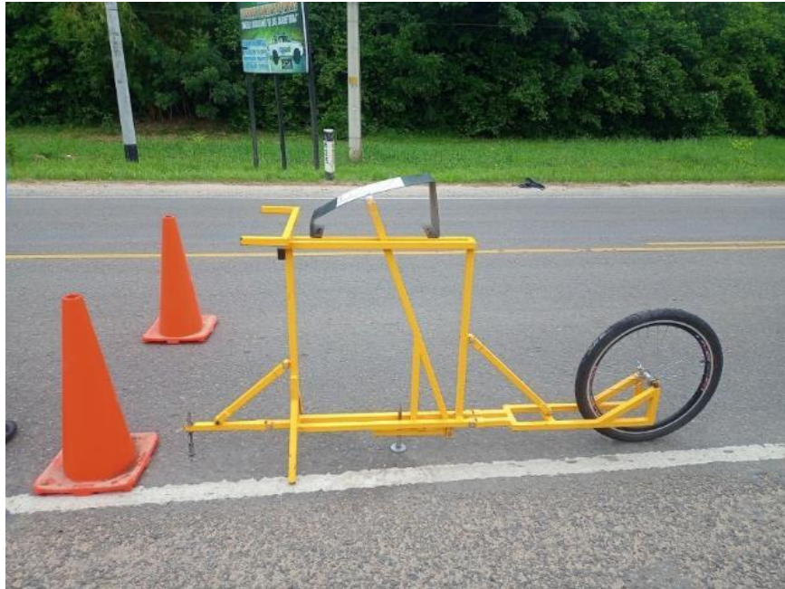
Foto N° 15: Rugosímetro listo para la toma de datos.
