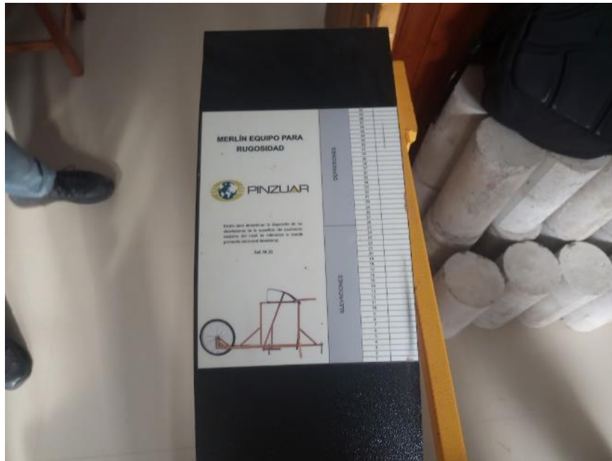
Foto N° 13: Escala de medición del instrumento dividido en elevaciones y depresiones.
