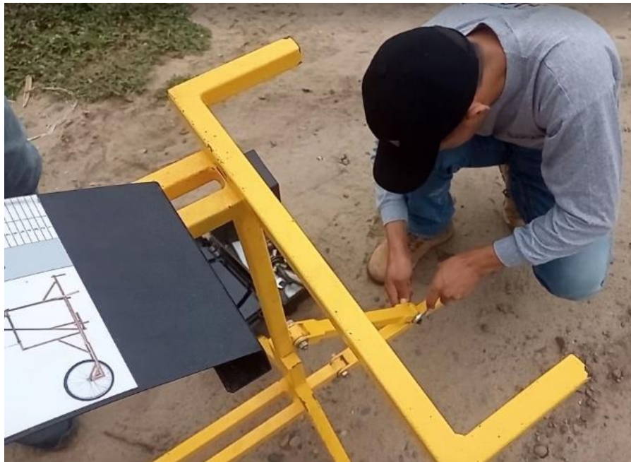
Foto N° 14: Armado del instrumento Merlín en campo.
