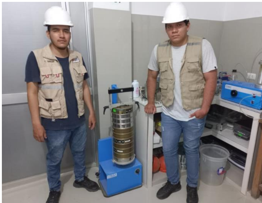
Foto N° 8: Ensayo de análisis granulométrico por tamizado.
