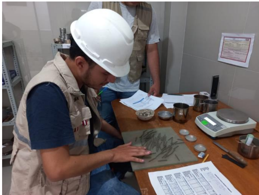
Foto N° 10: Ensayo de limite plástico.
