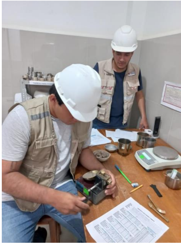
Foto N° 9: Ensayo de limite líquido.
