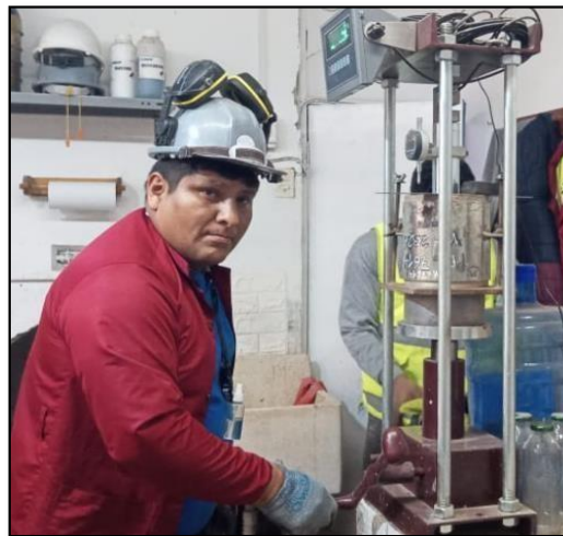
Figura 16. Prueba de penetración (CBR)
