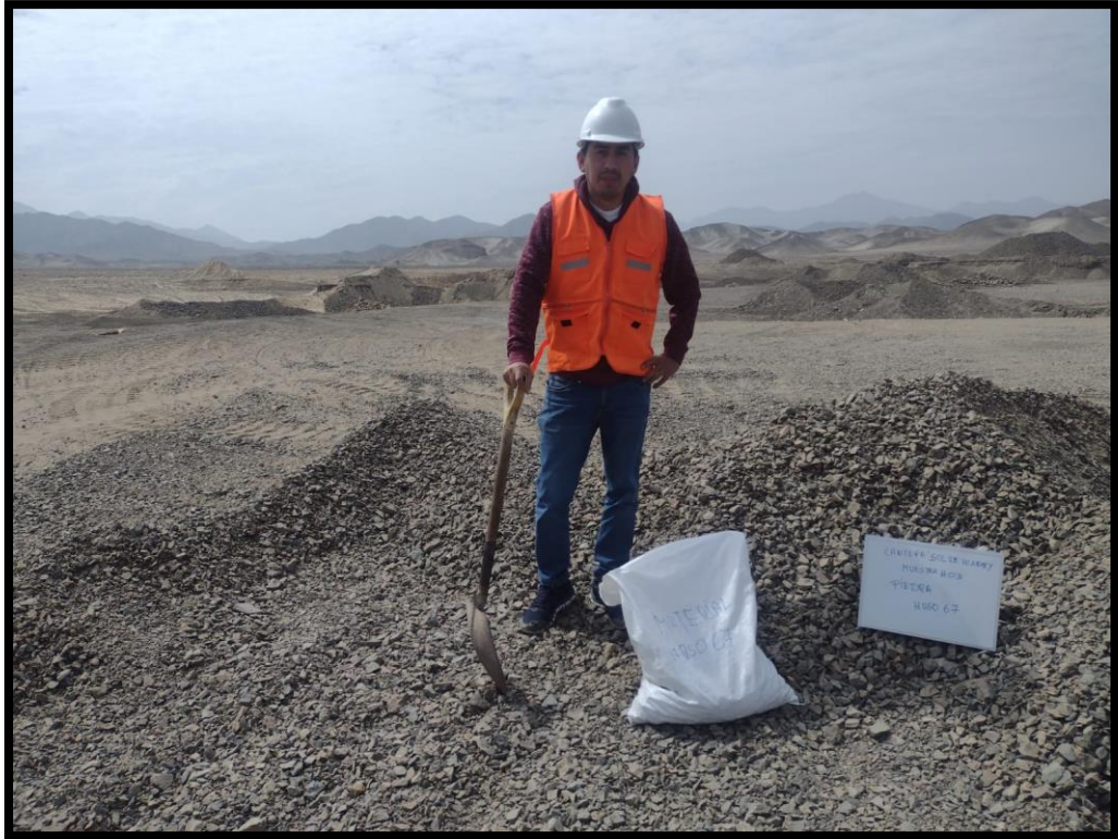
Fotografía 05 : Toma de muestra material Huso 67:
