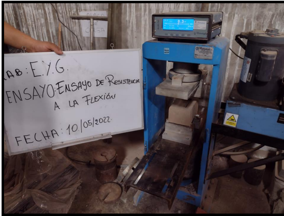
Fotografía 12: Ensayo de Resistencia a la Flexión:
