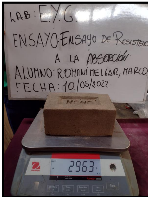
Fotografía 09 : Ensayo de absorción, peso muestra seca:
