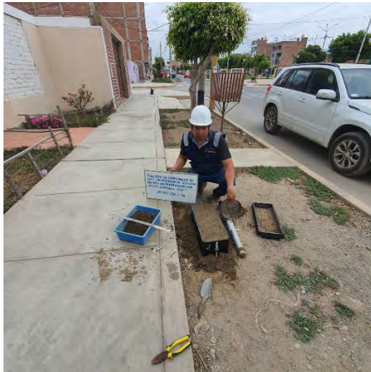
Fotografía N°39-40: Evidencia de realización de ensayos de CBR con molde 20x50 para la calicata C3.
