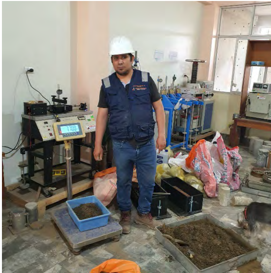
Fotografía N°33-34: Evidencia del pesado del material dividido en 5 partes del total para los ensayos de CBR con molde 20x50.
