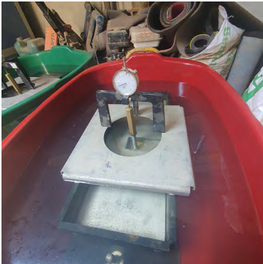
Fotografía N°43-44: Evidencia de realización inmersión y colocación de placa para medición de expansión de ensayos de CBR con molde 20x50.
