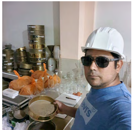
Fotografía N°15-16: Evidencia de tamizado para separar el material para los ensayos de límite líquido, límite de plástico.
