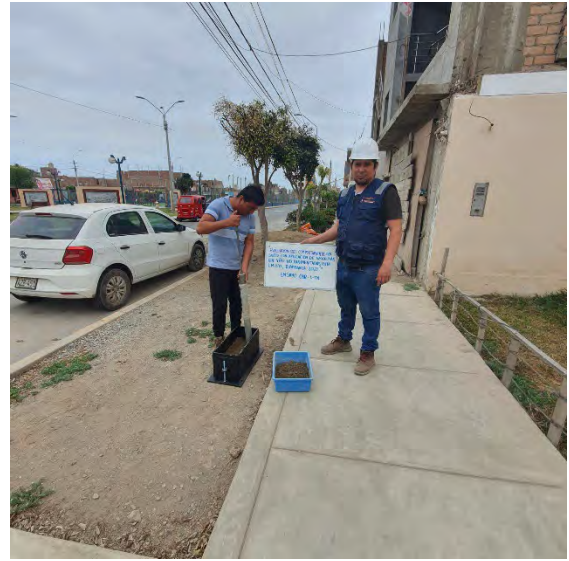
Fotografía N°33-34: Evidencia del pesado del material dividido en 5 partes del total para los ensayos de CBR con molde 20x50.
