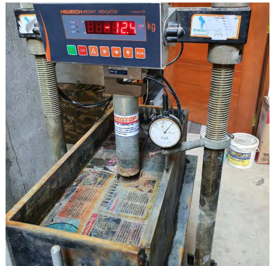
Fotografía N°67-68: Evidencia de realización de ensayo con equipo de prensa de CBR, con geocelda.
