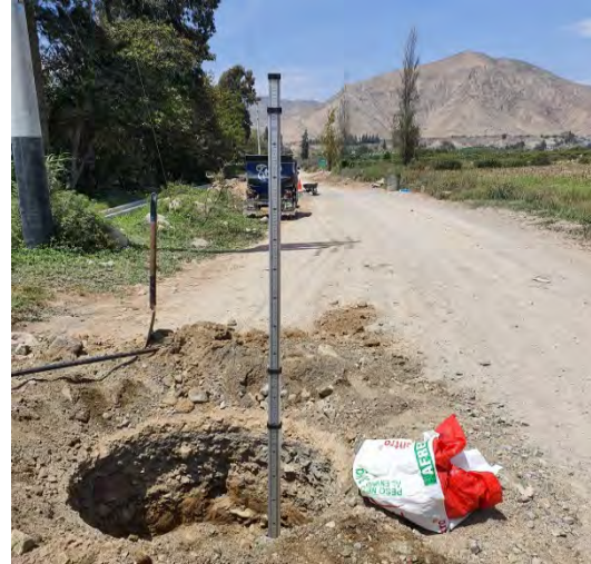
Fotografía N°01-02: Evidencia de la extracción de las muestras de la Calicata 02 – C2.
