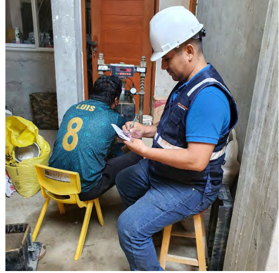
Fotografía N°65-66: Evidencia de realización de ensayo con equipo de prensa de CBR, con geocelda.
