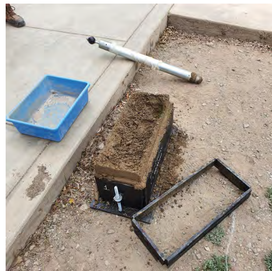
Fotografía N°35-36: Evidencia de realización de ensayos de CBR con molde 20x50 para la calicata C1.
