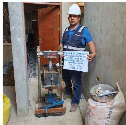
Fotografía N°55-56: Evidencia de preparación de equipo de ensayos de CBR con molde 20x50.
