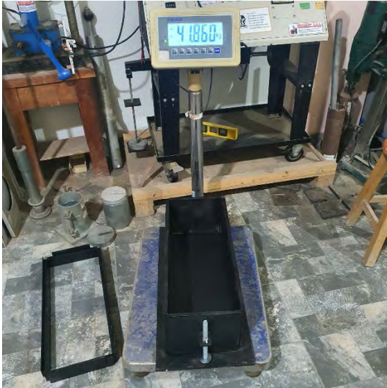
Fotografía N°29-30: Evidencia del pesado de molde de CRB y del material a utilizar para el ensayo.
