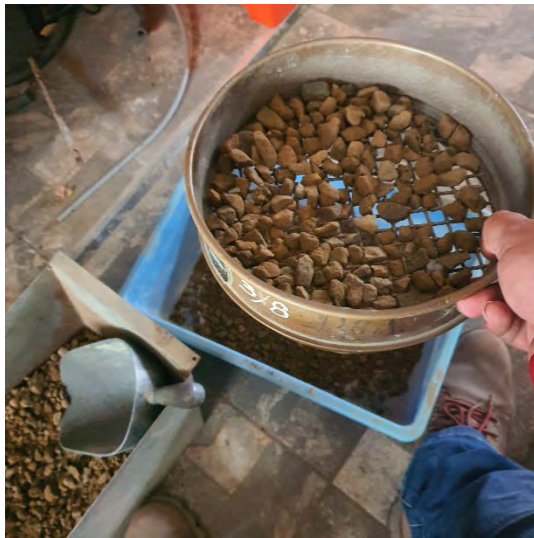
Fotografía N°11-12: Evidencia de tamizado con las diferentes mallas para la búsqueda de la gradación.
