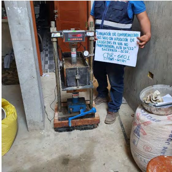
Fotografía N°69-70: Evidencia de realización de ensayo con equipo de prensa de CBR, con geocelda.
