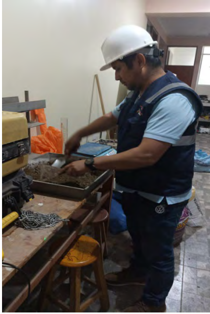
Fotografía N°25-26: Evidencia de preparación de material para Proctor con la humedad obtenida y el pesado de la muestra.
