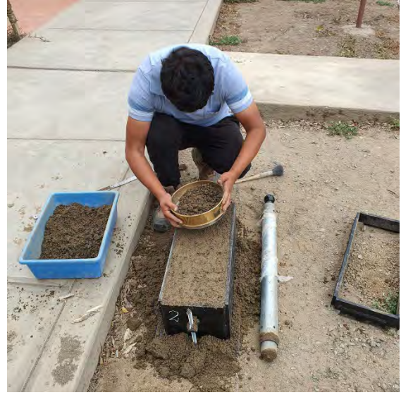
Fotografía N°37-38: Evidencia de realización de enrase de la muestra para ser pesado al nivel de la pestaña inferior del ensayo de CBR con molde 20x50.
