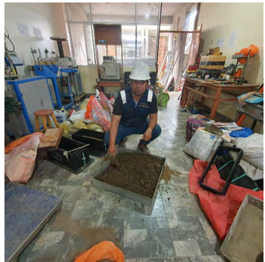
Fotografía N°31-32: Evidencia de proporción de agua y preparación de los materiales para ensayos de CBR en molde de 20x50cm.
