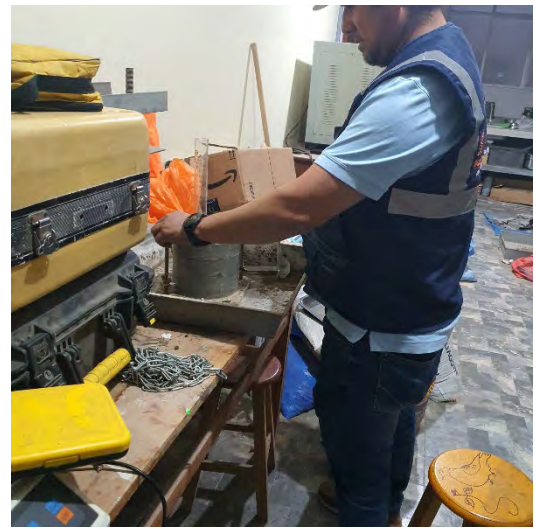
Fotografía N°23-24: Evidencia de realización de ensayos de Proctor de calicatas C1-C2-C3.
