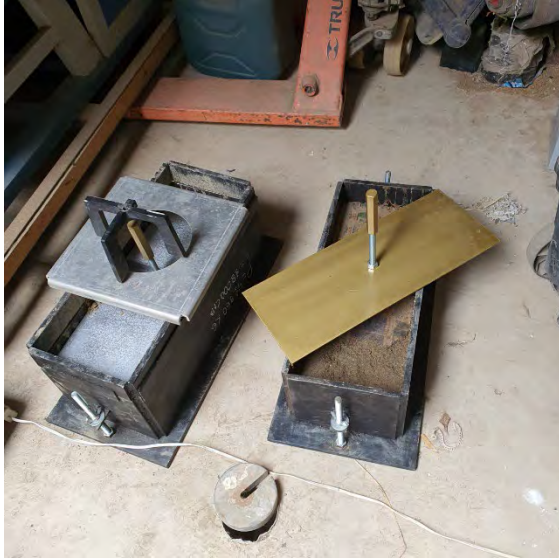
Fotografía N°41-42: Evidencia de realización de colocación de base sólida, pesa anular y pesa ranurada del ensayo de CBR con molde 20x50.
