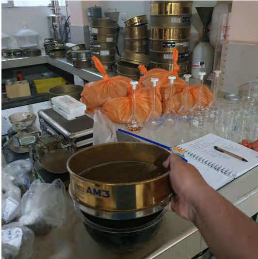
Fotografía N°15-16: Evidencia de tamizado para separar el material para los ensayos de límite líquido, límite de plástico.
