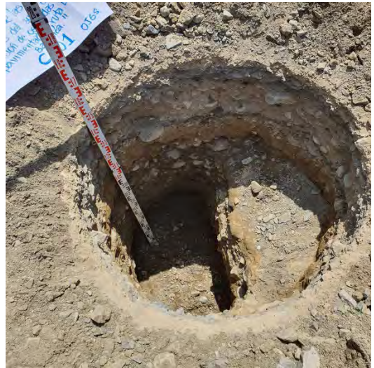
Fotografía N°07-08: Evidencia de ubicación de la extracción de las muestras de la Calicata 01 – C1.
