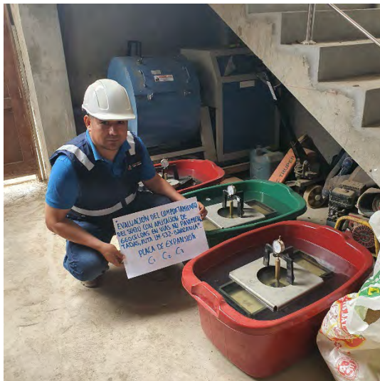
Fotografía N°47-48: Evidencia de realización de ensayo con placa de medición de expansión y de ensayos de CBR con molde 20x50. Día 4.
