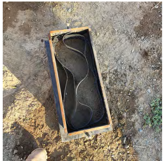
Fotografía N°59-60: Evidencia de preparación de equipo de geocelda con ensayo de CBR con molde 20x50.
