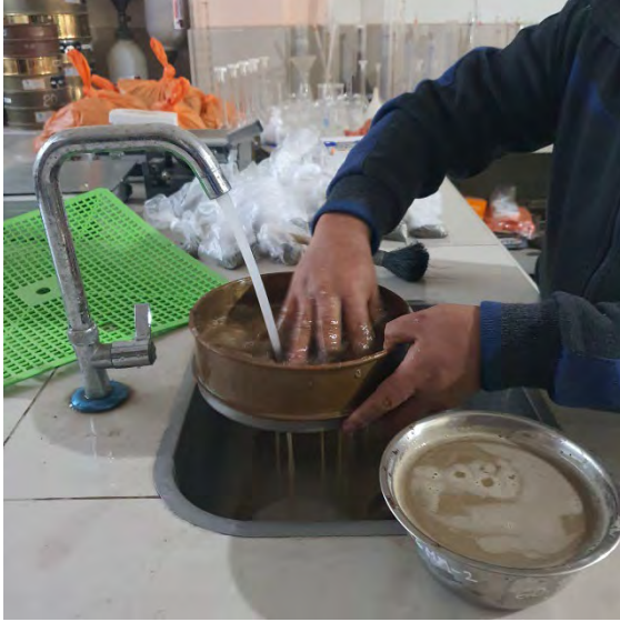
Fotografía N°21-22: Evidencia del lavado del material para los ensayos de límite líquido, límite de plástico y horno utilizado para su secado.
