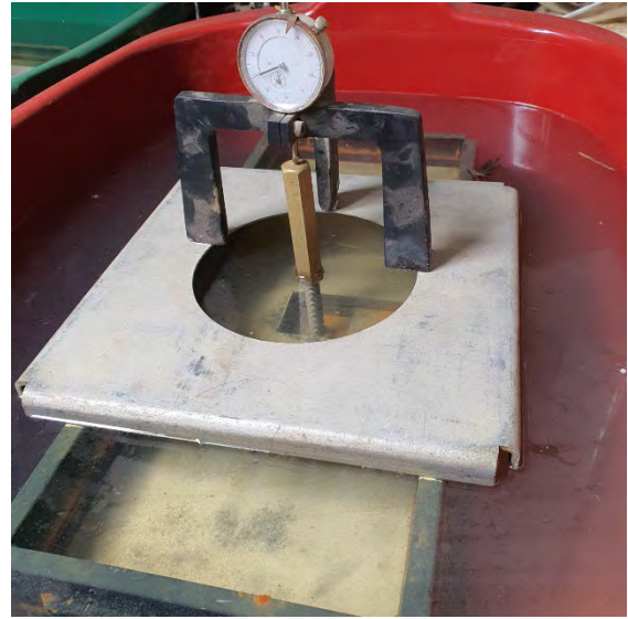
Fotografía N°45-46: Evidencia de realización de ensayo con placa para medición de expansión y del ensayo de CBR con molde 20x50 – Día 1.
