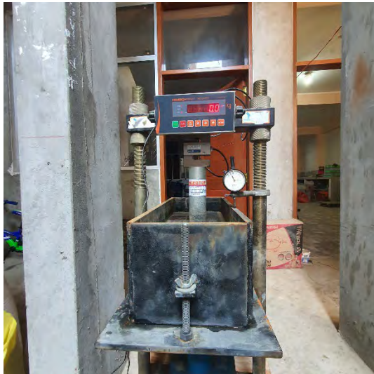
Fotografía N°55-56: Evidencia de preparación de equipo de ensayos de CBR con molde 20x50.
