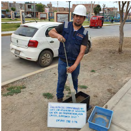
Fotografía N°35-36: Evidencia de realización de ensayos de CBR con molde 20x50 para la calicata C1.
