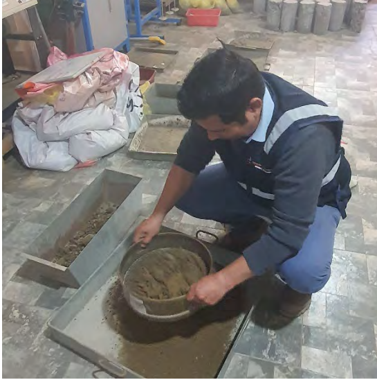
Fotografía N°09-10: Evidencia del tamizado por la malla N°3/8 para el ensayo de Proctor y CBR.
