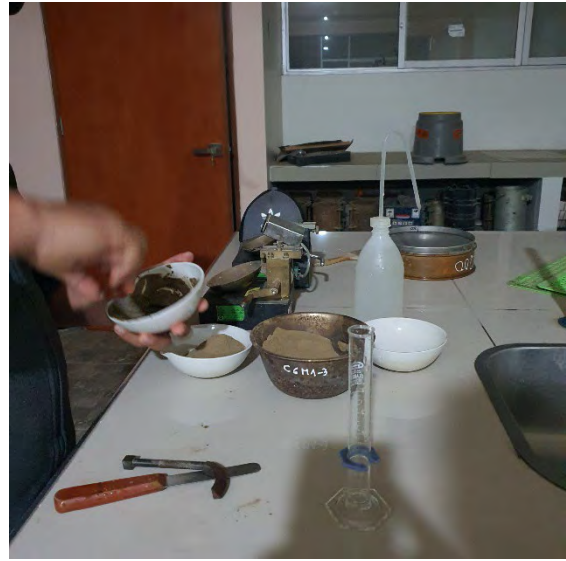
Fotografía N°17-18: Evidencia del material para los ensayos de limite líquido, límite de plástico.
