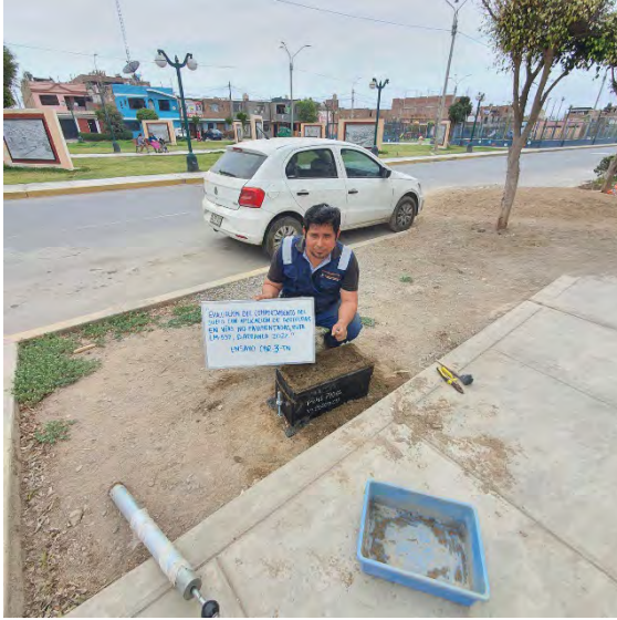
Fotografía N°61-62: Evidencia de realización compactación de moldes de CBR con geocelda.
