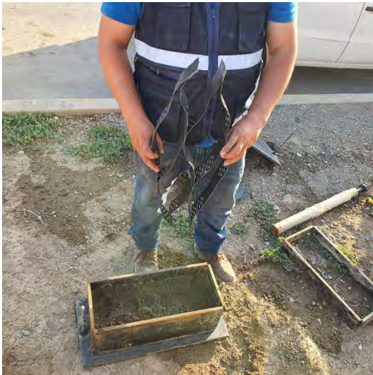
Fotografía N°59-60: Evidencia de preparación de equipo de geocelda con ensayo de CBR con molde 20x50.
