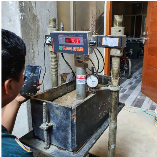
Fotografía N°67-68: Evidencia de realización de ensayo con equipo de prensa de CBR, con geocelda.
