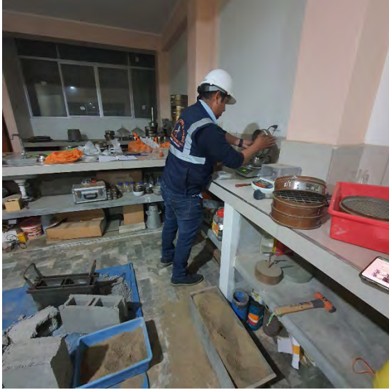
Fotografía N°13-14: Evidencia del tamizado para el ensayo de análisis granulométrico.
