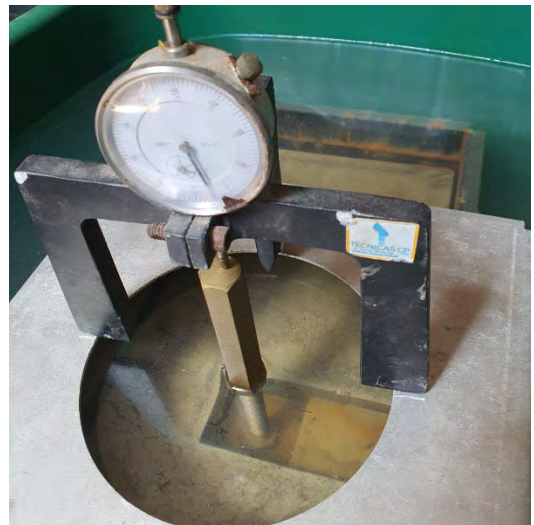
Fotografía N°47-48: Evidencia de realización de ensayo con placa de medición de expansión y de ensayos de CBR con molde 20x50. Día 4.
