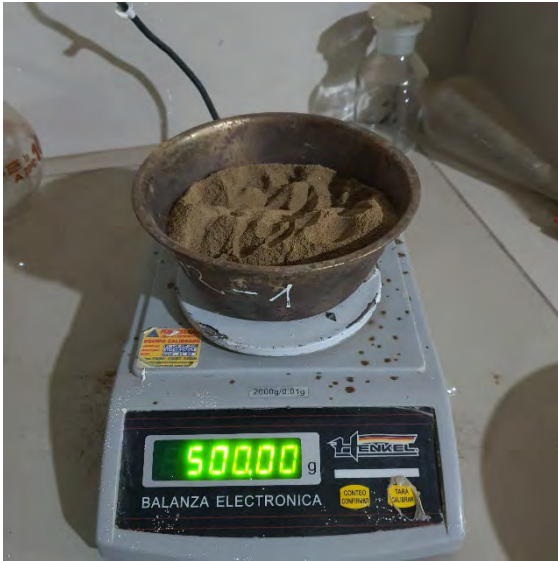
Fotografía N°17-18: Evidencia del material para los ensayos de limite líquido, límite de plástico.
