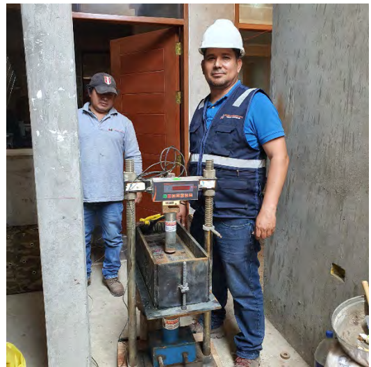
Fotografía N°51-52: Evidencia de preparación de equipo de ensayos de CBR con molde 20x50.
