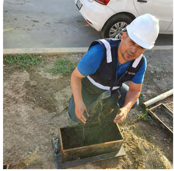
Fotografía N°61-62: Evidencia de realización compactación de moldes de CBR con geocelda.
