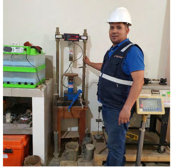
Fotografía N°49-50: Evidencia de realización de escurrir y preparación del equipo de prensa de CBR.
