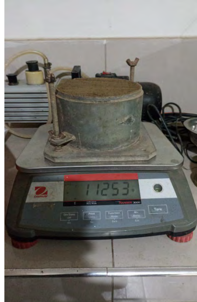
Fotografía N°25-26: Evidencia de preparación de material para Proctor con la humedad obtenida y el pesado de la muestra.
