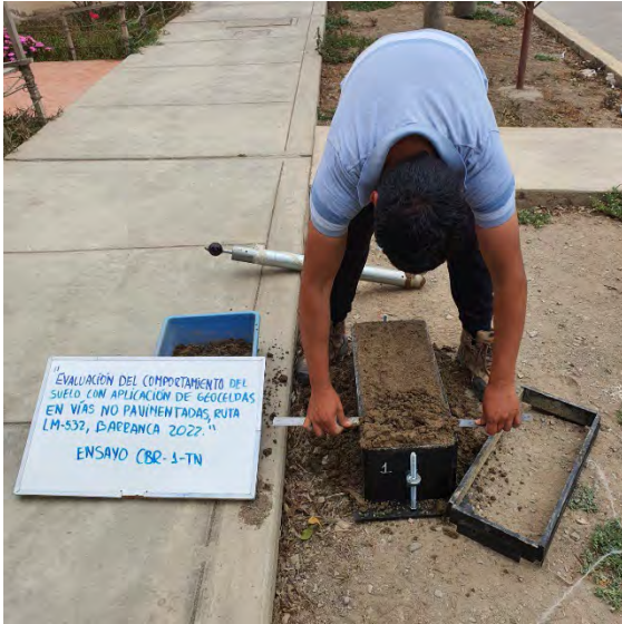
Fotografía N°37-38: Evidencia de realización de enrase de la muestra para ser pesado al nivel de la pestaña inferior del ensayo de CBR con molde 20x50.
