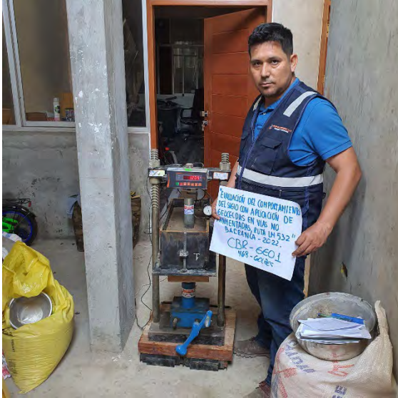
Fotografía N°65-66: Evidencia de realización de ensayo con equipo de prensa de CBR, con geocelda.
