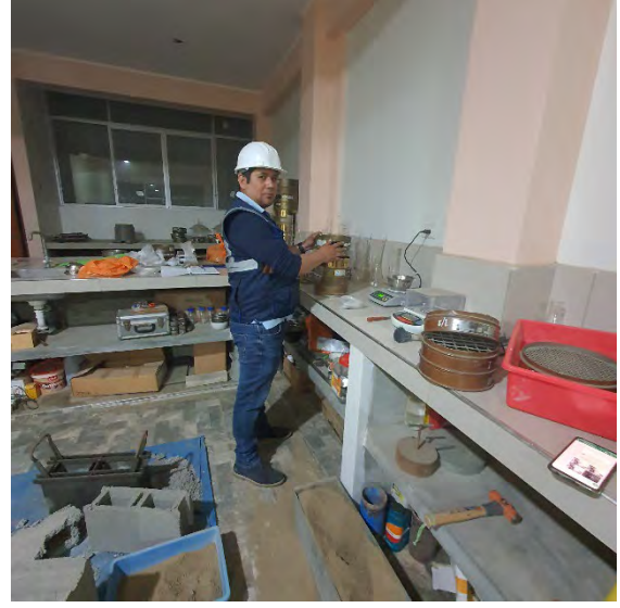
Fotografía N°13-14: Evidencia del tamizado para el ensayo de análisis granulométrico.
