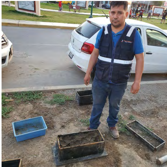
Fotografía N°63-64: Evidencia de realización de inmersión molde 20x50 con geocelda.
