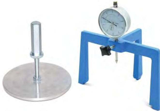
Figura 1. Placa para medir expansión de la muestra saturada
