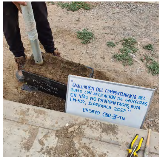
Fotografía N°39-40: Evidencia de realización de ensayos de CBR con molde 20x50 para la calicata C3.
