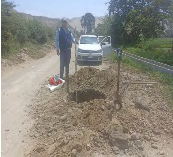
Fotografía N°01-02: Evidencia de la extracción de las muestras de la Calicata 02 – C2.
