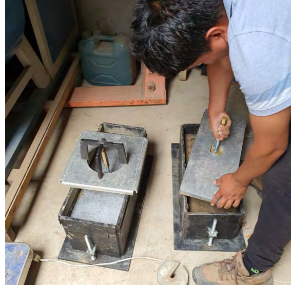
Fotografía N°41-42: Evidencia de realización de colocación de base sólida, pesa anular y pesa ranurada del ensayo de CBR con molde 20x50.
