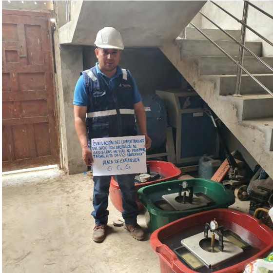
Fotografía N°45-46: Evidencia de realización de ensayo con placa para medición de expansión y del ensayo de CBR con molde 20x50 – Día 1.
