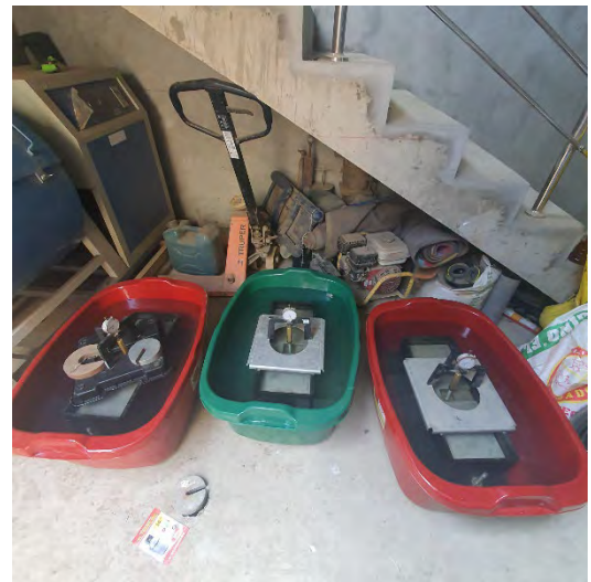
Fotografía N°63-64: Evidencia de realización de inmersión molde 20x50 con geocelda.
