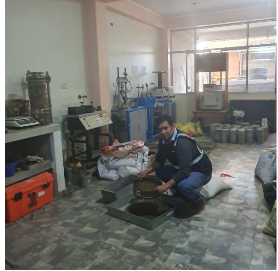
Fotografía N°09-10: Evidencia del tamizado por la malla N°3/8 para el ensayo de Proctor y CBR.
