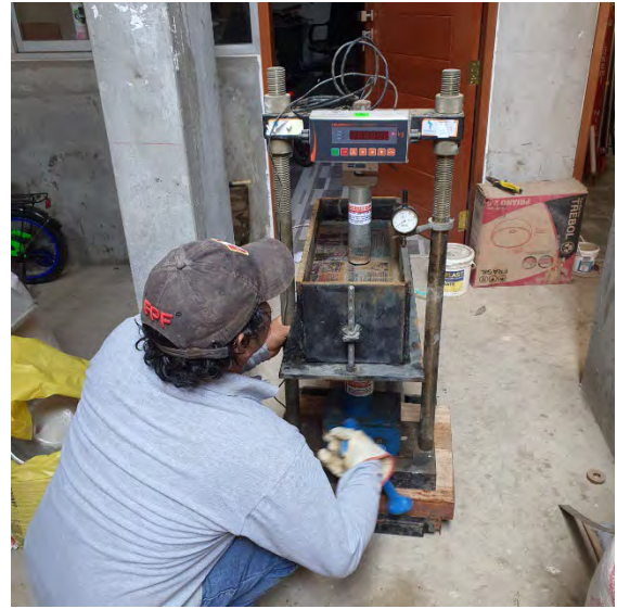
Fotografía N°53-54: Evidencia de realización de escurrir y preparación del equipo de prensa de CBR.
