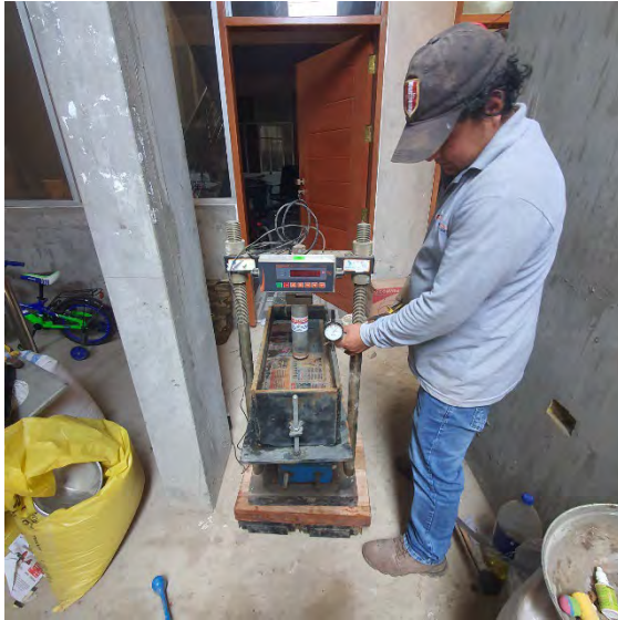
Fotografía N°53-54: Evidencia de realización de escurrir y preparación del equipo de prensa de CBR.
