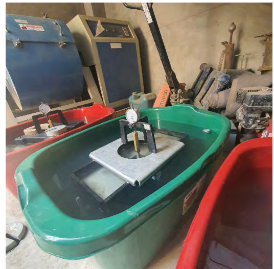
Fotografía N°43-44: Evidencia de realización inmersión y colocación de placa para medición de expansión de ensayos de CBR con molde 20x50.
