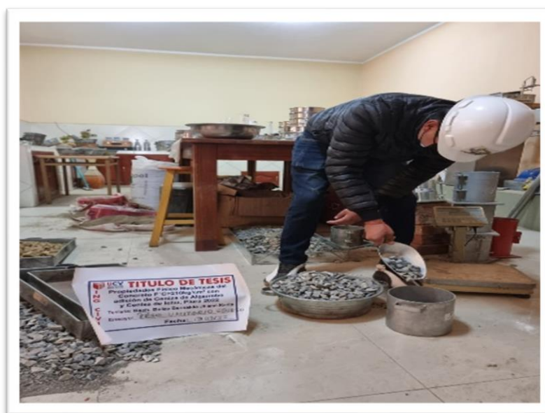
Figura 22. Peso unitario del agregado grueso
