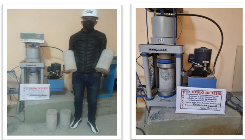
Figura 34. Ensayo de resistencia a compresión a los 28 días
