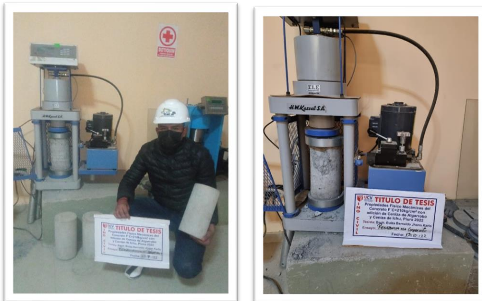
Figura 32. Ensayo de resistencia a compresión a los 14 días
