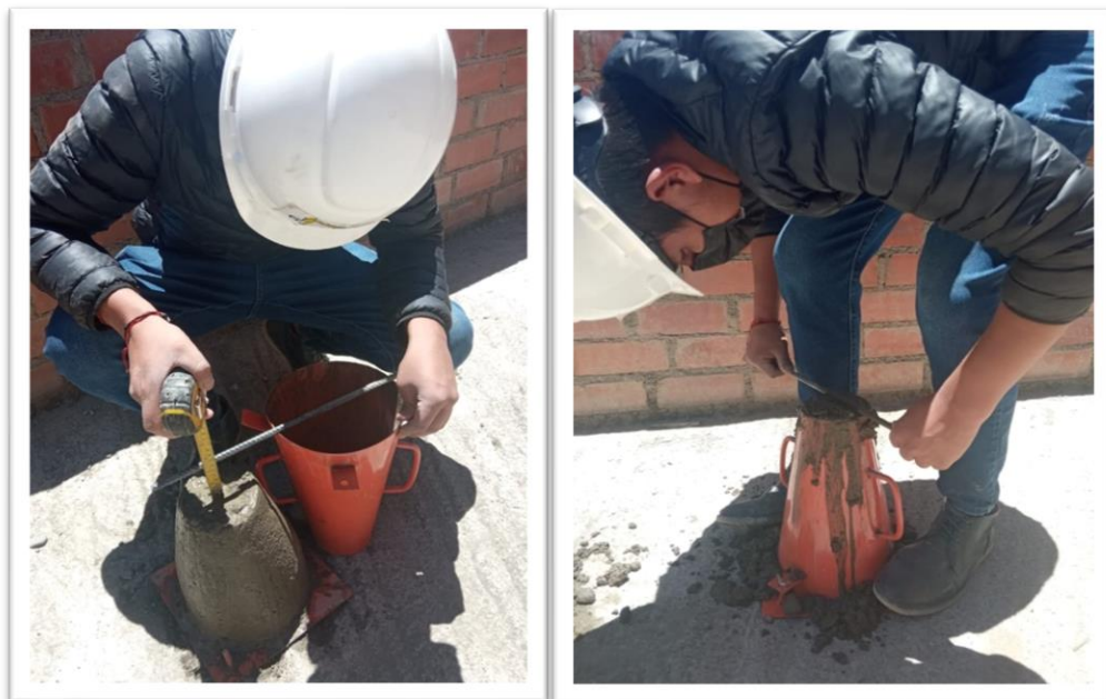
Figura 25. Prueba de asentamiento
