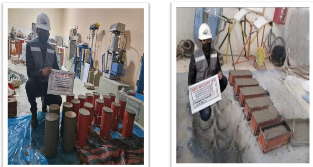
Figura 13. Elaboración de briquetas y vigas
