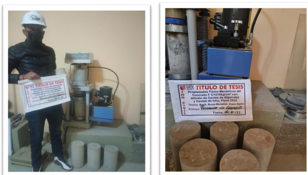
Figura 30. Ensayo de resistencia a compresión a los 7 días
