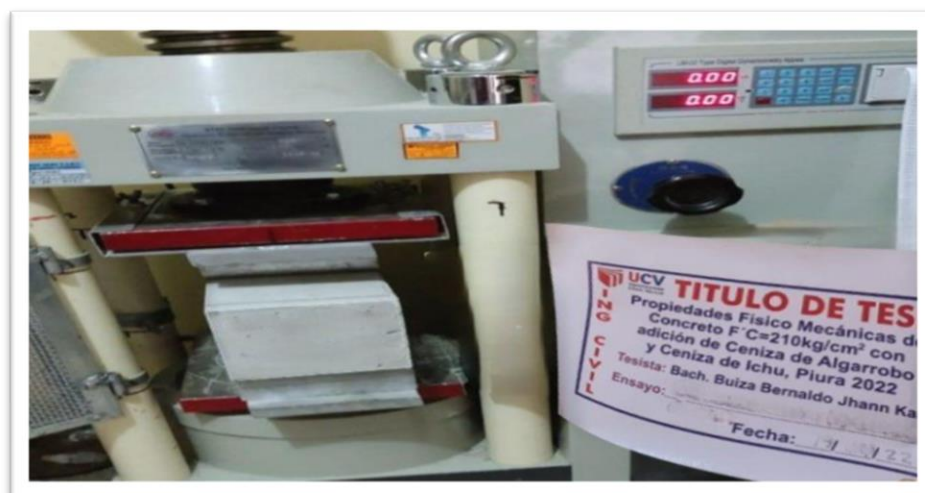
Figura 41. Ensayo de resistencia a la flexión a los 28 días
