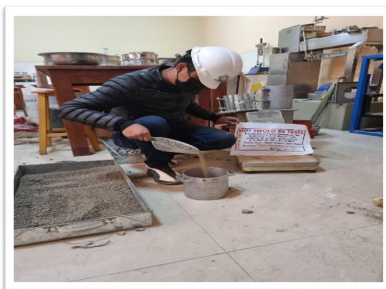
Figura 23. Peso unitario del agregado fino
