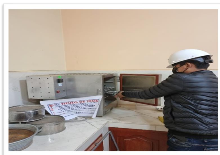
Figura 20. Contenido de humedad agregado grueso
