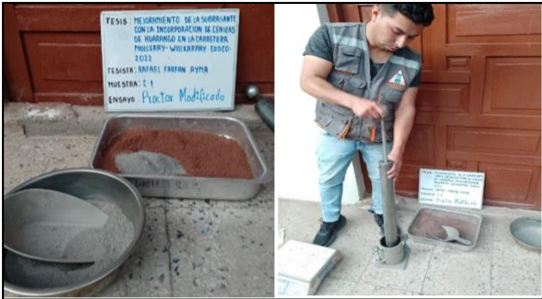
Figura 26: Adición de ceniza de Huarango según la dosificación que se tiene y realiza Ensayo de Proctor Modificado calicata 1
