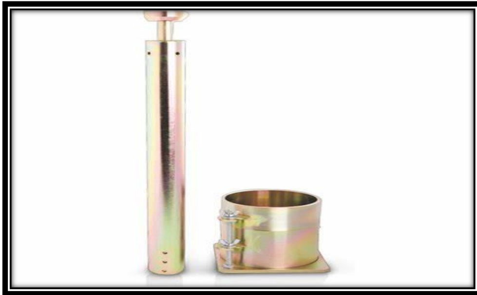
Figura 9. Equipo y herramienta para Ensayo Proctor
