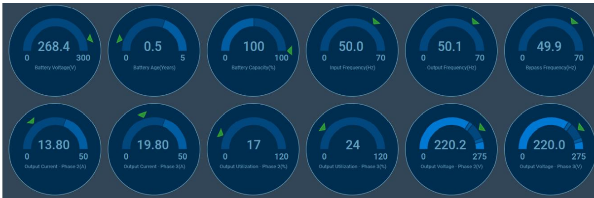
Fuente: Monitoreo de estado de la batería, tiempo de vida, capacidad de la batería, frecuencia de entrada y salida y voltaje.
