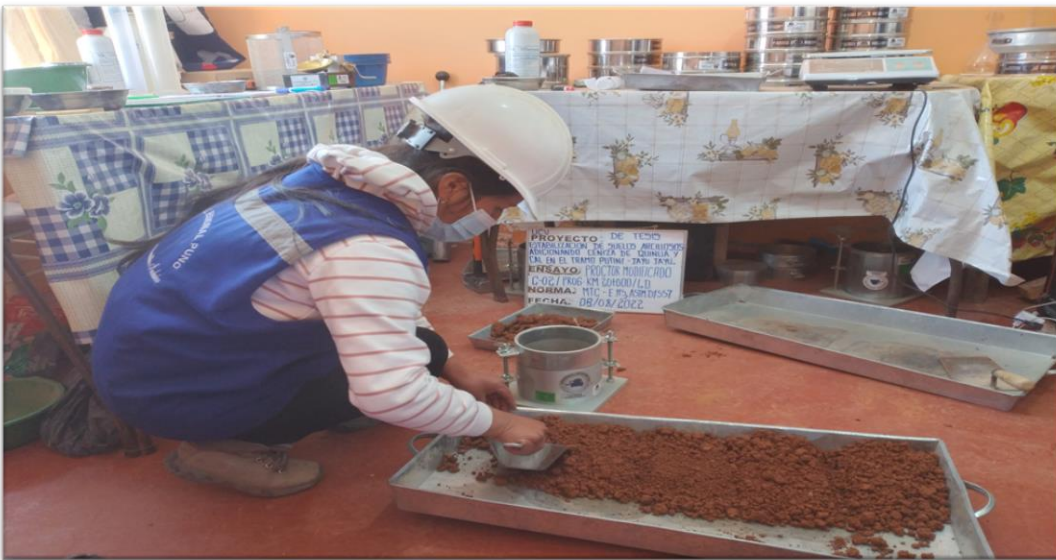
Fotografía 09: Preparación y cuarteo de la muestra para realizar el ensayo de Proctor Modificado.
