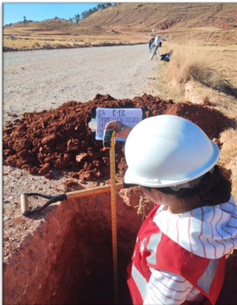
Fotografía 03: Extracción de las muestras de la C - 02 progresiva Km. 20 +000 margen derecho.
