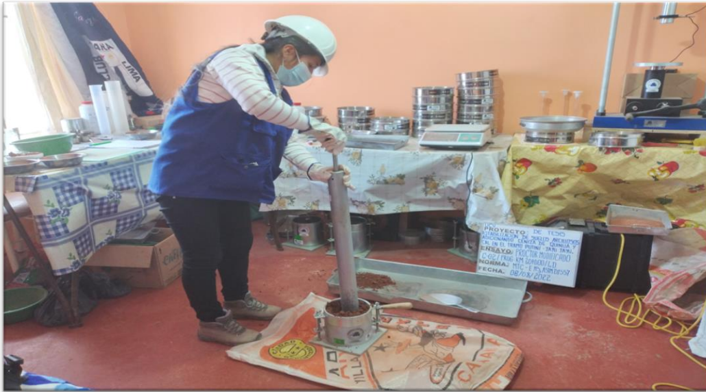
Fotografía 10: Ensayo de Proctor Modificado, compactación de la muestra a 56 golpes cada capa.
