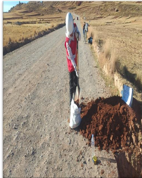
Fotografía 03: Extracción de las muestras de la C - 02 progresiva Km. 20 +000 margen derecho.
