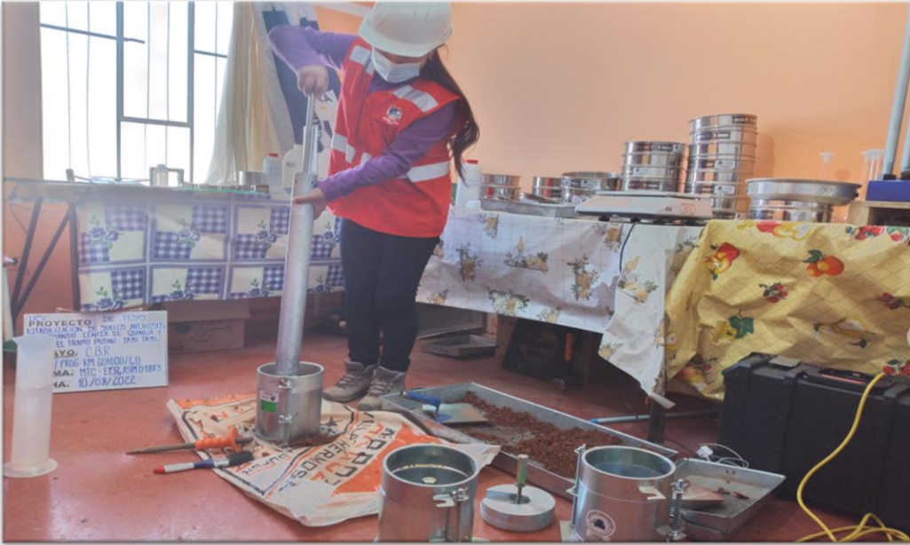
Fotografía 14: Compactación de la muestra en el molde con el martillo para el ensayo de CBR.
