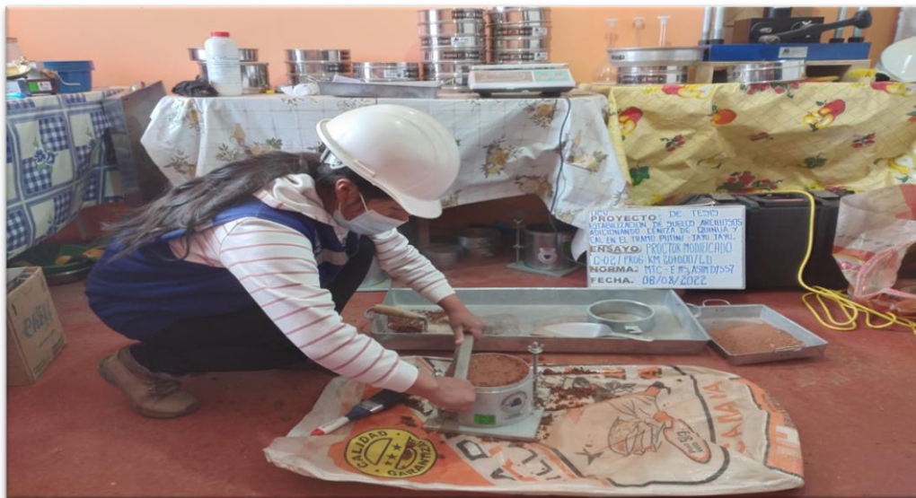
Fotografía 11: Regulación de la muestra en el molde con la regla metálica.
