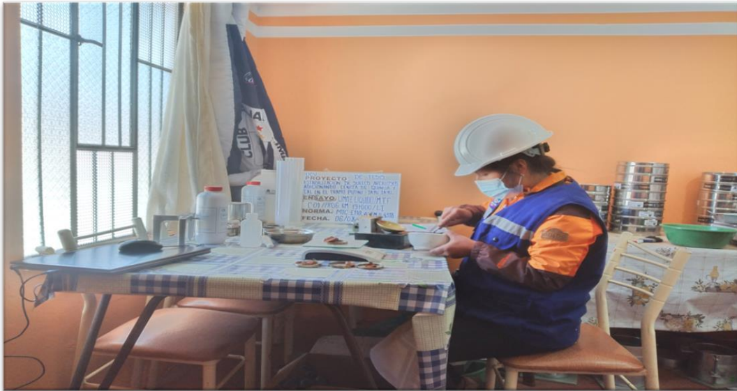
Fotografía 08: Ensayo de Límites de Consistencia (Límite Plástico).
