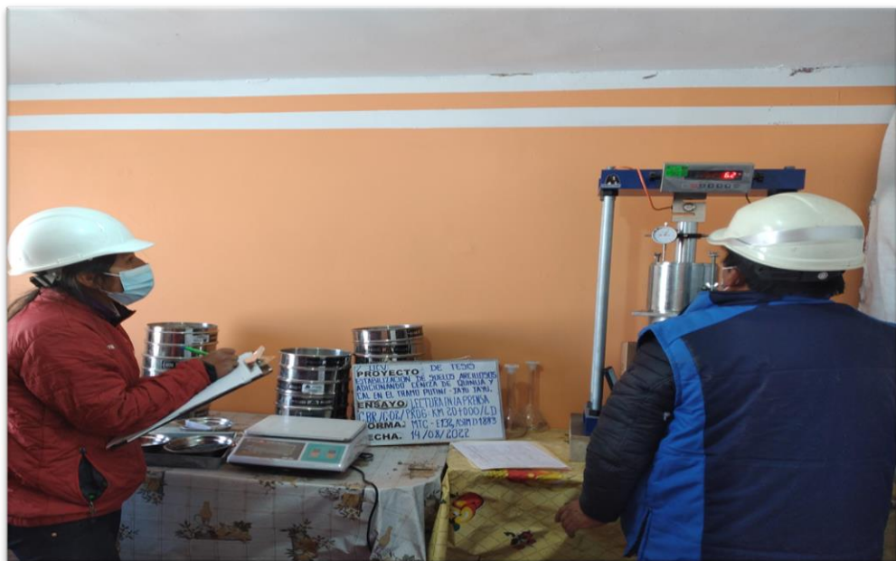
Fotografía 17: Lectura en la prensa (ensayo CBR).
