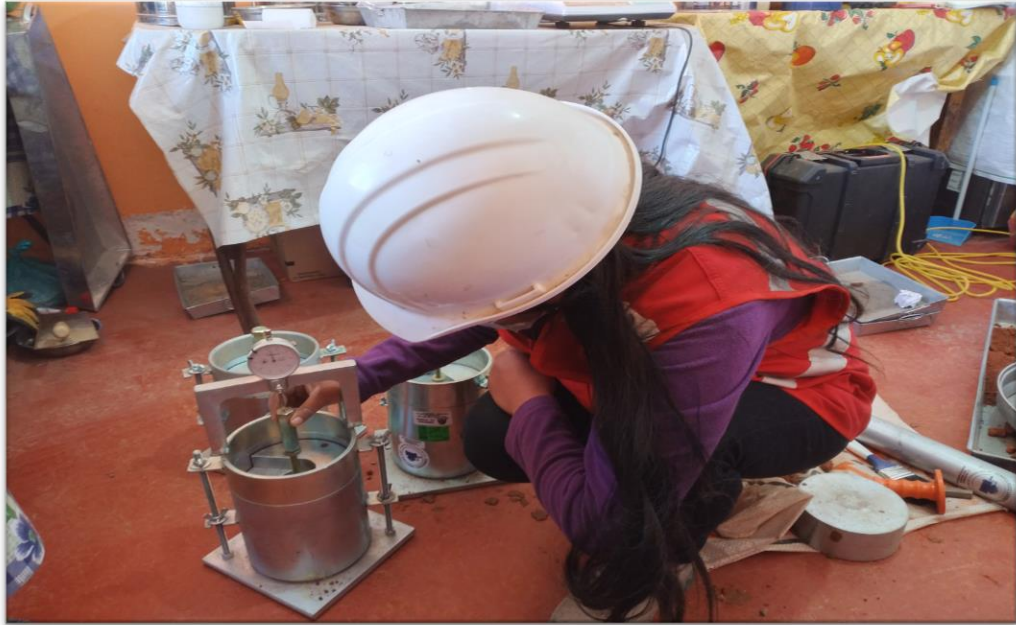
Fotografía 16: Lectura de la muestra antes de colocarlo en el agua (ensayo CBR).
