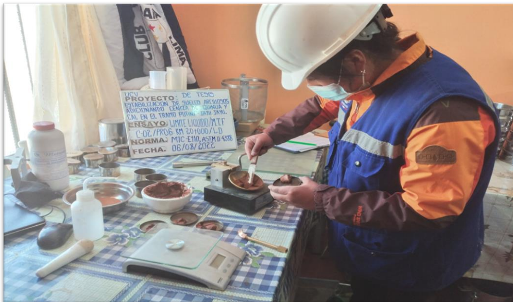
Fotografía 07: Ensayos de Limites de Consistencia (Limite Líquido).
