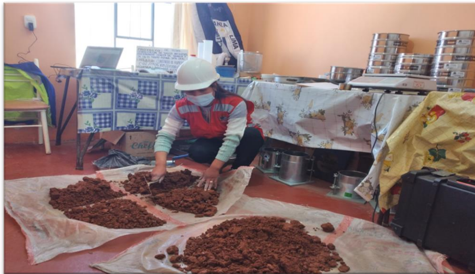
Fotografía 05: Cuarteo de la muestra para realizar ensayos.
