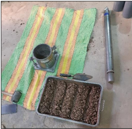
Descripción: cuarteo de la muestra en 5 partes iguales.
