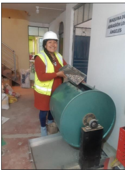
Descripción: ensayo de abrasión los ángeles.
