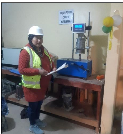
Descripción: ensayo de CBR
