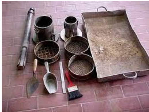
Figura 7 Ensayo de Proctor modificado
