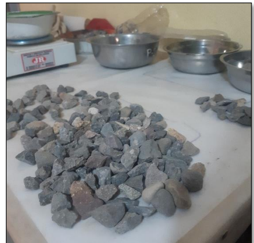
Descripción: determinamos las caras fracturas.
