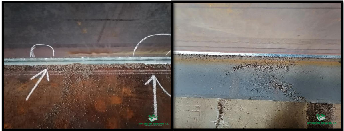
Figura 15. Cordón de soldadura antes / después
