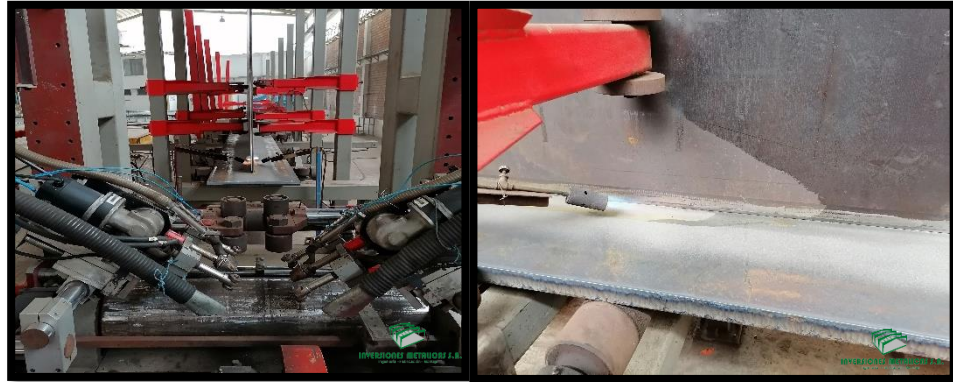
Figura 18. Verificación de mecheros en el proceso de soldeo
