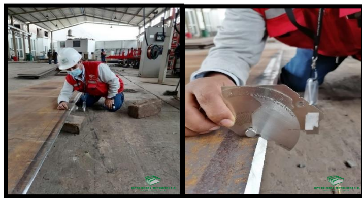
Figura 19. Medición del biselado de almas de vigas
