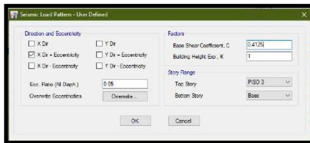
**Figura 36.** Valor de VeXX y “K” preliminares para la vivienda 001 en el software Etabs.
