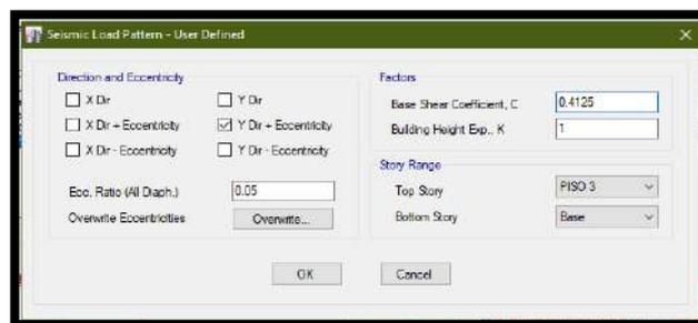
**Figura 37.** Valor de VeYY y “K” preliminares para la vivienda 001 en el software Etabs.
