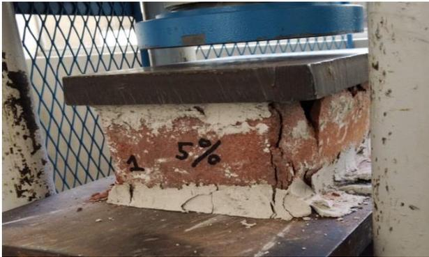
Rotura del ladrillo con 5 % de adición.
