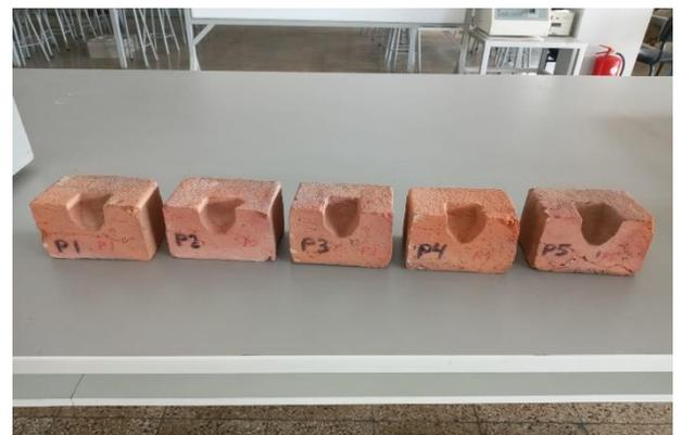
Ensayo de coeficiente de saturaci: Muestras secas al horno
