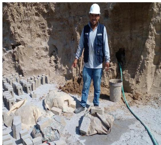
Reposo 24 horas de las masas para el ladrillo patrón y con adiciones de 5%, 10% y 15% de limadura de hierro.
