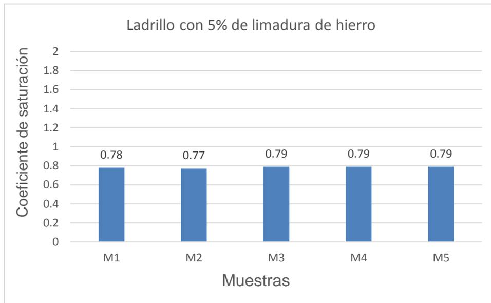
*Figura 20* : Gráfico de barras de los coeficientes de saturación del ladrillo con 5% de limadura de hierro
