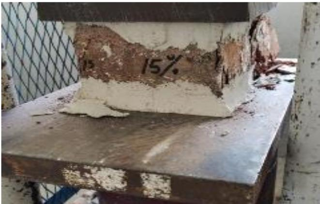
Rotura del ladrillo con 15 % de adición
