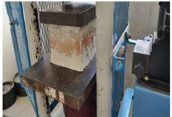
Colocación del ladrillo patron en la prensa
