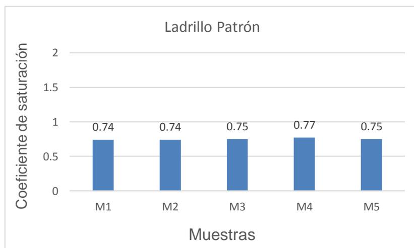
Figura 19: Gráfico de barras de los coeficientes de saturación del ladrillo patrón
