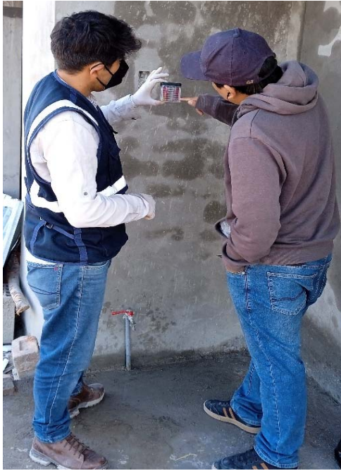
Figura 9. Medición del cloro residual en la primera vivienda. Fuente: Elaboración Propia
