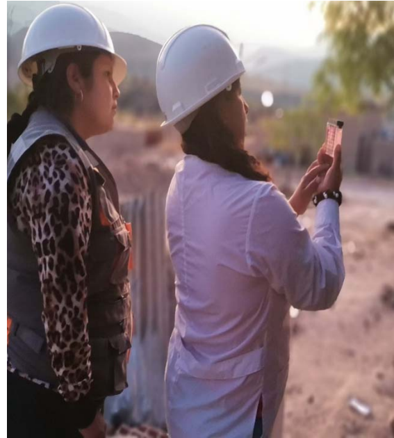
Figura 10. Medición del cloro residual en la última vivienda. Fuente: Elaboración Propia
