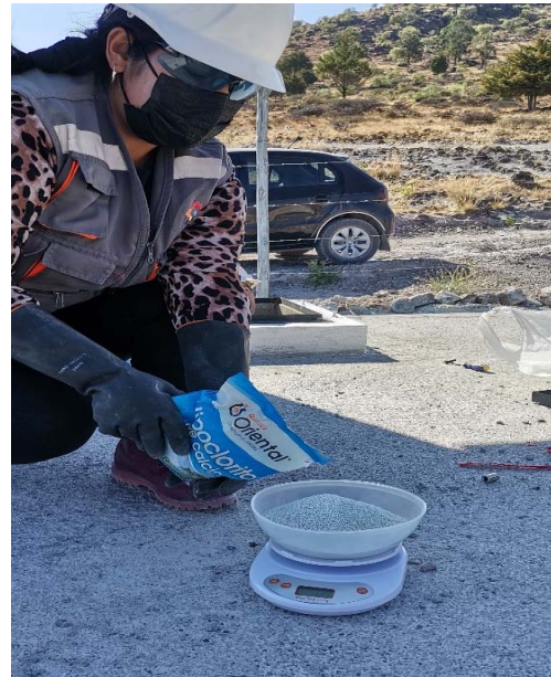
Figura 4. Pesando el Hipoclorito. Fuente: Elaboración Propia
