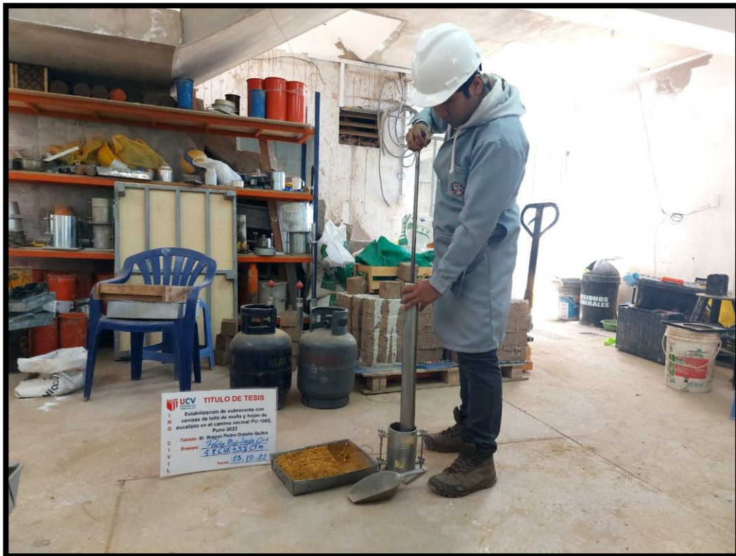
Fotografía 19. Ensayo de proctor modificado de C-1 con 7% de mezcla de cenizas.
