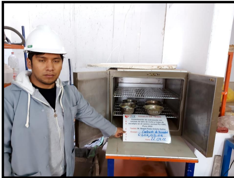
Figura 29. Muestras de calicatas: 1, 2, 3 y 4 extraídas después de secado en horno.
