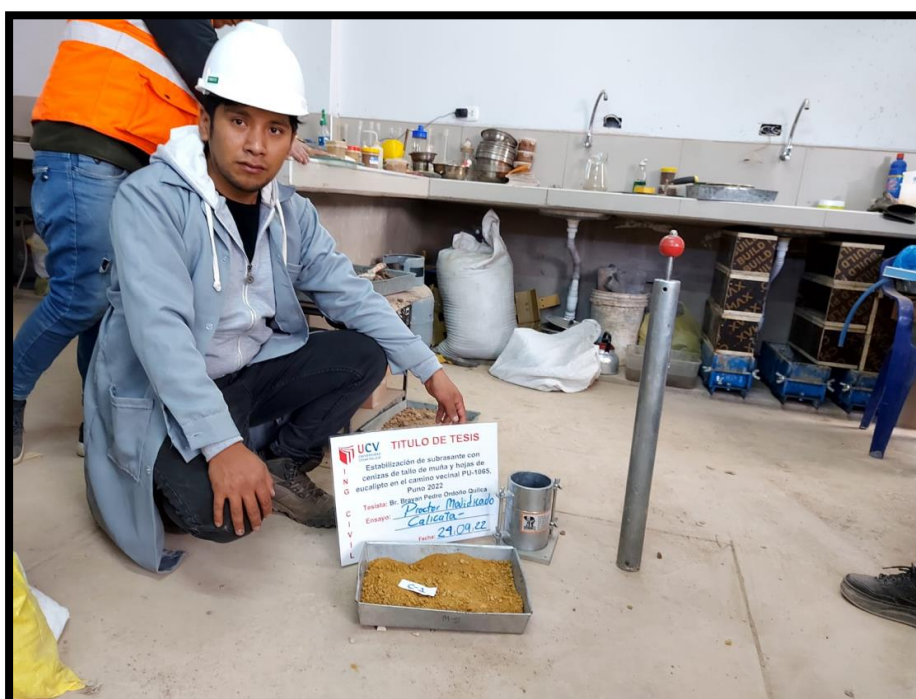
Figura 54. Elaboración del Ensayo Proctor Modificado C-1.
