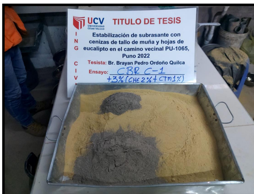
Figura 39. CBR de C-1 con adición de cenizas CHE y CTM
