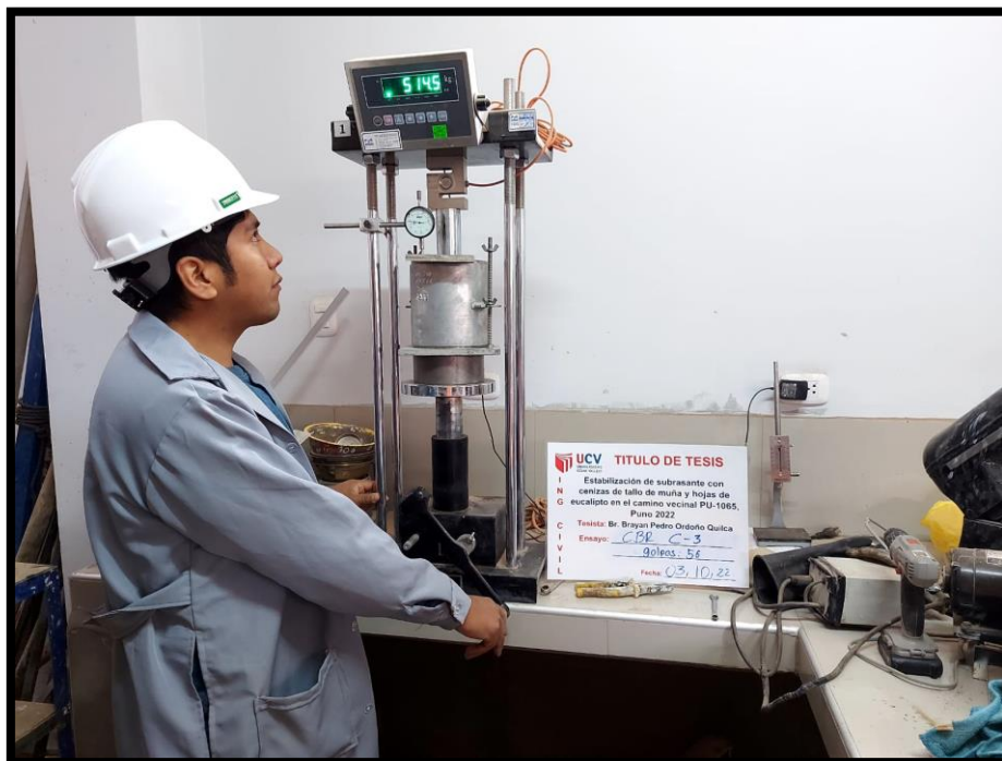
Figura 60. Elaboración del Ensayo de CBR C-3.
