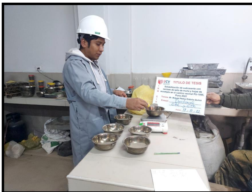
Figura 38. Dosificación de cenizas CHE y CTM para CBR de C-1.
