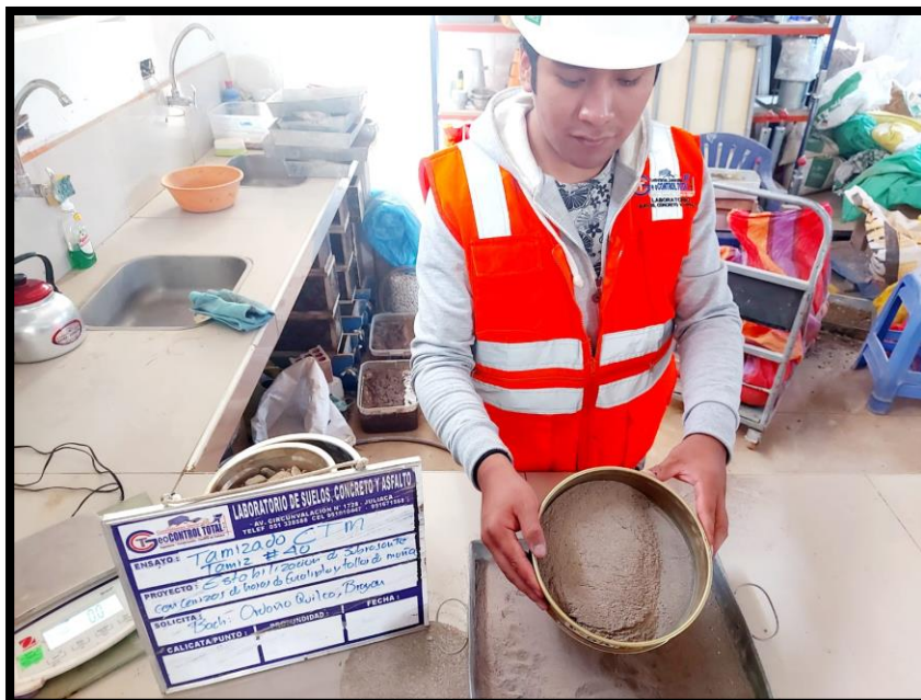
Figura 25. Tamizado de cenizas por tamiz # 40.
