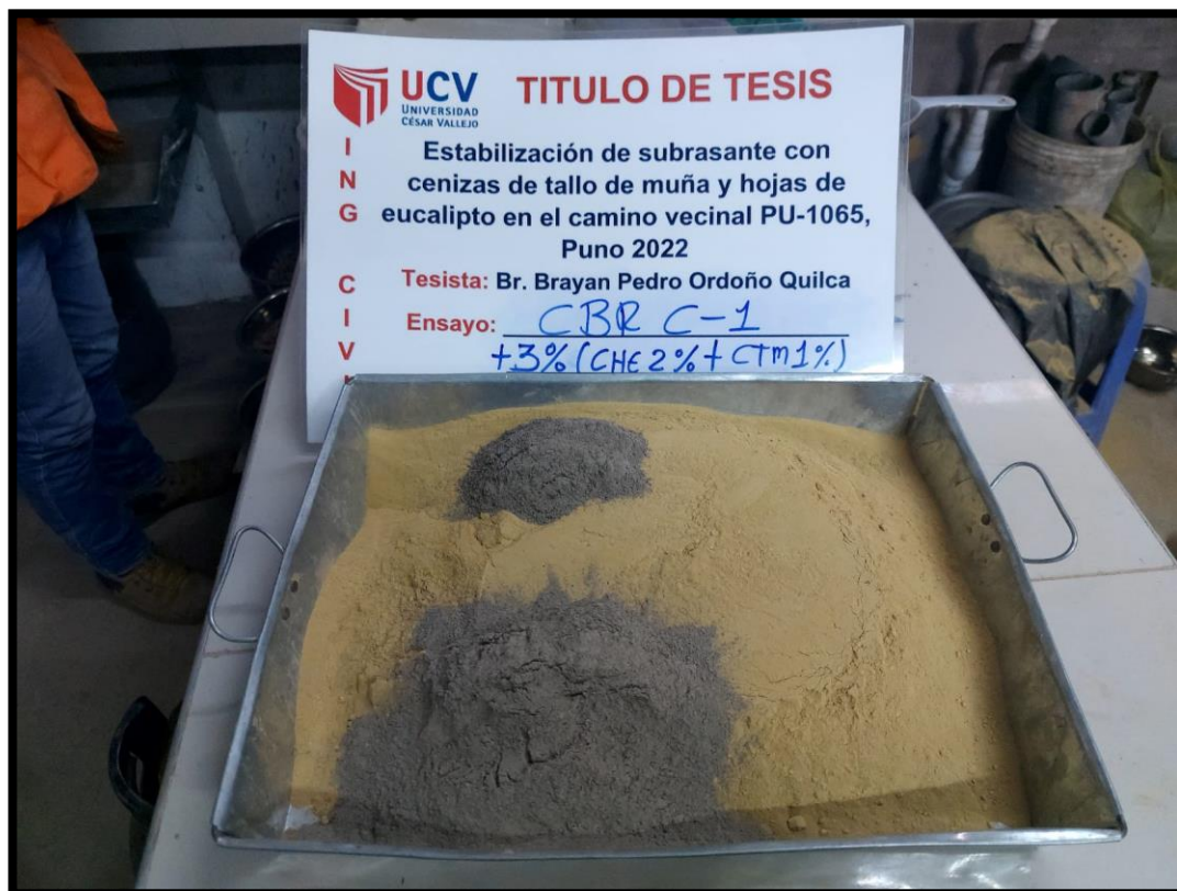
Fotografía 20. Preparación de muestra de suelo C-1 con adición de cenizas al 5% para CBR.
