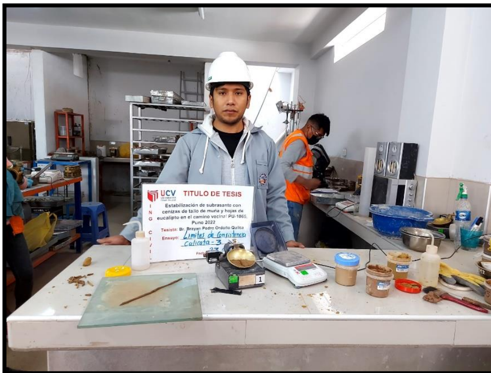
Figura 49. Ensayo de límites líquido y plástico de la C-3.
