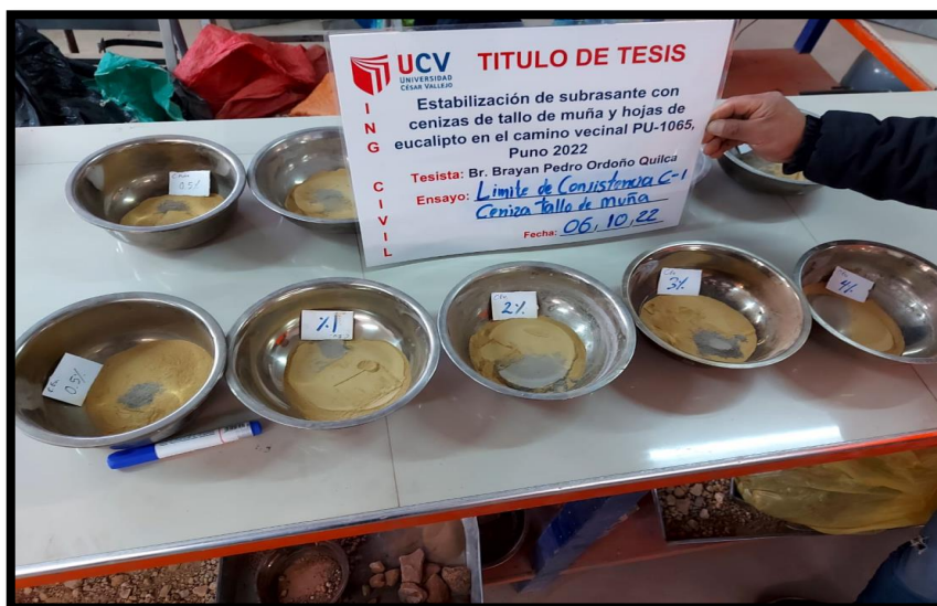
Figura 65. Límite de consistencia con adición de CHE + CTM en C-1.
