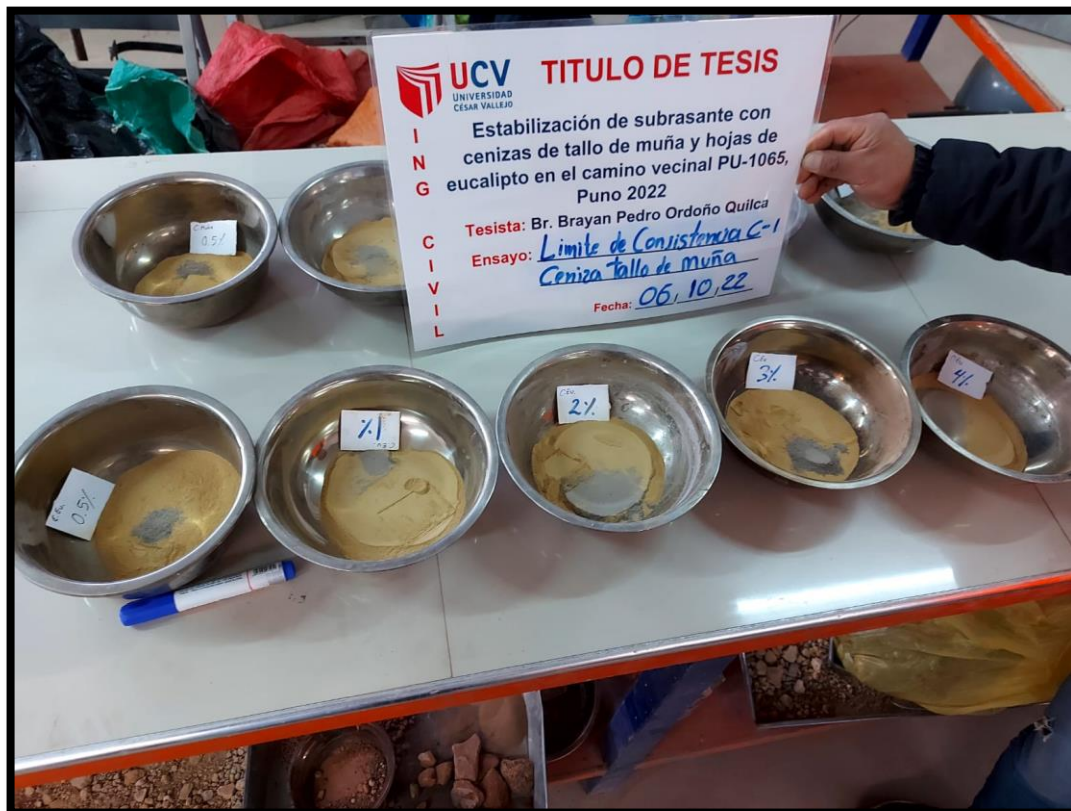
Fotografía 17. Adición de cenizas de hojas de eucalipto y cenizas de tallo de muña a C-1.
