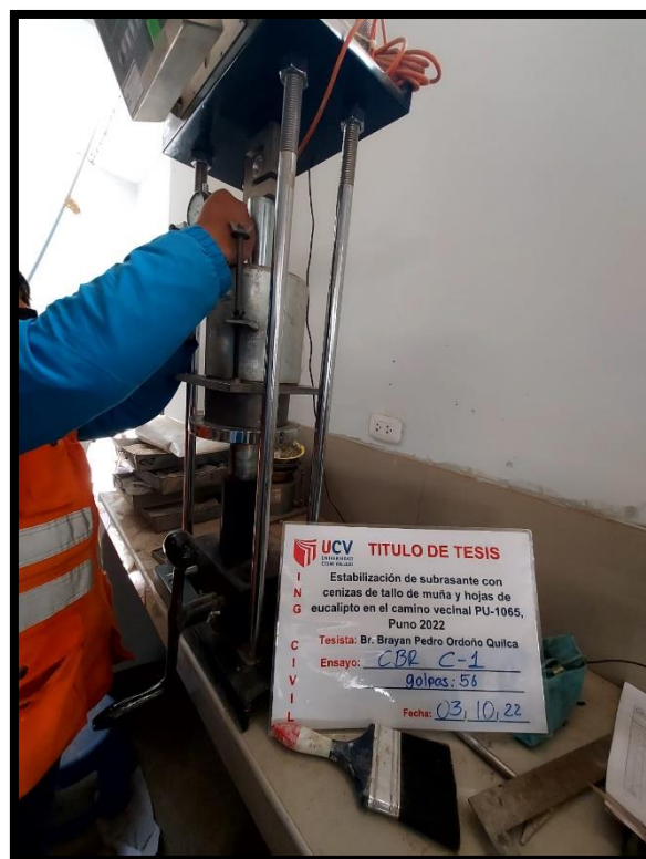
Fotografía 15. Ensayo de Proctor modificado de C-1.
