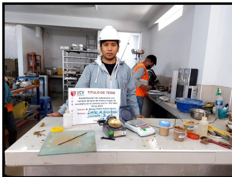
Figura 35. Ensayo de límites líquido y plástico de la C-3.
