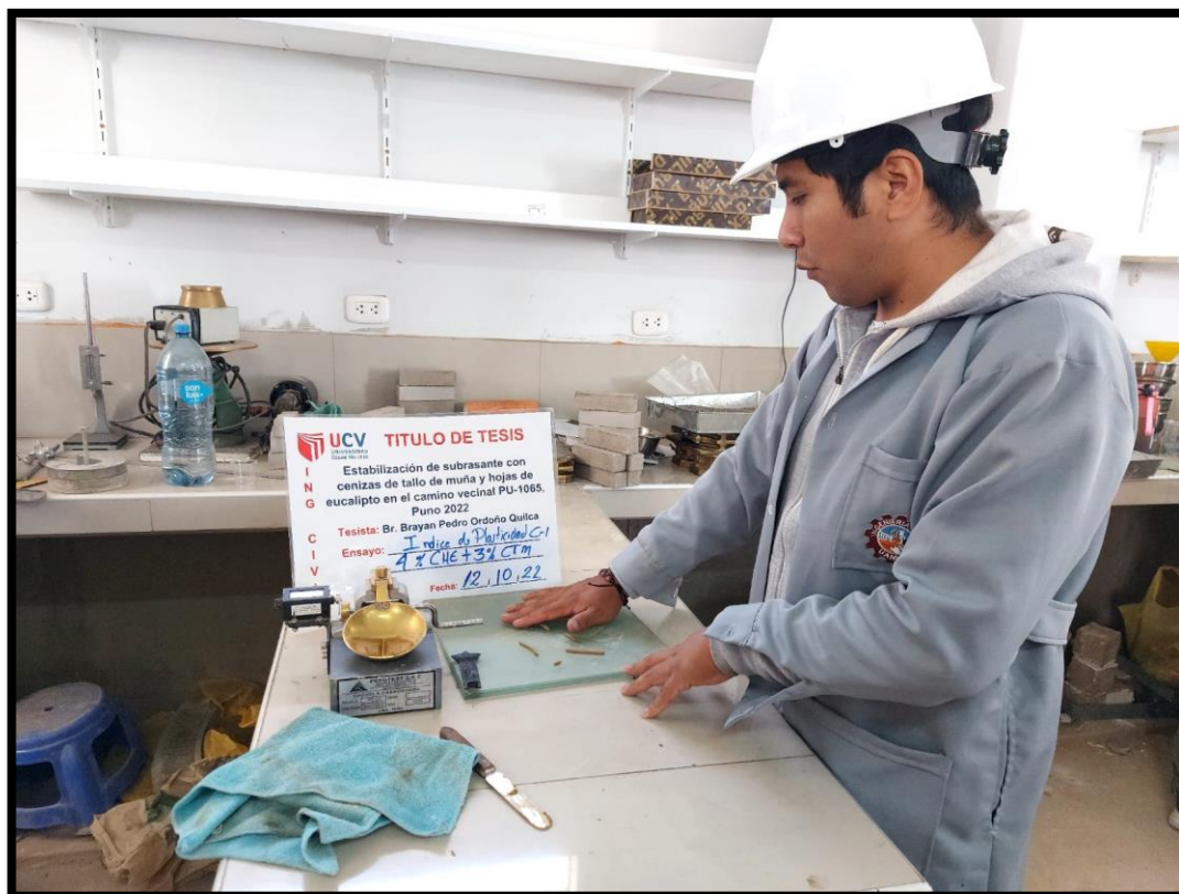
Fotografía 18. Ensayo de Índice de plasticidad de C-1 + 7% de mezcla de cenizas.
