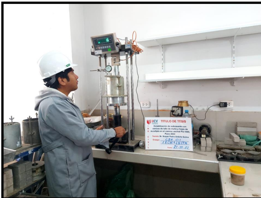
Figura 62. Elaboración del Ensayo de CBR con adición de cenizas en C-1.
