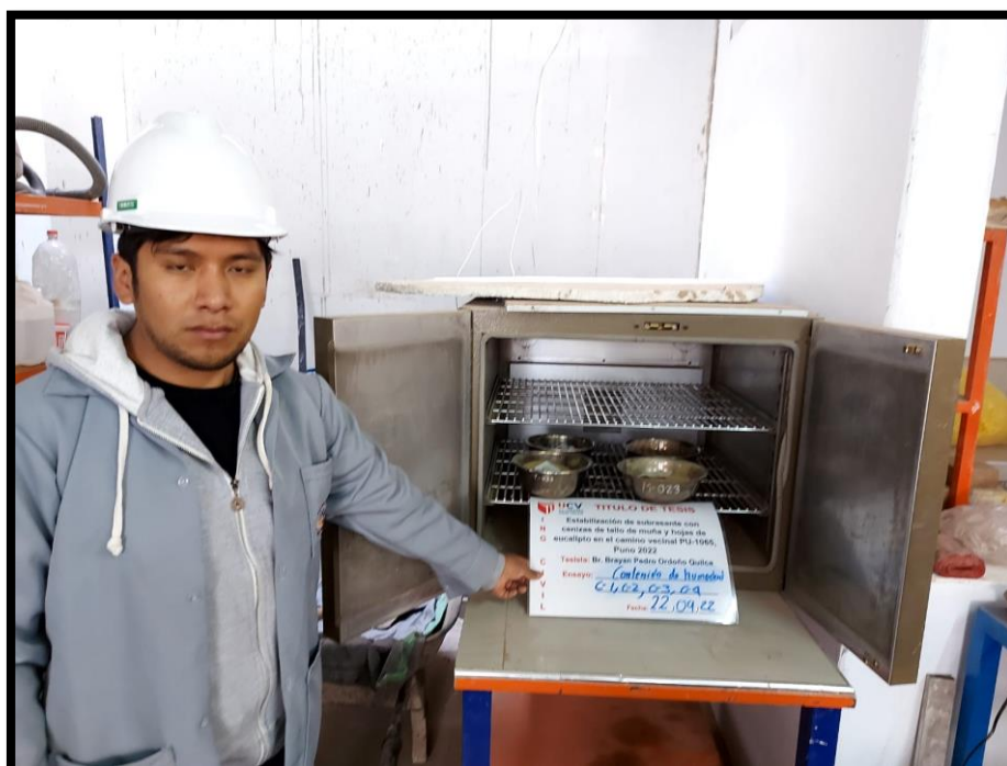
Figura 42. Muestras de calicatas: 1, 2, 3 y 4 extraídas después de secado en horno.
