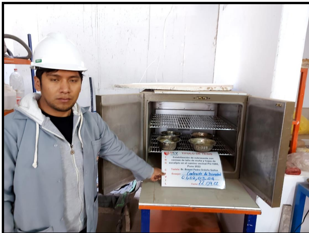
Fotografía 10. Ensayo de contenido de humedad las muestras patrones.
