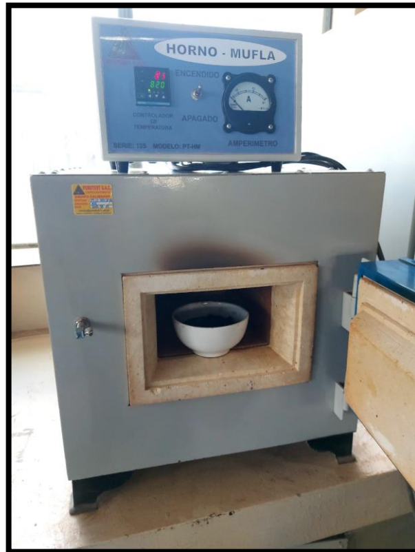
Figura 24. Mufla con muestra de ceniza procesada.
