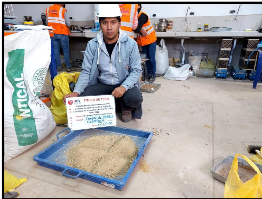
Figura 28. División en 4 partes iguales de muestra de calicata.
