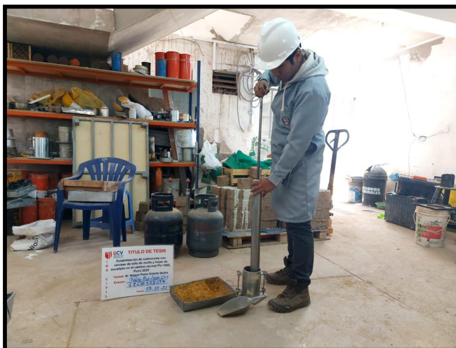
Figura 57. Elaboración del Ensayo Proctor Modificado con adición de cenizas en C-1
