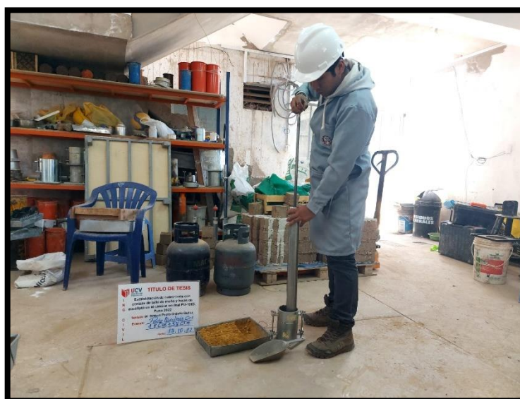
Figura 37. Proctor modificado de C-1 con adición de cenizas CHE y CTM.
