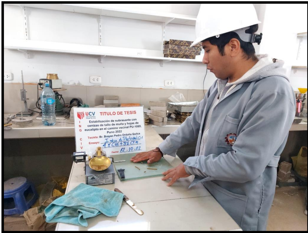
Figura 51. Ensayo de Índice de plasticidad de C-1 + 7% de mezcla de cenizas.
