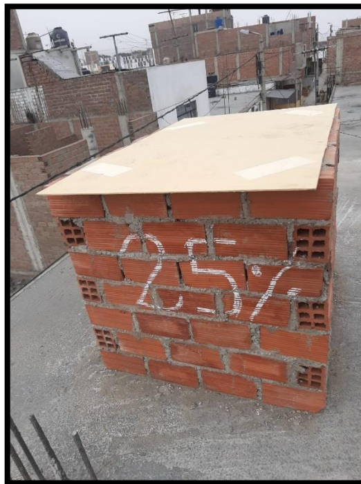
Figura 17. Prototipo con 25% de perlas de eps reciclado
