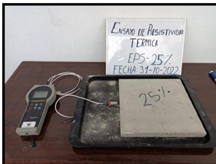
Figura 38. Ensayo de conductividad térmica de mortero con 25% de perlas de eps reciclado.
