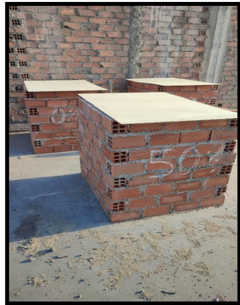
Prototipo con 50% de perlas de eps reciclado
