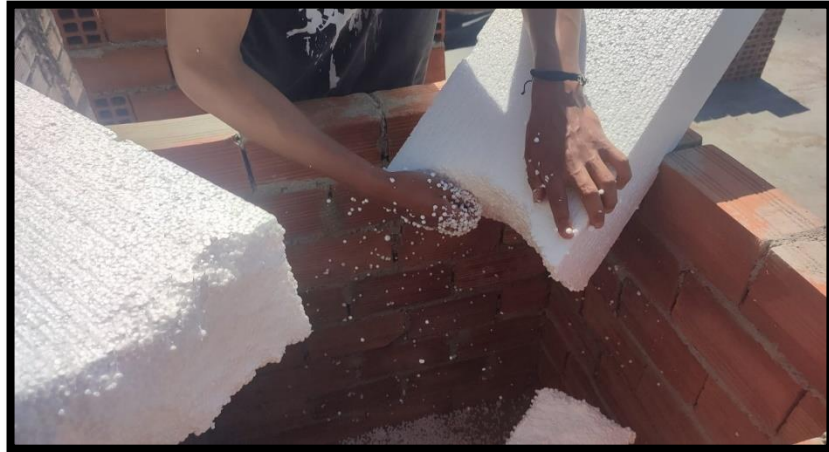
Figura 4. Obtención de perlas de poliestireno expandido reciclado.
