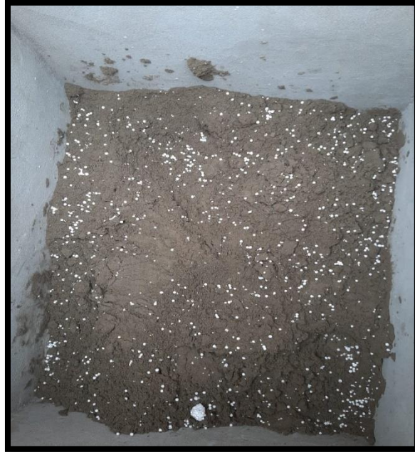
Figura 23. Mezcla de mortero con 10% de eps reciclado
