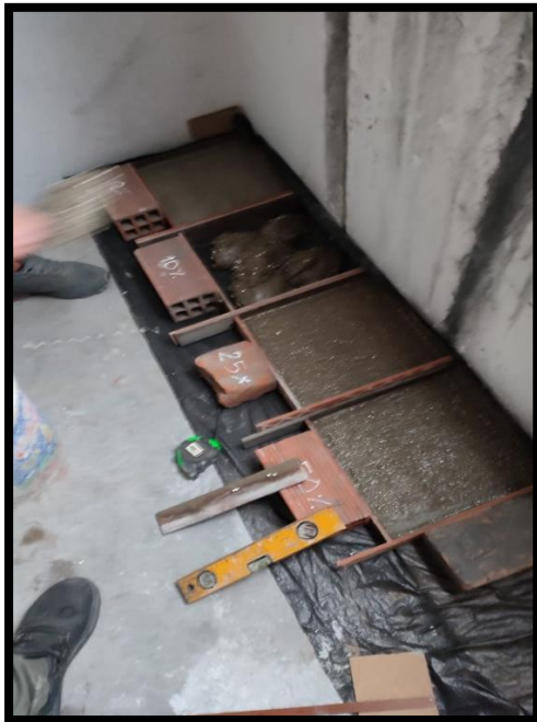
Muestras con mortero convencional y con porcentajes de eps reciclado para asentado de ladrillos
