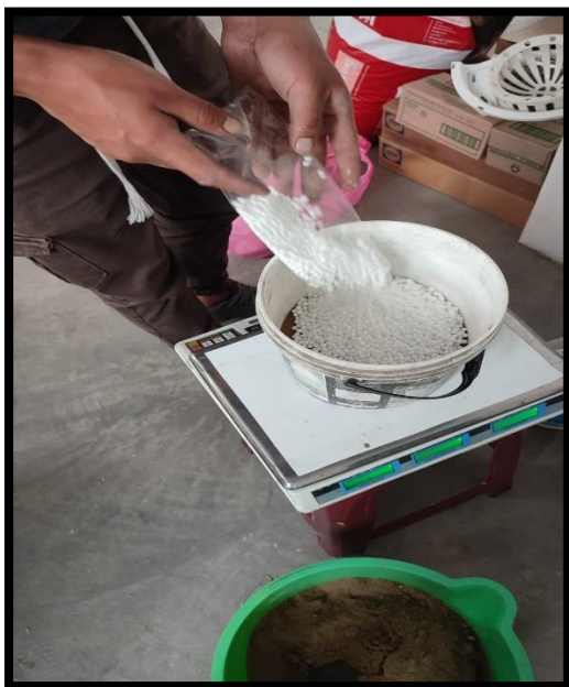
Preparación de mezcla con perlas de eps reciclado para la elaboración de muestras.
