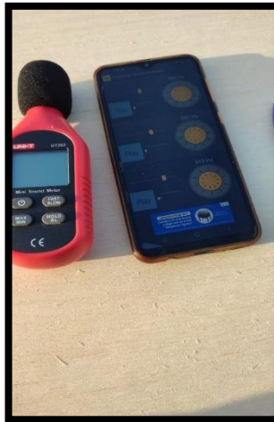
Figura 32. Software y sonómetro utilizados para los ensayos acústicos
