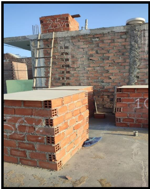
Prototipo con 25% de perlas de eps reciclado
