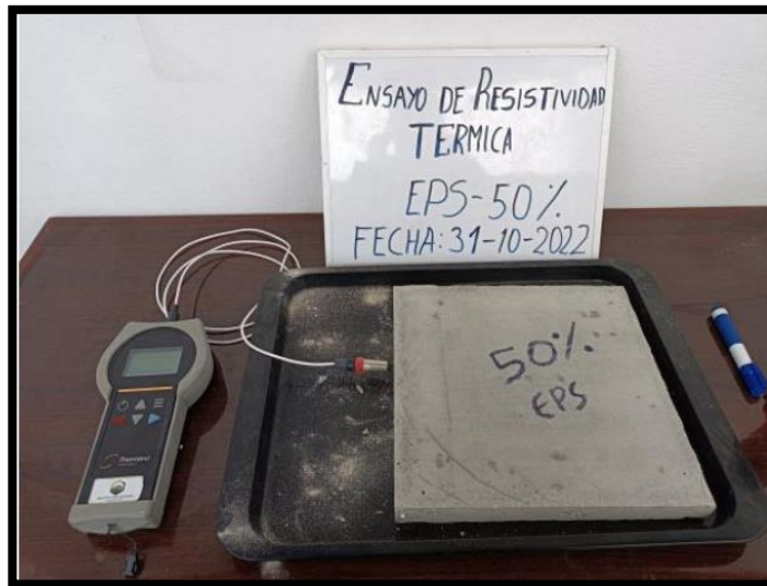
Figura 39. Ensayo de conductividad térmica de mortero con 50% de perlas de eps reciclado
