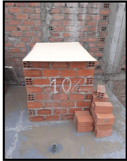
Prototipo con 10% de perlas de eps reciclado
