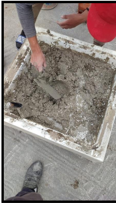
Figura 14. Diseño de mezcla de mortero de junta con 25% de perlas de eps reciclado
