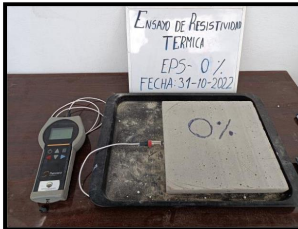
Figura 36. Ensayo de conductividad térmica de mortero convencional.
