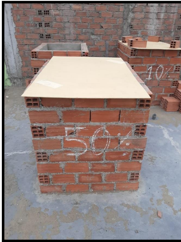
Figura 20. Prototipo con 50% de perlas de eps reciclado
