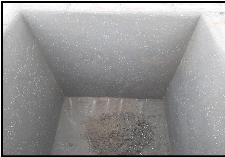
Tarrajeo interior del prototipo con 50% de perlas de eps reciclado
