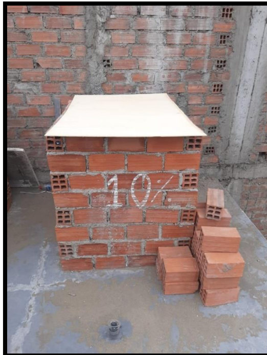
Figura 13. Prototipo con 10% de perlas de eps reciclado
