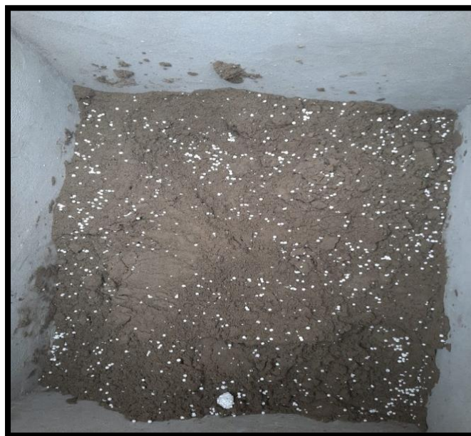
Figura 6. Mezcla de mortero con porcentajes de perlas de eps de junta para tarrajeo de muros.
