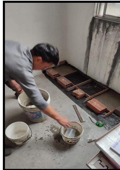
Muestras con mortero convencional y con porcentajes de eps reciclado para tarrajeo de muros
