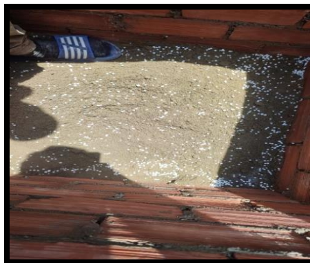
Figura 11. Mezcla de mortero con 10% de perlas de eps reciclado
