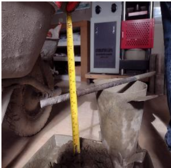
Figura 28. Prueba de slump
