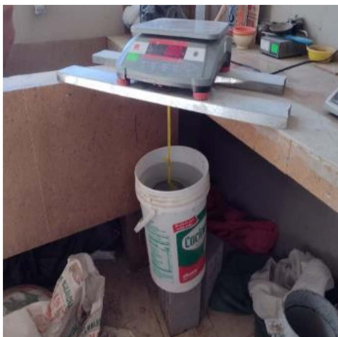
Figura 26. Determinación del peso de la muestra sumergida en agua
