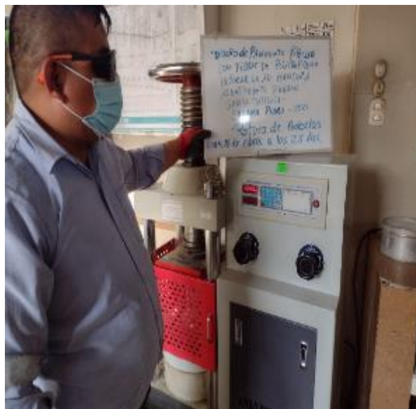
Figura 42. Rotura de probetas con 4% de fibra de polipropileno a los 28 días
