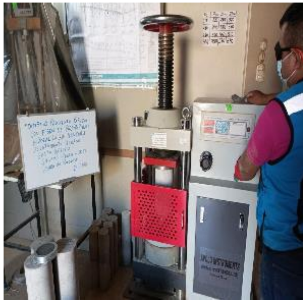
Figura 39. Rotura de probetas a los 14 días
