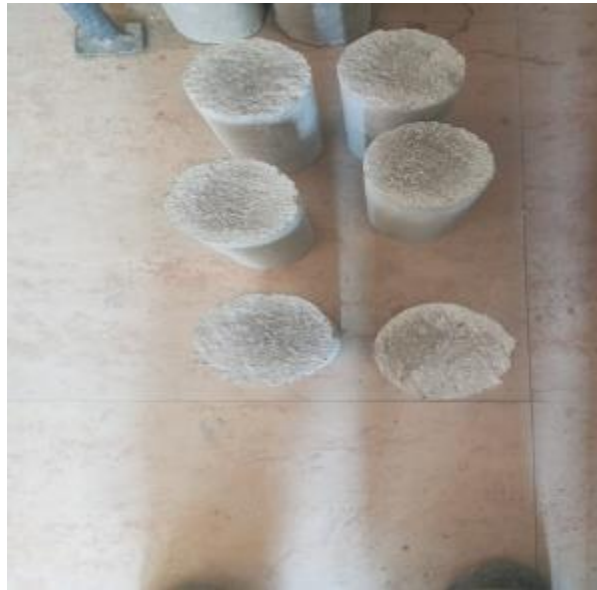
Figura 36. Se retira las probetas de molde para llevarlas al curado
