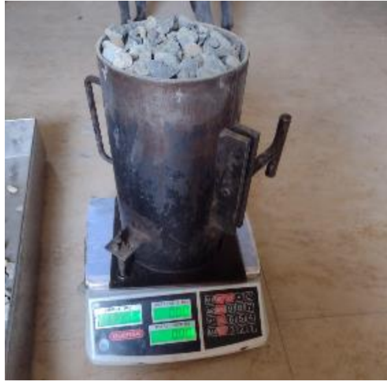
Figura 21. Peso compactado de la grava
