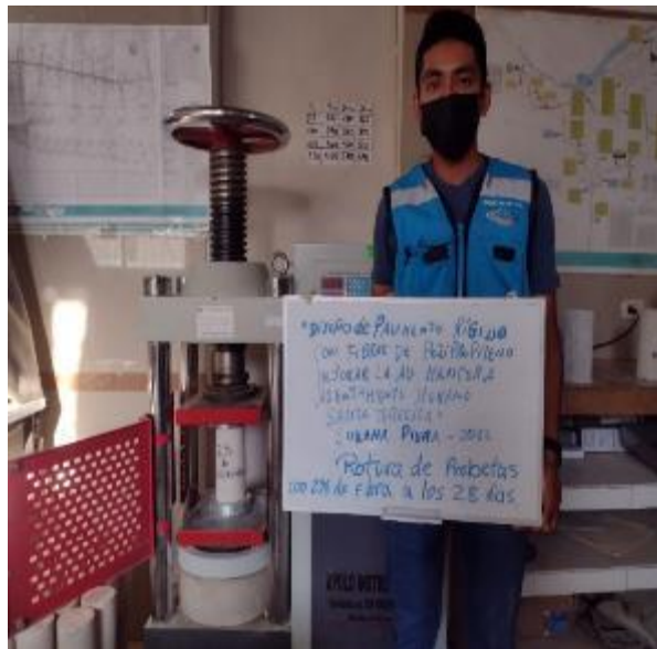
Figura 41. Rotura de probetas con 2% de fibra de polipropileno a los 28 días
