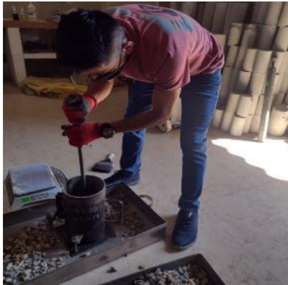
Figura 19. Compactación de la grava
