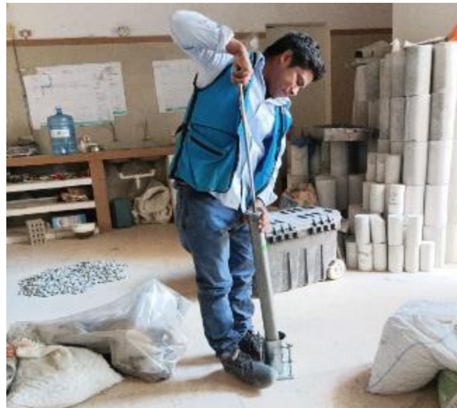
Figura 15. Ensayo de proctor
