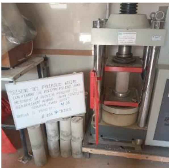
Figura 38. Rotura de probetas a los 7 días
