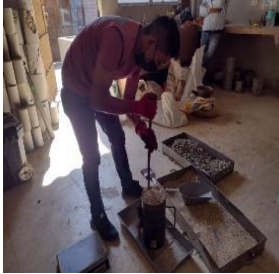
Figura 23. Compactación de la arena
