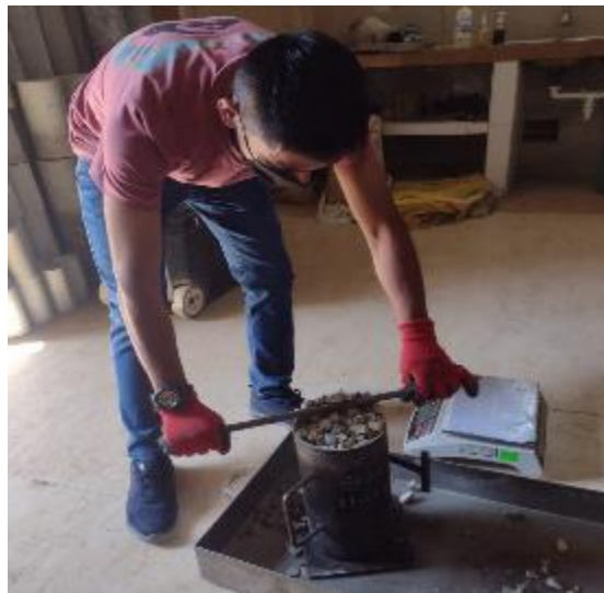
Figura 20. Compactación de la grava
