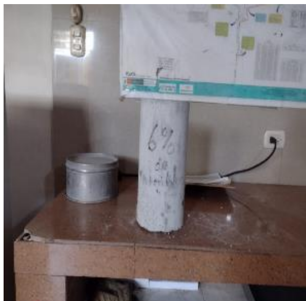
Figura 48. Probeta después del ensayo de resistencia a la compresión
