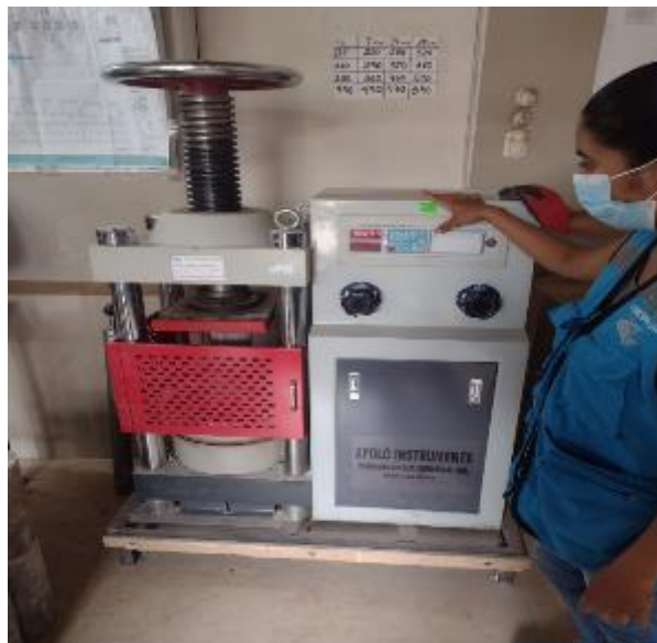
Figura 45. Verificación de la carga sometida
