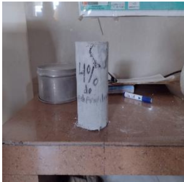
Figura 47. Probeta después del ensayo de resistencia a la compresión
