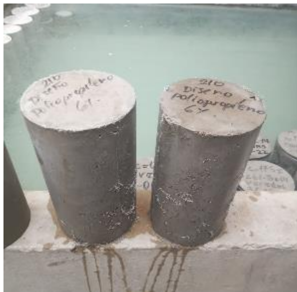
Figura 35. Se retira las probetas de la poza de agua
