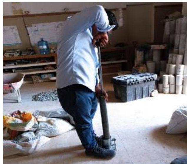
Figura 16. Ensayo de proctor
