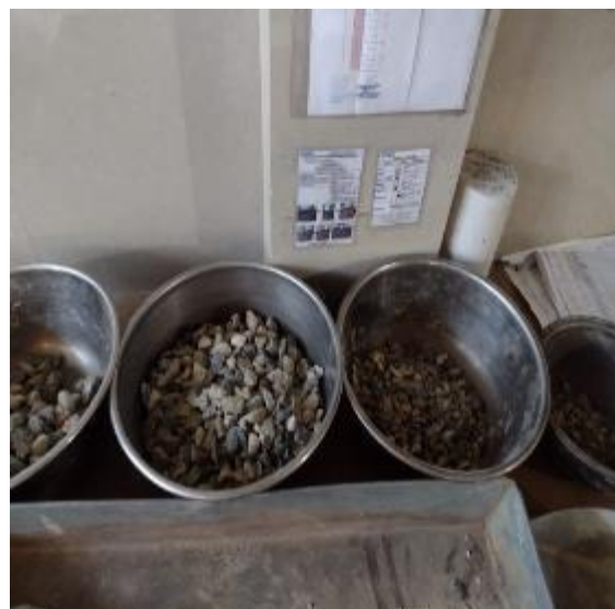
Figura 18. Separación de piedra chancada luego de ser tamizada
