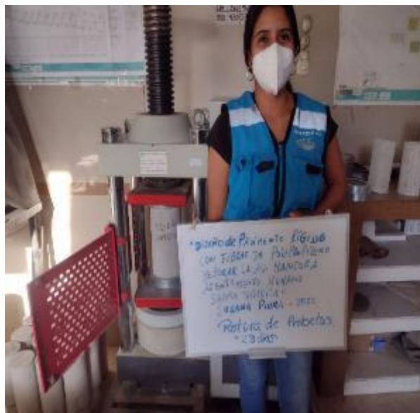
Figura 40. Rotura de probetas a los 28 días
