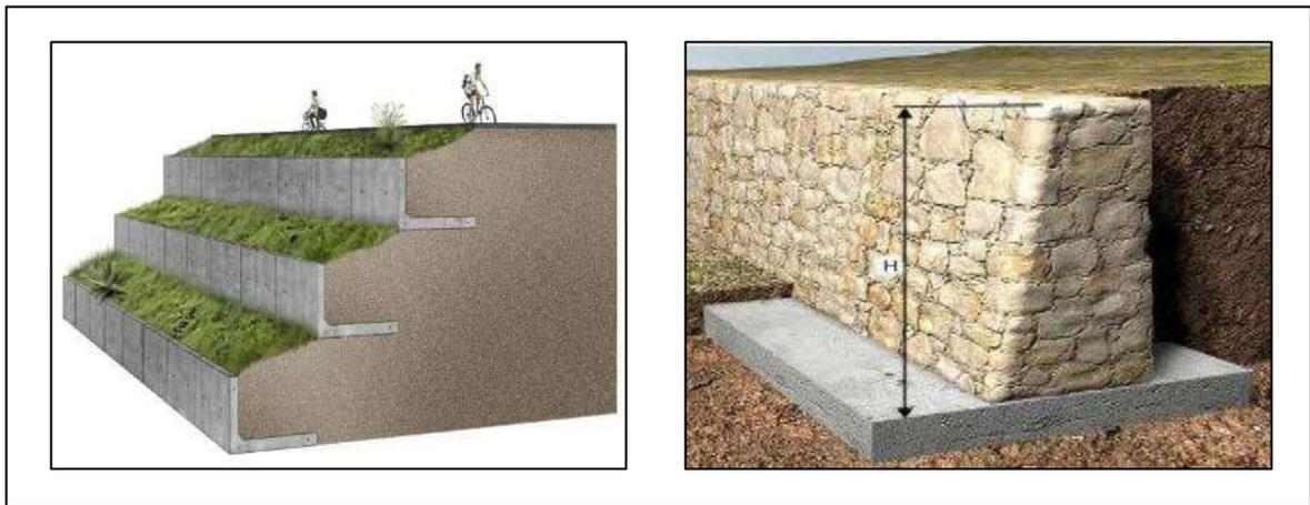
*Nota:* la imagen muestra el esquema de reforzamiento en muros de contención *Fuente:* tomada de (docplayer 2022)
