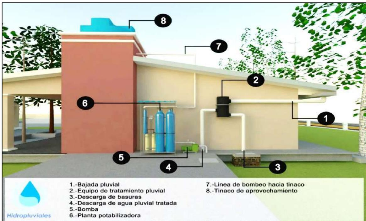
Nota: la imagen nos muestra el esquema de funcionamiento del sistema de captación de agua pluvial
