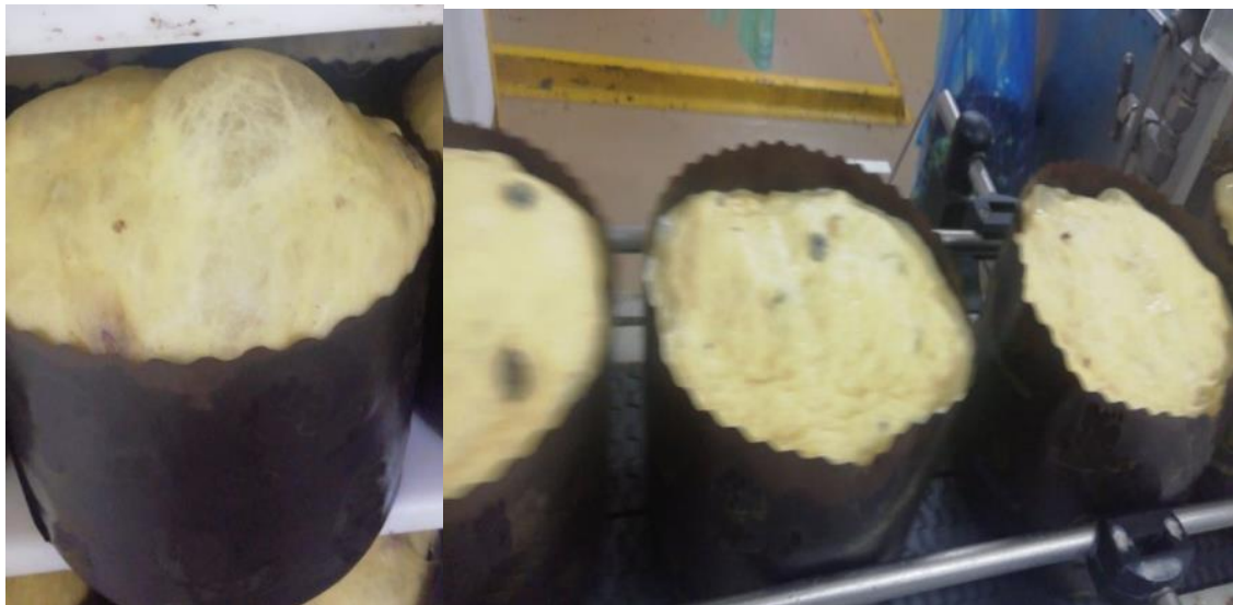
Figura 69. Antes de la implementación de la mejora, masas con burbujas en la superficie y masas flácidas
