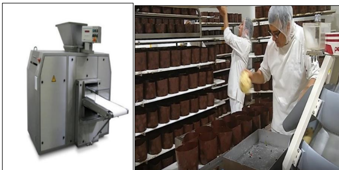
Figura 16. Cortadora-pesadora automática y cono boleador de masas en alta velocidad.
