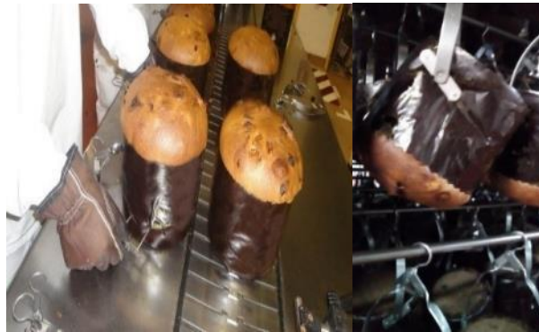
Figura 52. Defecto de panetón mal enganchado en la base.
