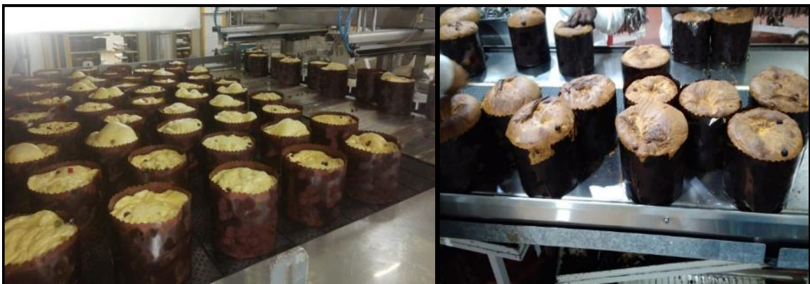
Figura 9. Masas defectuosas en ingreso del Horno y panetones defectuosos por bajo de altura. Fuente: La empresa NP. S.A.
