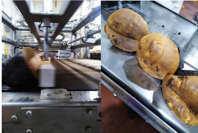
Figura 56. Panetones se aplastan en el alineador de salida del horno.
