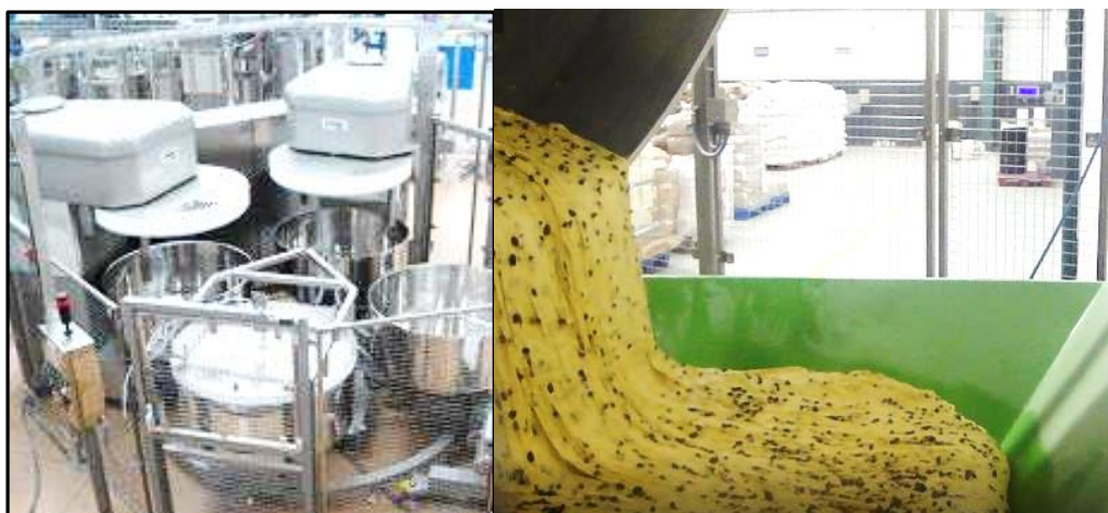
Figura 15. Máquina mezcladora industrial San Casiano, para altas producciones de masas.
