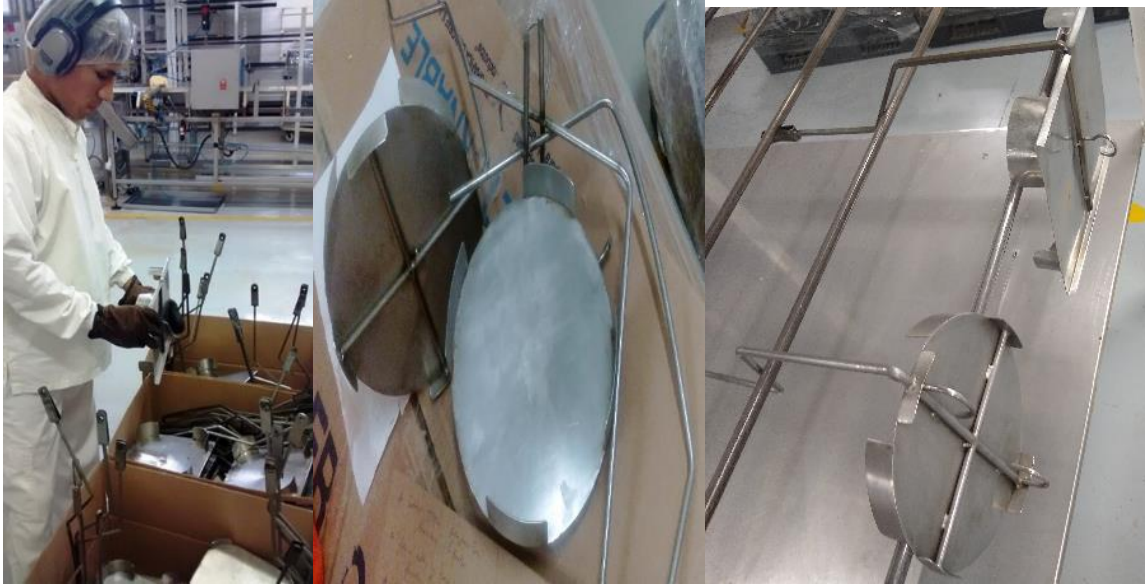
Figura 76. Selección de platillos con colgadores en mal estado el antes y después de la reparación de platillos con colgadores
