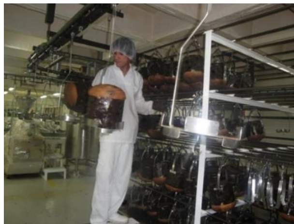
Figura 53. Panetones se caen al colocar a los platillos de la transportadora que va hacia empaque.
