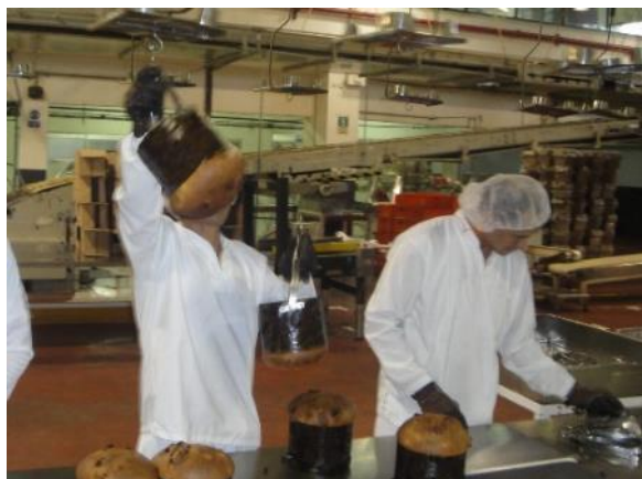
Figura 55. El panetón caliente se cae al colgar a los platillos de la cadena transportadora
