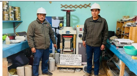
Figura 5. Rotura patrón curado 7 días.
