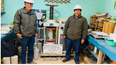
Figura 5. Rotura adición 2% curado 7 días.
