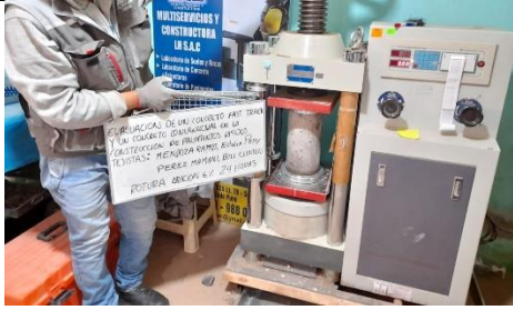
Figura 5. Rotura adición 6% curado 24 horas.
