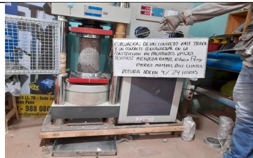
Figura 5. Rotura adición 4% curado 24 horas.
