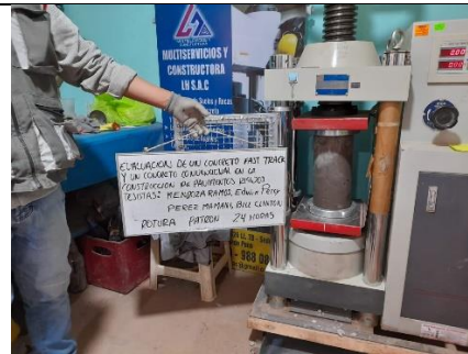
Figura 5. Rotura diseño patrón 24 horas.
