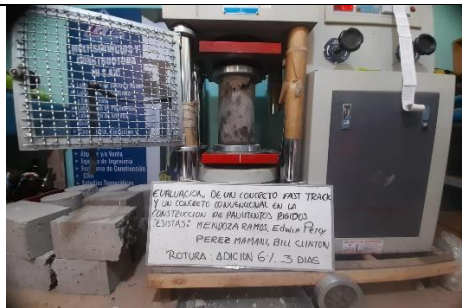
Figura 5. Rotura adición 6% curado 3 días.
