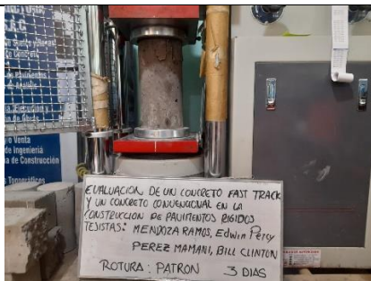
Figura 5. Rotura diseño patrón curado 3 días.
