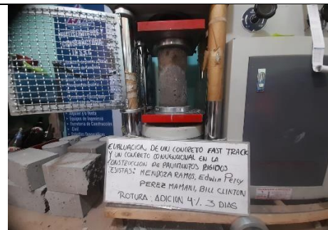
Figura 5. Rotura adición 4% curado 3 días.
