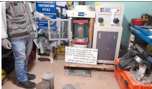
Figura 5. Rotura adición 2% curado 24 horas.
