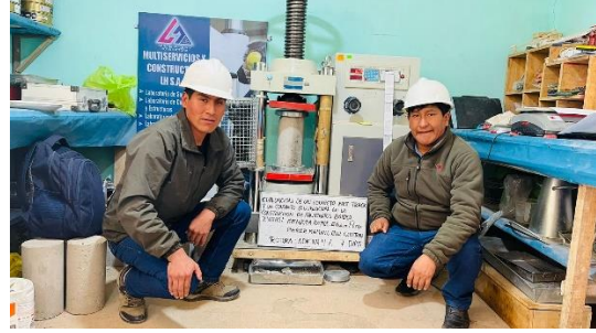
Figura 5. Rotura adición 4% curado 7 días.
