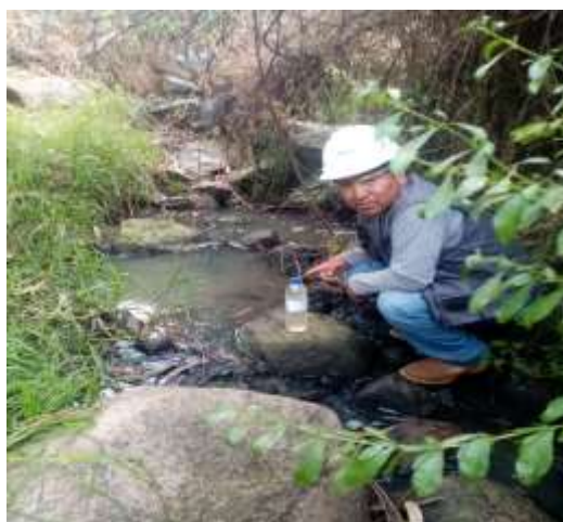
Figura 38. Extracción de muestra 2 de agua residual filtrada de captación.
