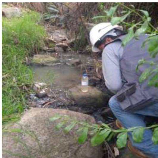
Figura 37. Extracción de muestra 1 de agua residual filtrada de captación.
