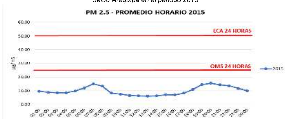
Figura 8. Variabilidad de concentración promedio horario de PM 2.5 en la estación fija Av. De la Salud Arequipa en el periodo 2015
