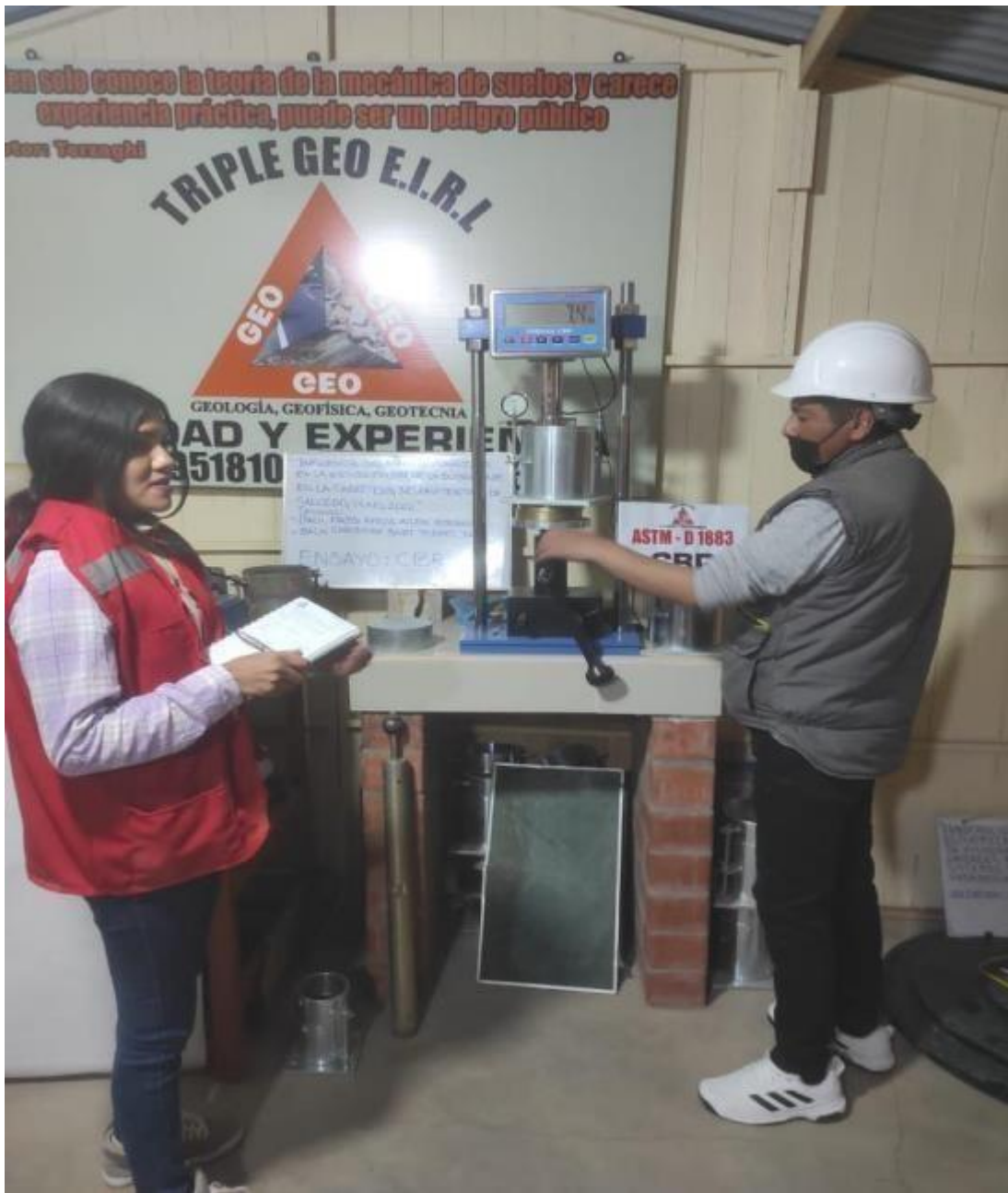
FOTO 9: Ensayo CBR para determinar la capacidad portante del suelo.
