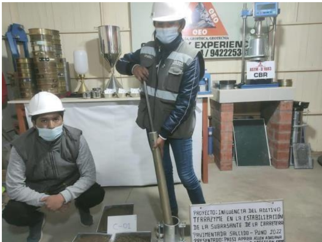
FOTO 8: Ensayo Proctor Modificado para determinar la compactación del suelo.
