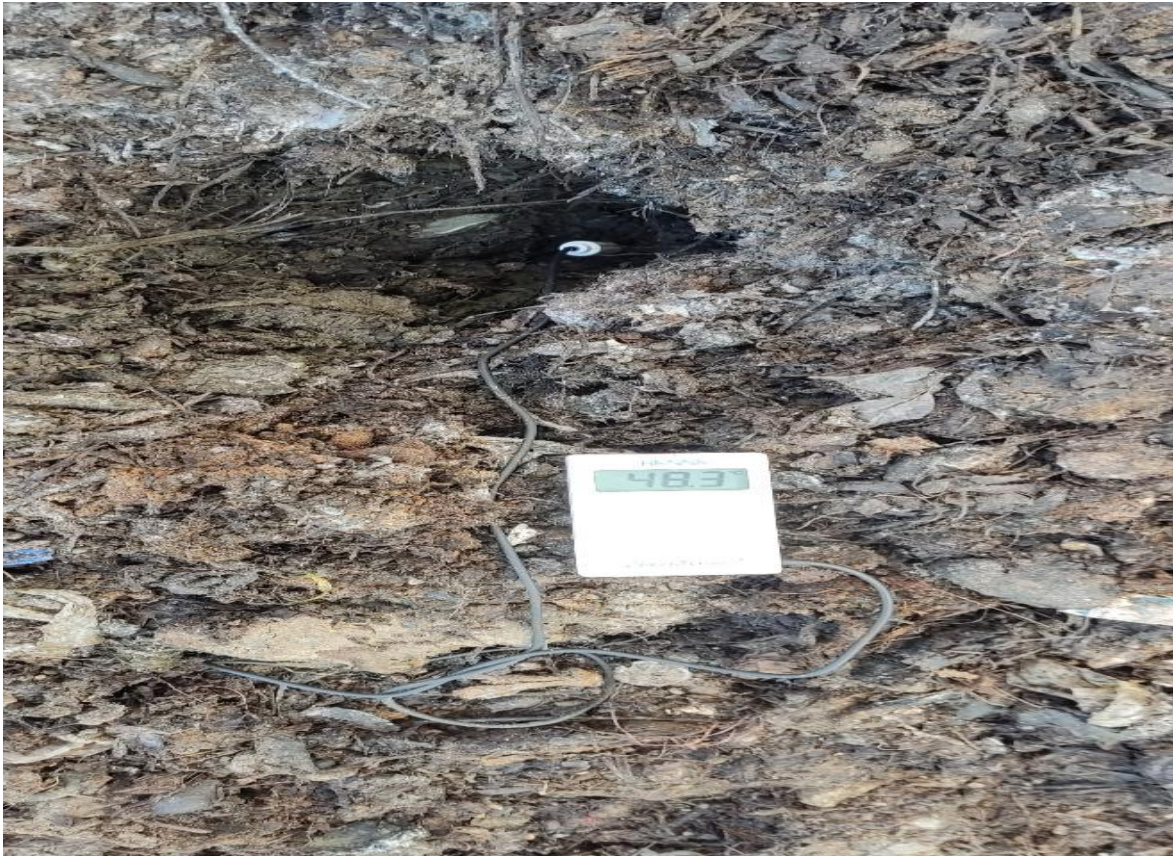
Figura 9: Medición de la temperatura de las pilas.
